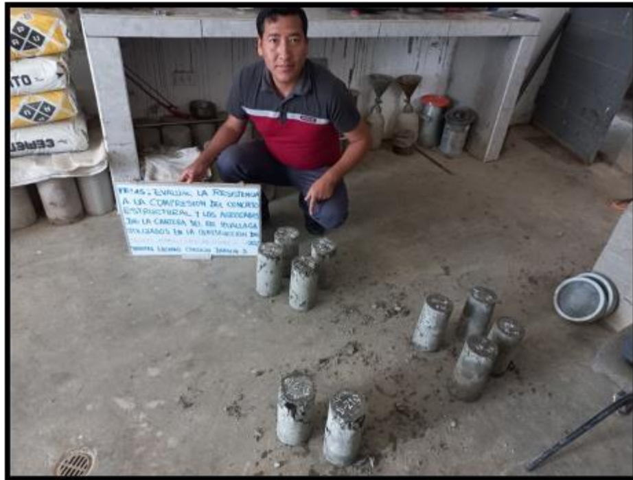
SE OBSERVA LAS PROBETAS EN EL ENSAYO DE ROTURA A LA COMPRESION A LOS 14 DIAS
