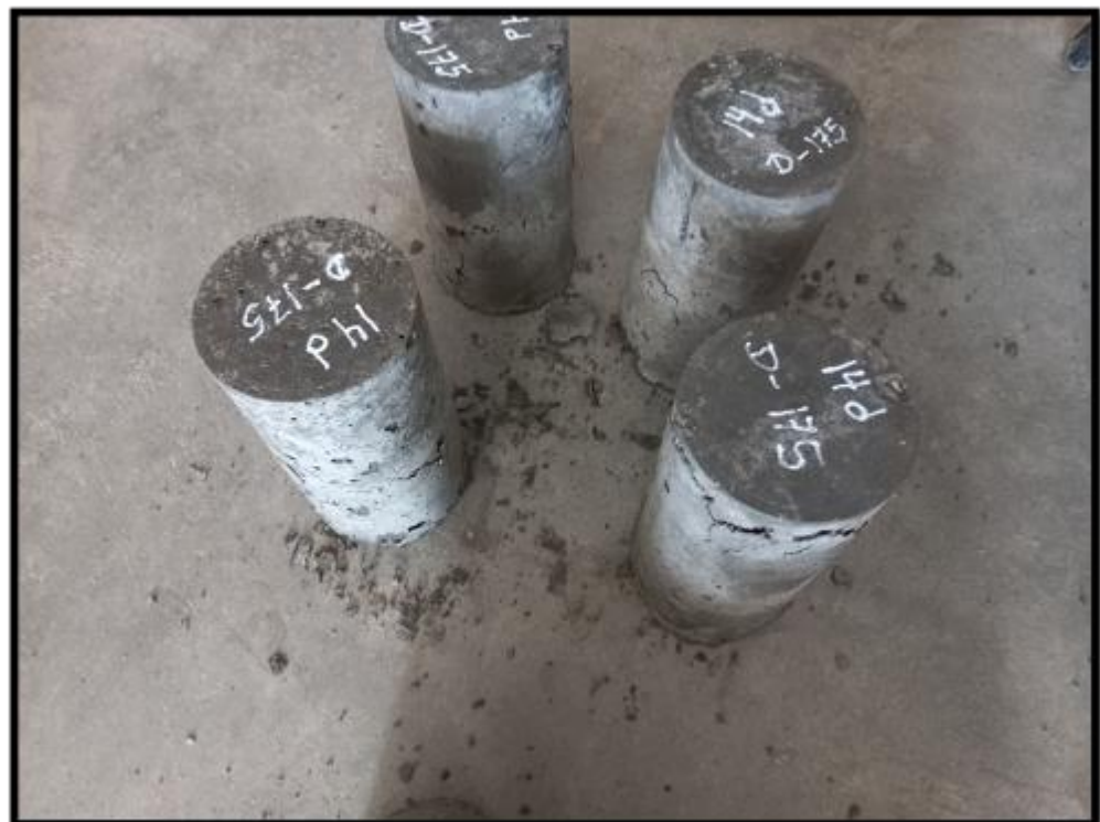
SE OBSERVA LAS PROBETAS EN EL ENSAYO DE ROTURA A LA COMPRESION FC=175 KG/CM2 (14 DIAS)
