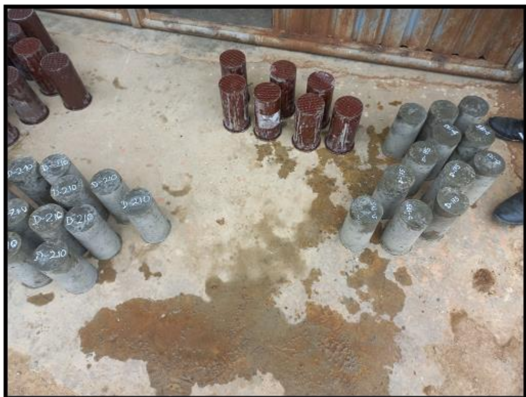
SE OBSERVA LAS PROBETAS CON LAS MEZCLAS RESPECTIVAS Y CON CADA UNO DE LOS TIPOS DE RESISTENCIAS SEGÚN DISEÑO DE MEZCLAS
