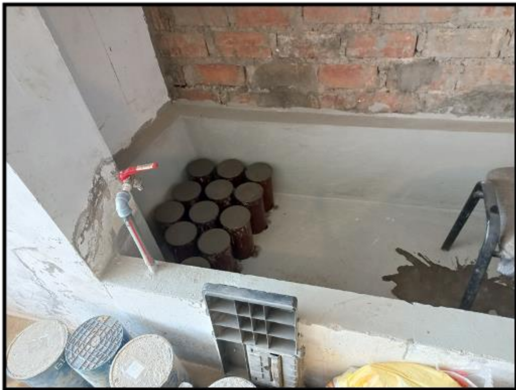
SE OBSERVA LAS PROBETAS CON LAS MEZCLAS RESPECTIVAS
