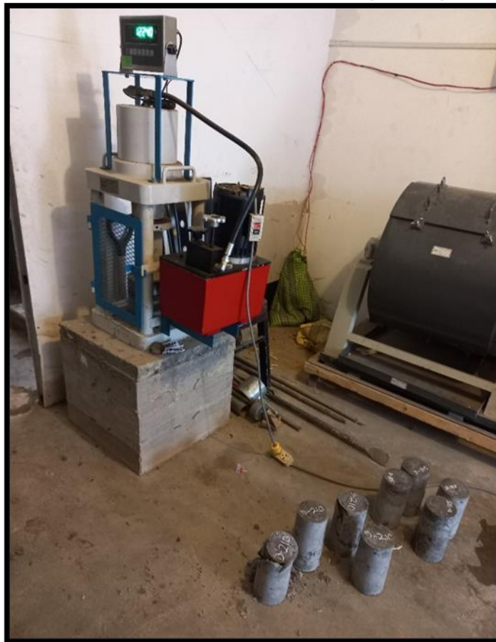
SE OBSERVA LAS PROBETAS EN EL ENSAYO DE ROTURA A LA COMPRESION FC=210 \text{ KG/CM}^2 (7 DIAS)
