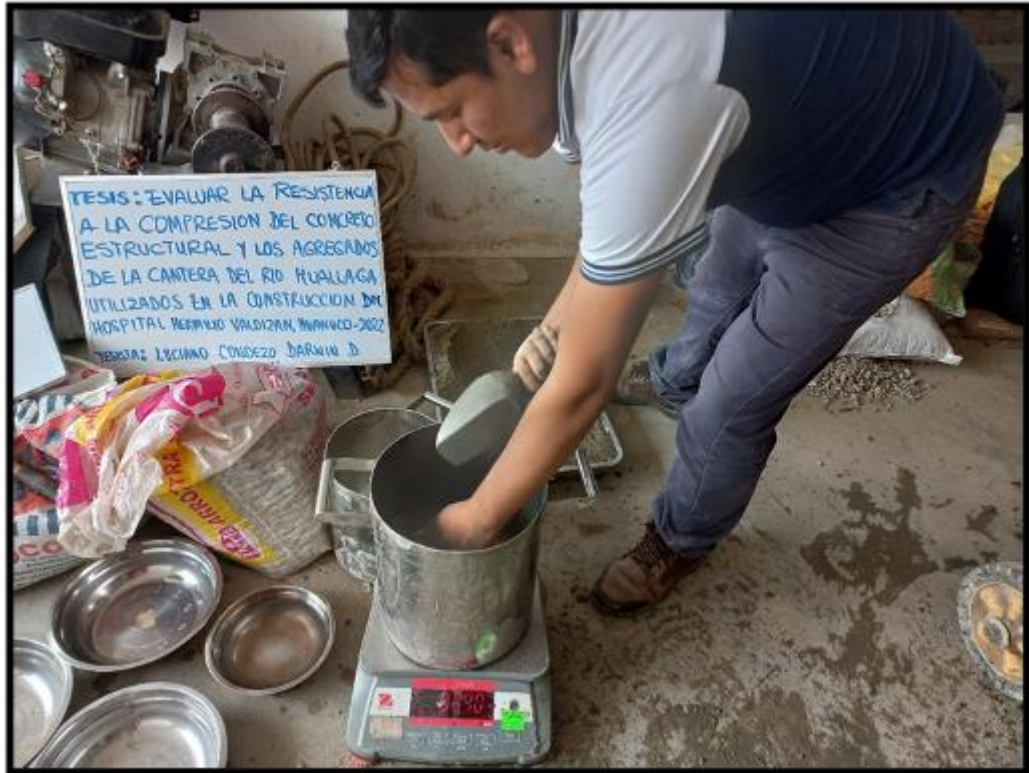
SE OBSERVA REALIZANDO LOS PESOS DE MATERIALES PARA LA MEZCLA
