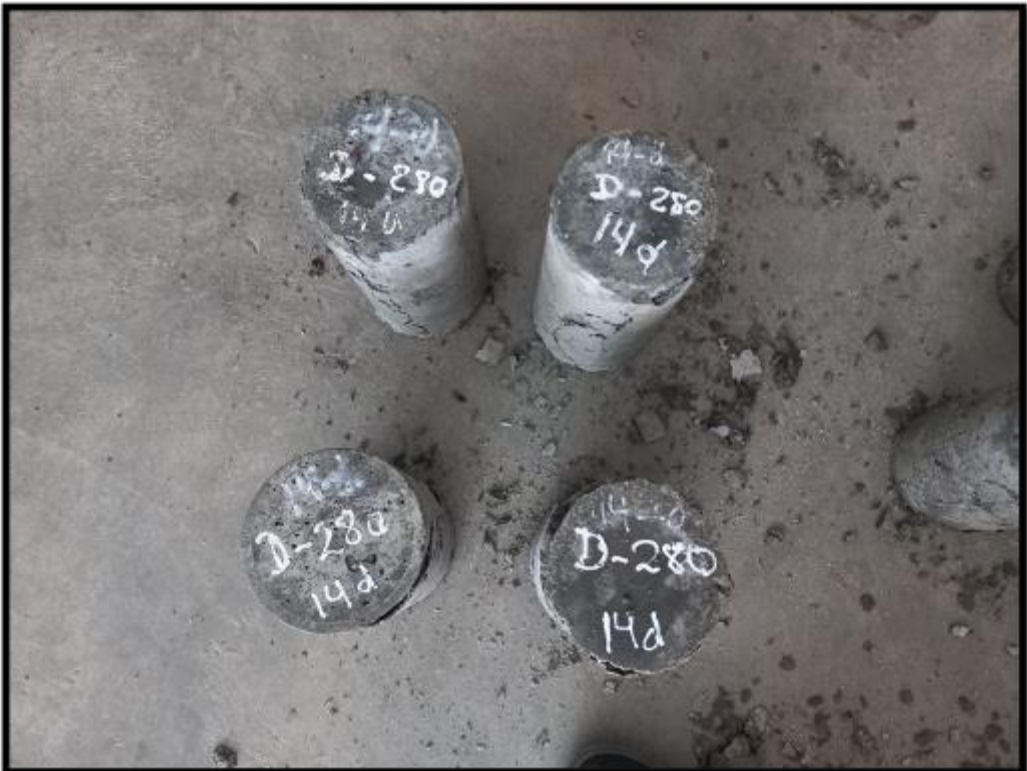
SE OBSERVA LAS PROBETAS EN EL ENSAYO DE ROTURA A LA COMPRESION FC=280 KG/CM2 (14 DIAS)
