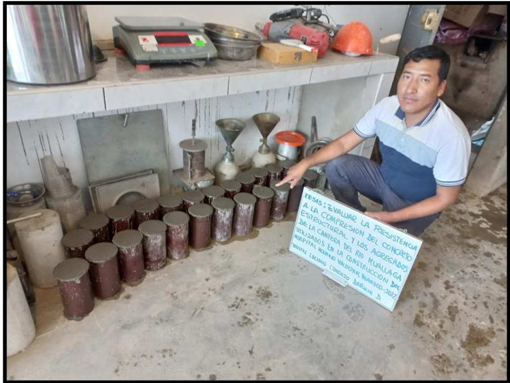
SE OBSERVA LAS PROBETAS CON LAS MEZCLAS RESPECTIVAS DE RESISTENCIAS SEGÚN DISEÑO DE MEZCLAS
