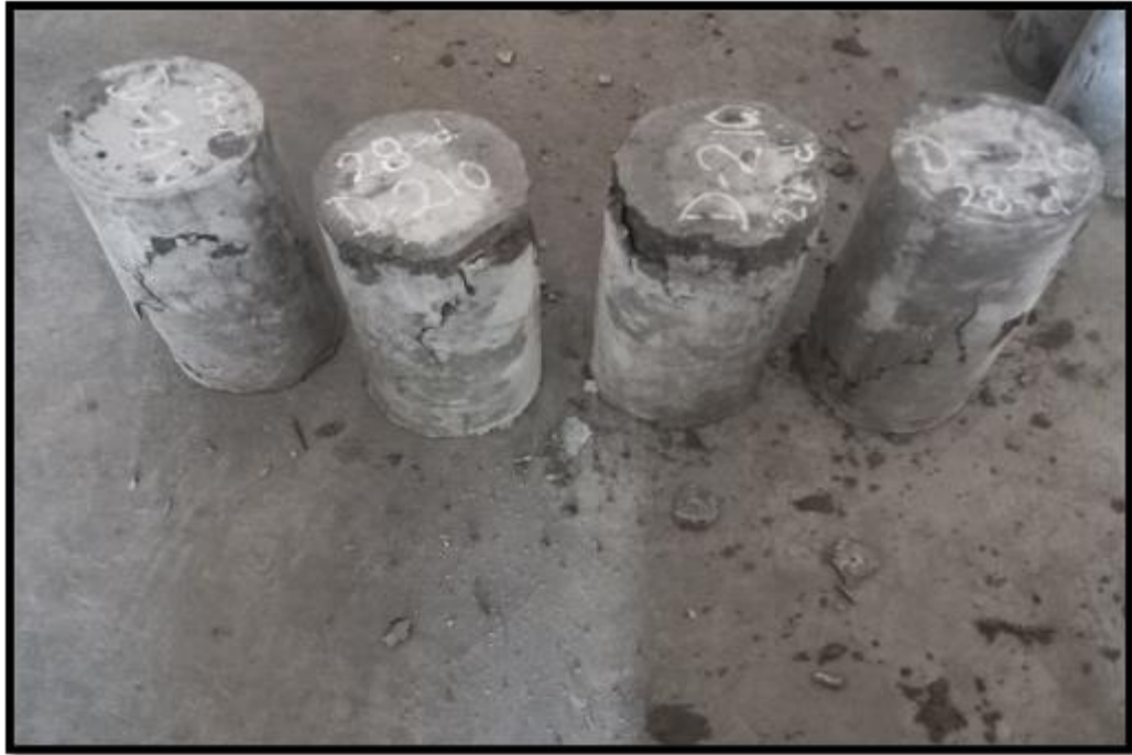
SE OBSERVA LAS PROBETAS EN EL ENSAYO DE ROTURA A LA COMPRESION FC=210 KG/CM2 (28 DIAS)
