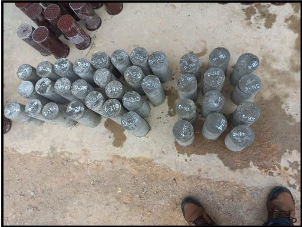
SE OBSERVA LAS MEZCLAS RESPECTIVAS Y CON CADA UNO DE LOS TIPOS DE RESISTENCIAS SEGÚN DISEÑO DE MEZCLAS
