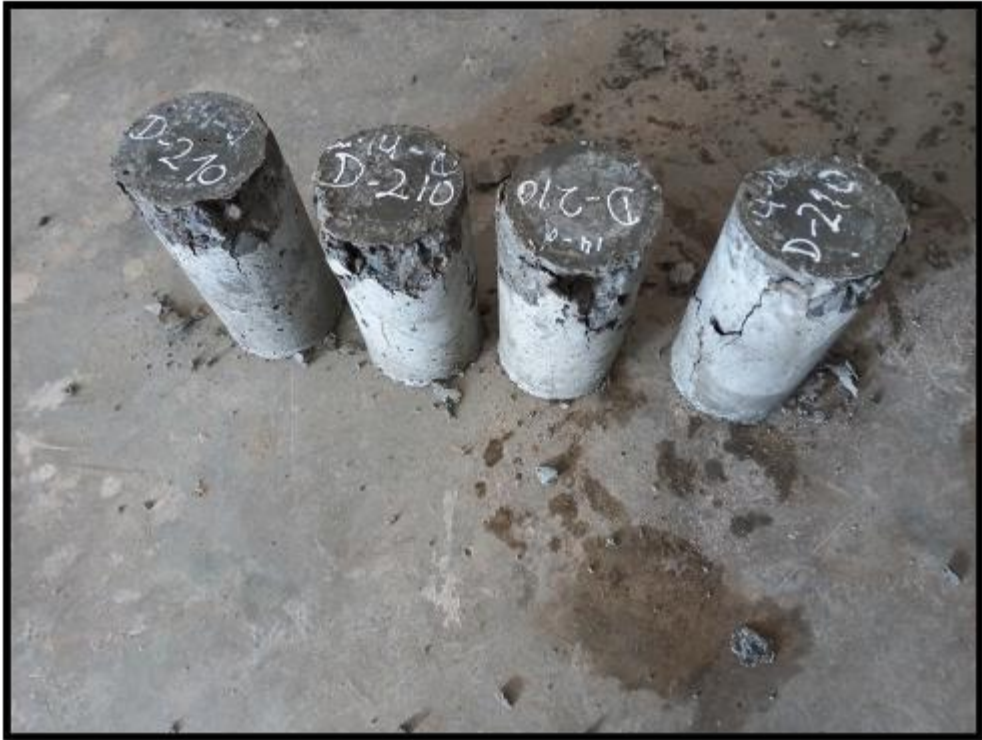
SE OBSERVA LAS PROBETAS EN EL ENSAYO DE ROTURA A LA COMPRESION FC=210 KG/CM2 (14 dias)
