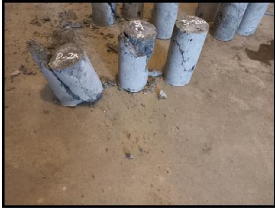
SE OBSERVA LAS PROBETAS EN EL ENSAYO DE ROTURA A LA COMPRESION FC=280 KG/CM 2 (7 DIAS)
