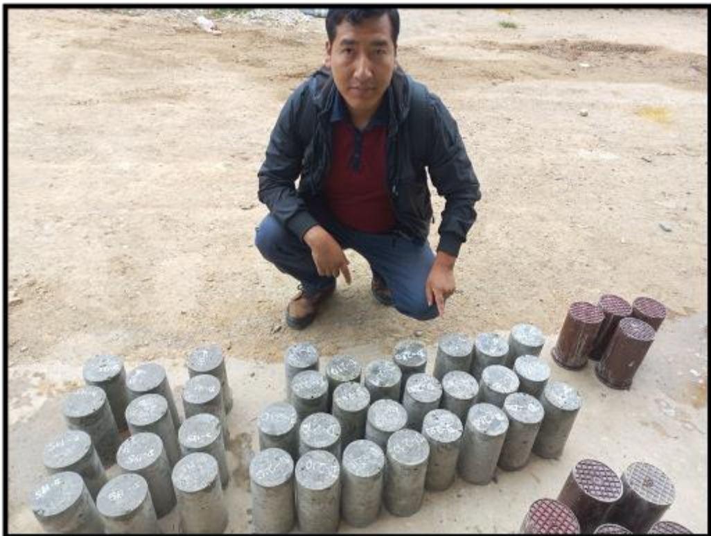
SE OBSERVA LA PROBETA PARA SER PUESTO A ROTURA DE COMPRESION
