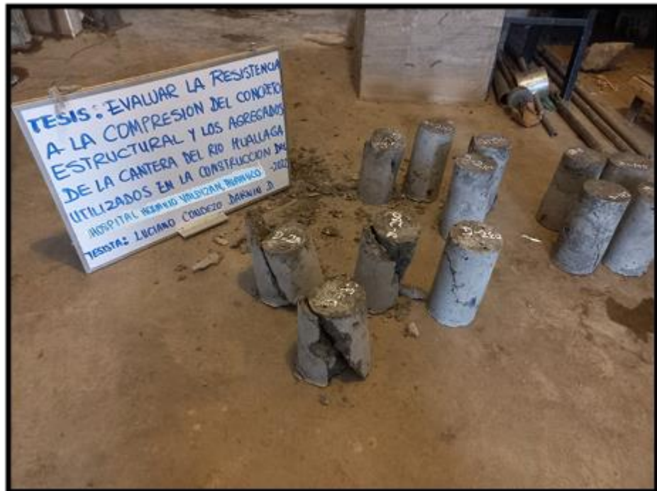
SE OBSERVA LAS PROBETAS EN EL ENSAYO DE ROTURA A LA COMPRESION A LOS 7 DIAS
