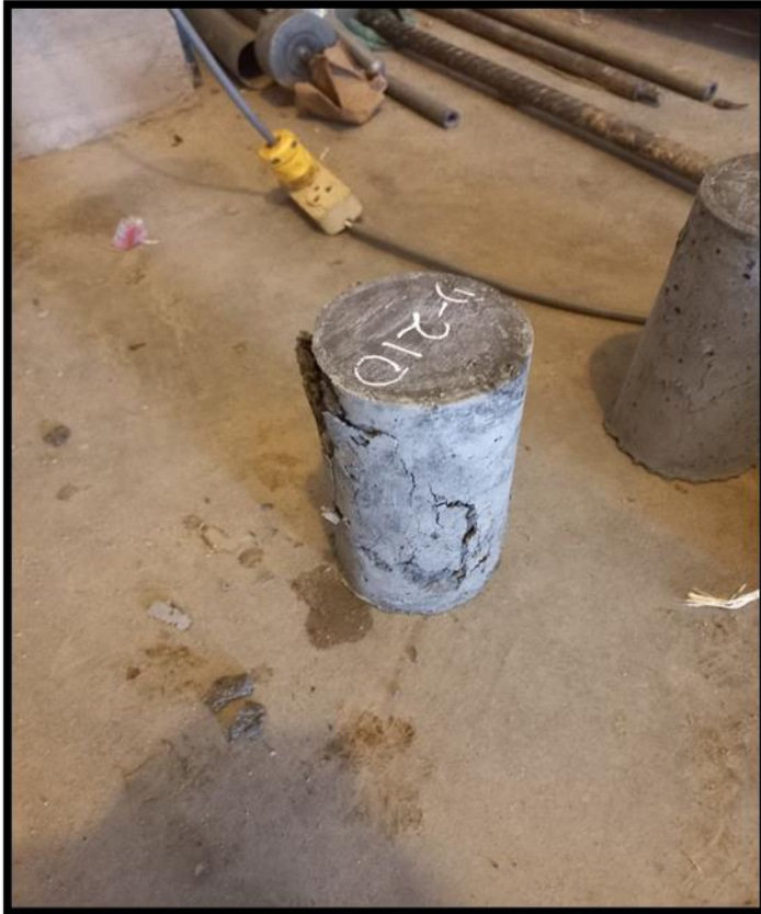
SE OBSERVA LA PROBETA EN EL ENSAYO DE ROTURA A LA COMPRESION
