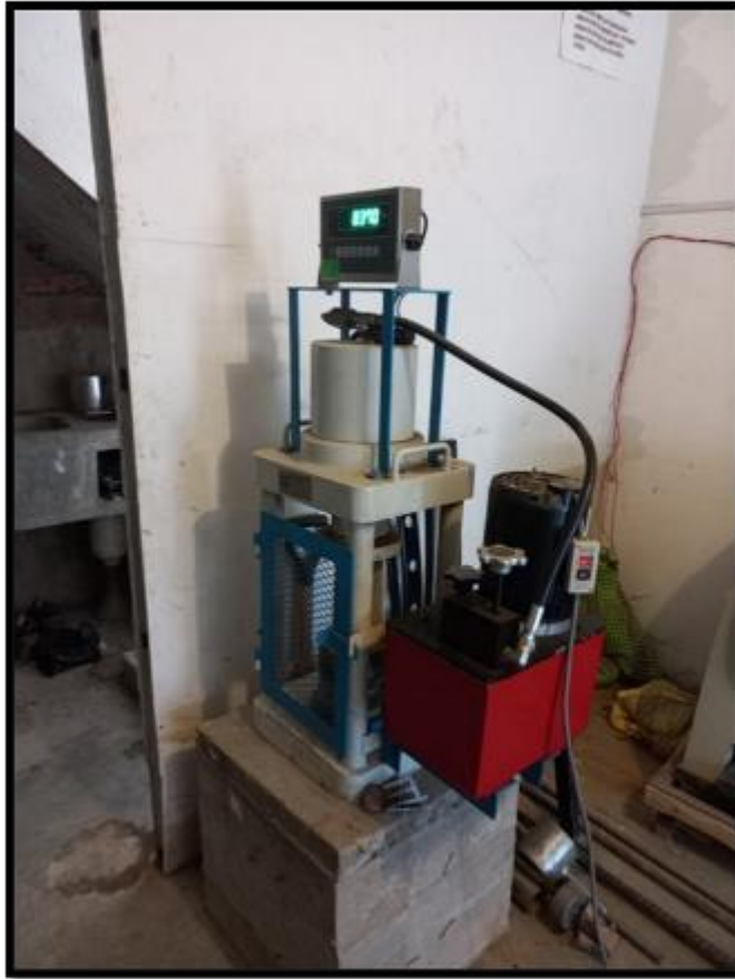
SE OBSERVA LA PROBETA EN ENSAYO DE ROTURA A LA COMPRESION
