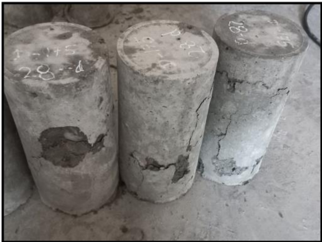
SE OBSERVA LAS PROBETAS EN EL ENSAYO DE ROTURA A LA COMPRESION FC=175 KG/CM2 (28 DIAS)
