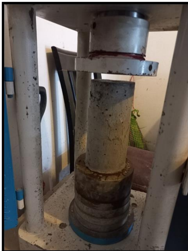
SE OBSERVA LA PROBETA EN EL ENSAYO DE ROTURA A LA COMPRESION
