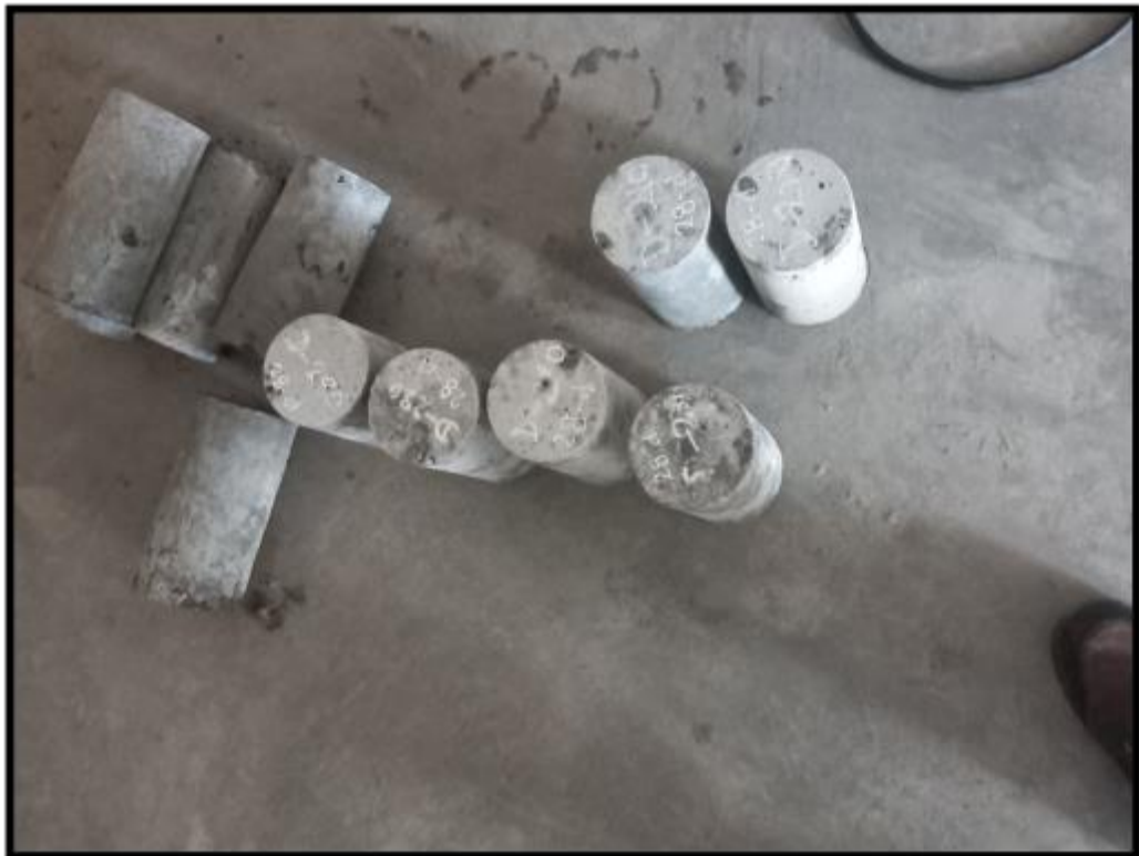
SE OBSERVA LAS PROBETAS EN EL ENSAYO DE ROTURA A LA COMPRESION FC=280 KG/CM2 (28 DIAS)
