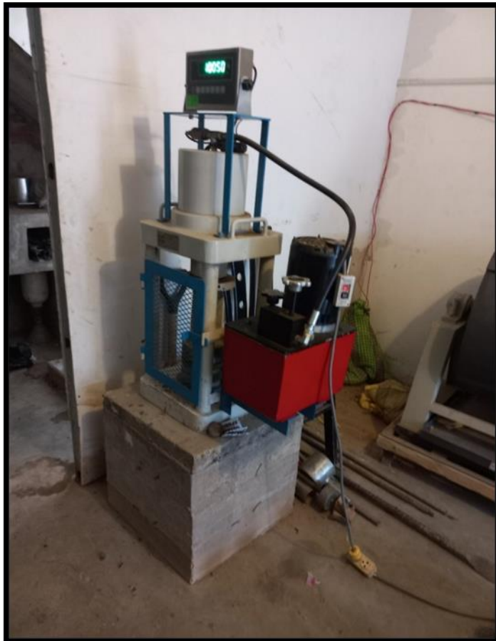
SE OBSERVA LA PROBETA EN ENSAYO DE ROTURA A LA COMPRESION
