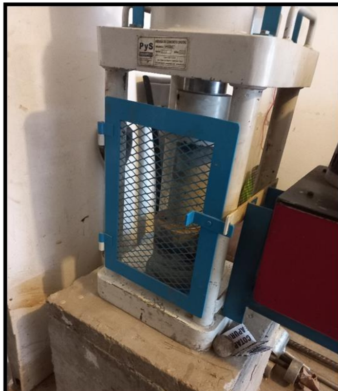
SE OBSERVA LA PROBETA EN EL ENSAYO DE ROTURA A LA COMPRESION
