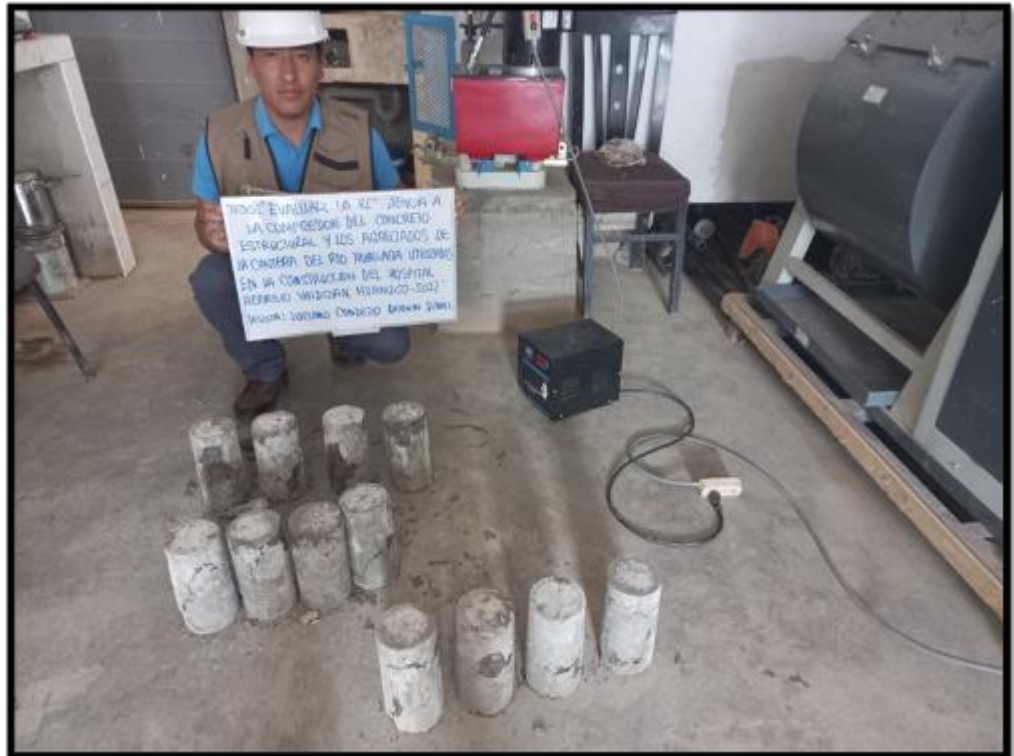
SE OBSERVA LAS PROBETAS EN EL ENSAYO DE ROTURA A COMPRESION A 28 DIAS
