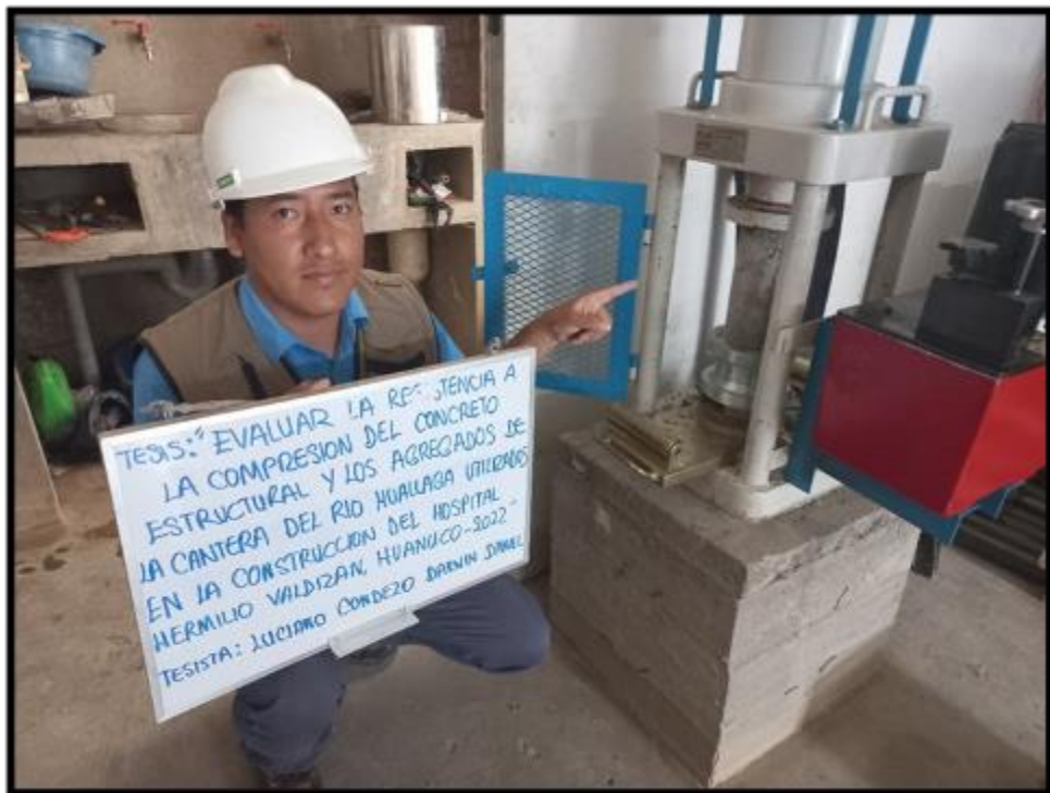
SE OBSERVA LA PROBETA EN EL ENSAYO DE ROTURA A COMPRESION A 28 DIAS
