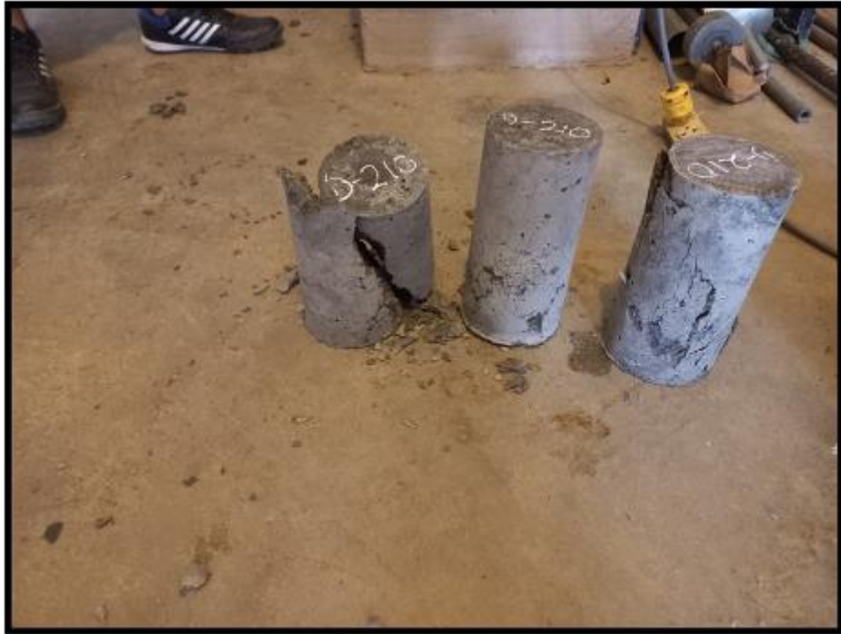
SE OBSERVA LAS PROBETAS EN EL ENSAYO DE ROTURA A LA COMPRESION FC=210 \text{ KG/CM}^2 (7 DIAS)
