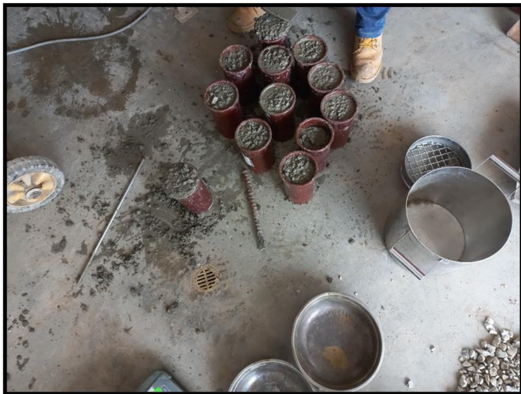
SE OBSERVA LOS MATERIALES PARA EL MEZCLADO Y SU POSTERIOR LLENADO EN PROBETAS
