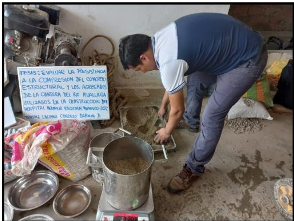
SE OBSERVA REALIZANDO LOS PESOS DE MATERIALES PARA LA MEZCLA
