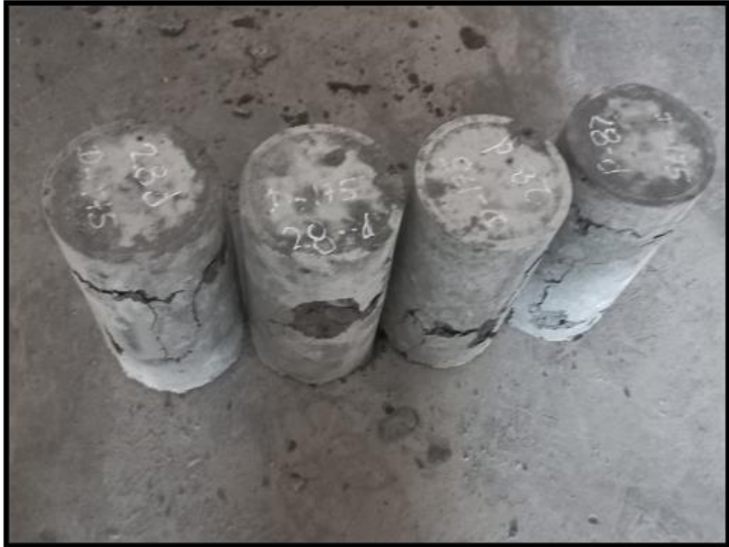
SE OBSERVA LAS PROBETAS EN EL ENSAYO DE ROTURA A LA COMPRESION FC=175 KG/CM2 (28 DIAS)
