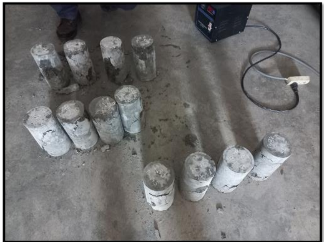
SE OBSERVA LAS PROBETAS EN EL ENSAYO DE ROTURA A COMPRESION A 28 DIAS
