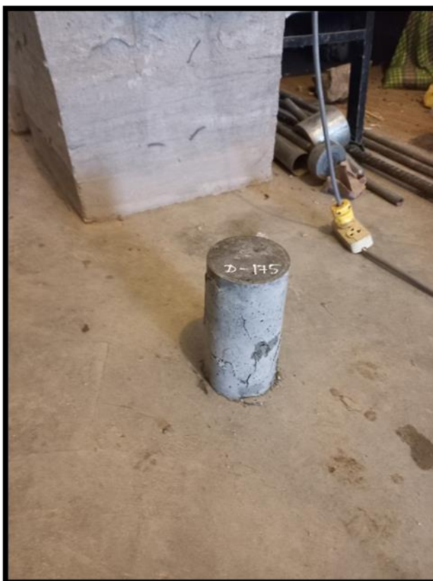
SE OBSERVA LA PROBETA EN ENSAYO DE ROTURA A LA COMPRESION FC=175 KG/CM2 (7 dias)
