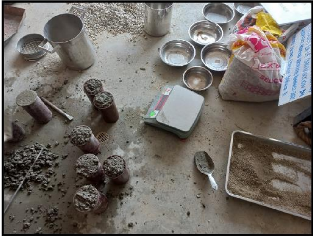
SE OBSERVA EL LLENADO DE PROBETAS CON LAS MEZCLAS REALIZADAS PARA CADA TIPO DE RESISTENCIA DE CONCRETO
