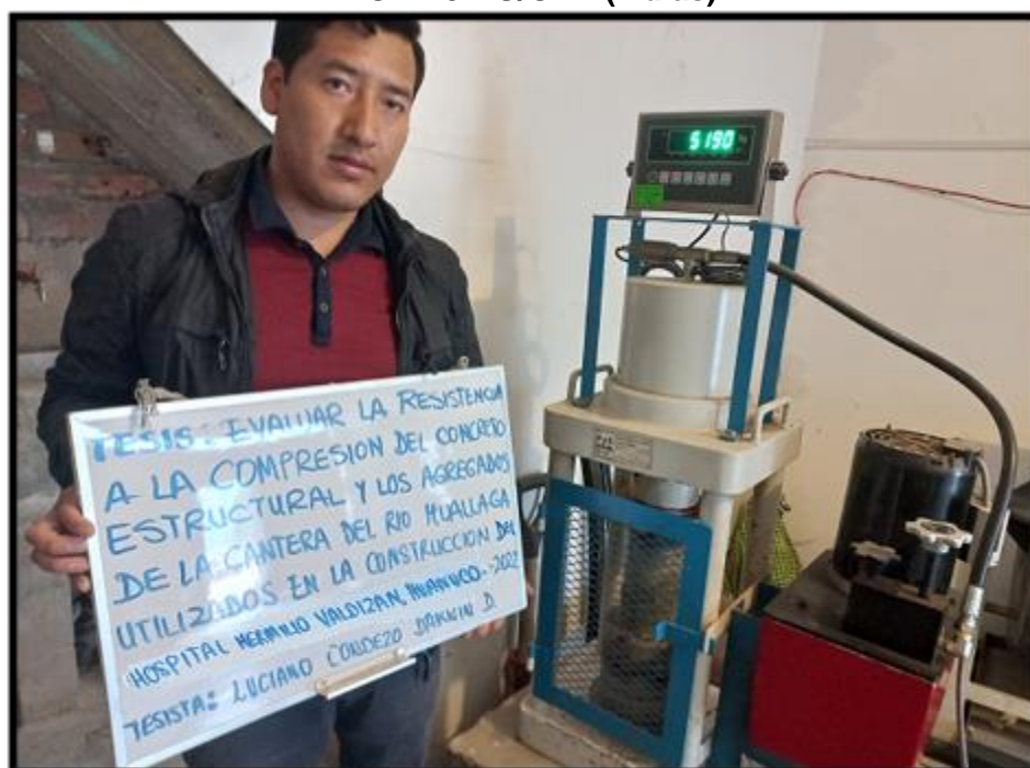
SE OBSERVA LA PROBETA EN ENSAYO DE ROTURA A LA COMPRESION FC=175 KG/CM2 (7 dias)
