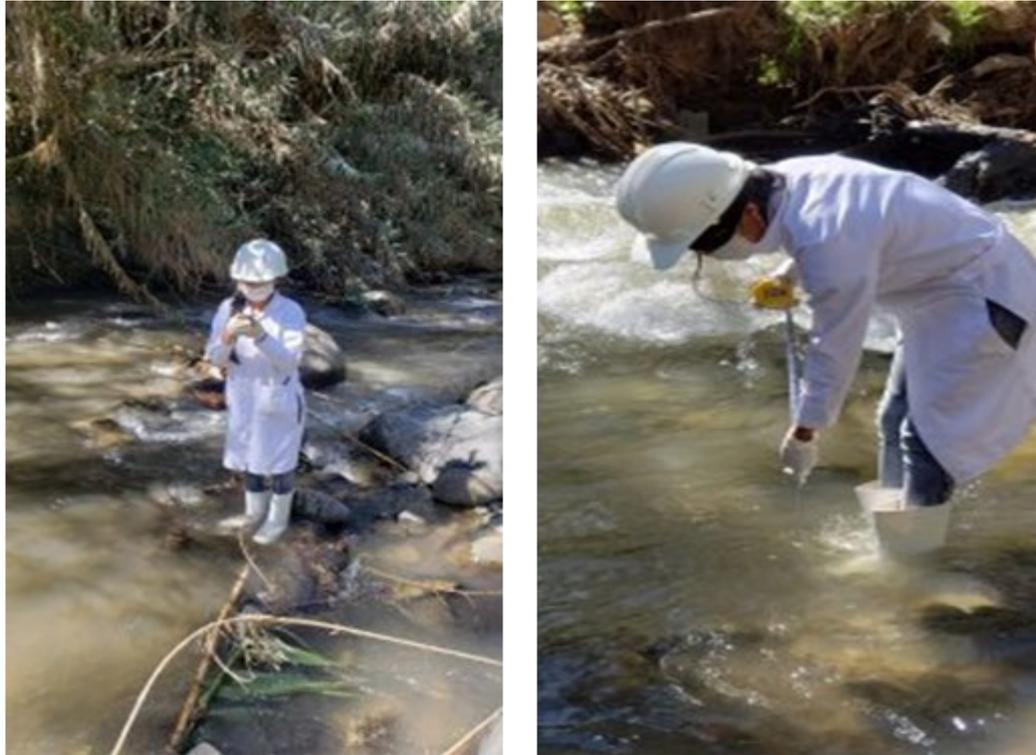
Nota. Cálculo del caudal en el río Mito, donde fue necesario la utilización de un flotador (tecnopor), wincha de 5 metros y cronometro, obtenido un caudal promedio de 490 litros por segundo.
