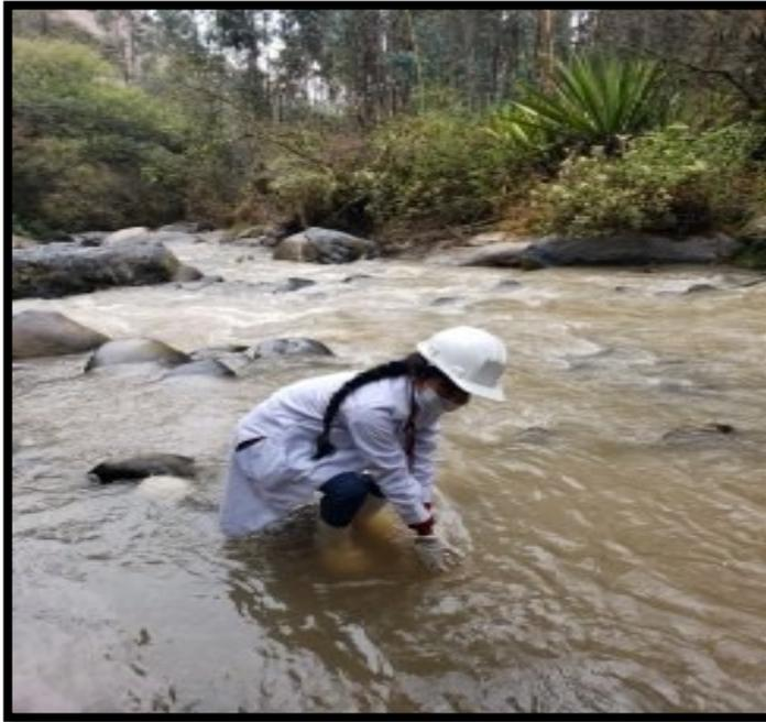
Nota. En dicha figura llega a mostrarse la manera de coleccionar la muestra 100m después del punto del vertimiento
