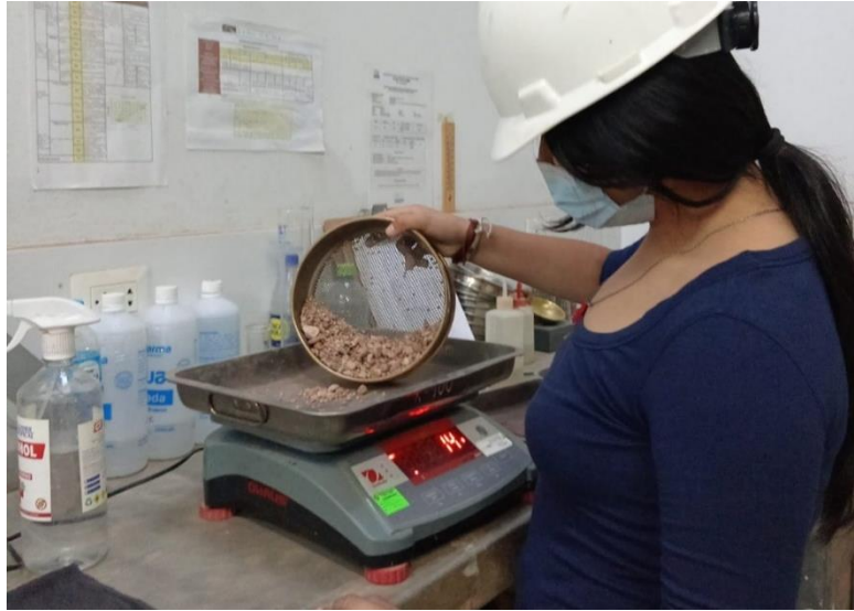
Figura 68 Pesado de material retenido en cada tamiz
