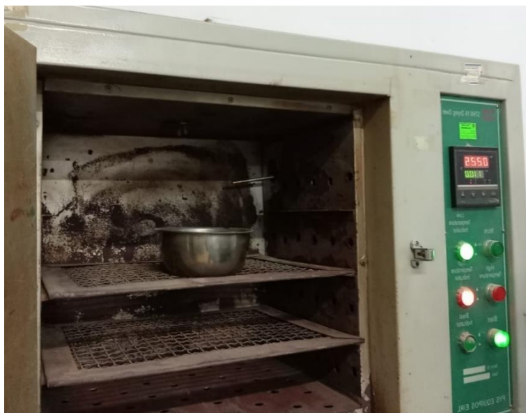
Figura 65 Agregados posteriormente del proceso de secado en el horno
