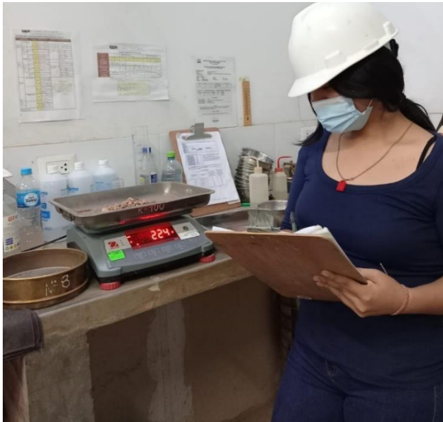
Figura 66 Toma de datos para el Análisis Granulométrico
