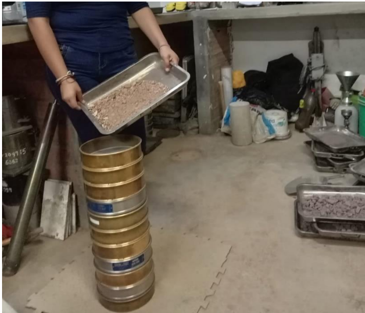
Figura 67 Tamizado de agregado para Granulometría
