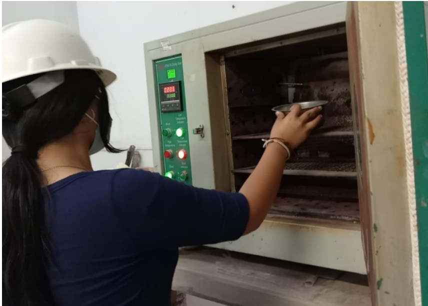
Figura 64 Proceso de colocación del agregado en el horno
