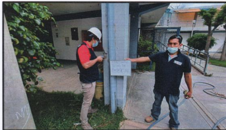
Vista fotográfica de la realización del ensayo de esclerometría E-01
