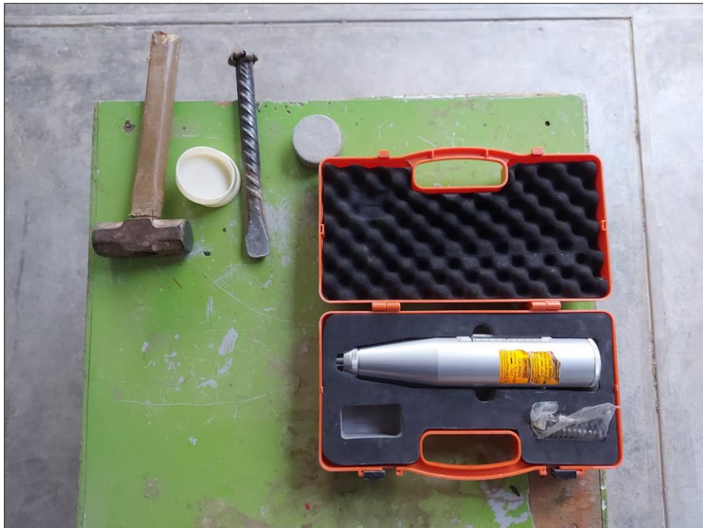
Vista fotográfica de equipo y herramientas para el ensayo de esclerometría en el módulo I.
