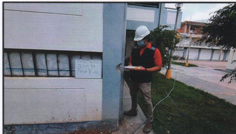
Vista fotográfica de la realización del ensayo de esclerometría E-02
