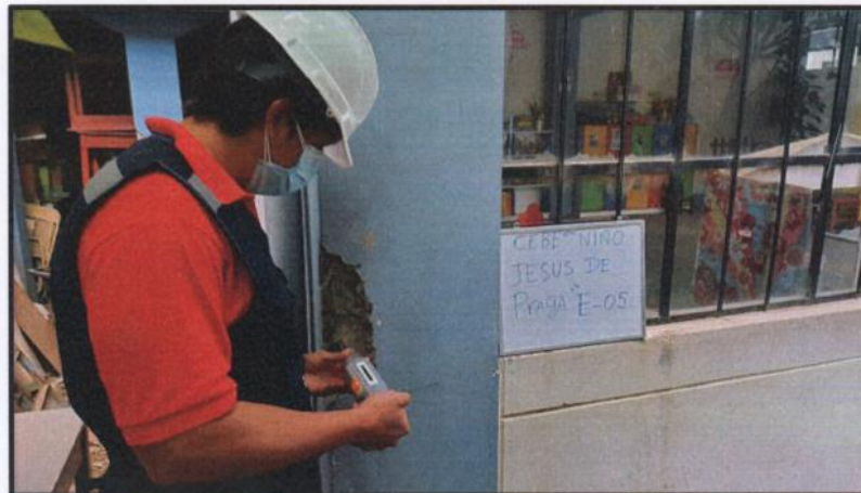
Vista fotográfica de la realización del ensayo de esclerometria E-05
