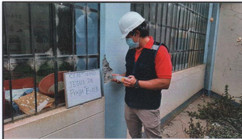
Vista fotográfica de la realización del ensayo de esclerometria E-03
