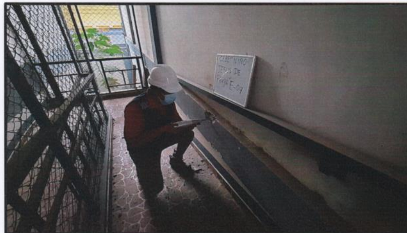
Vista fotográfica de la realización del ensayo de esclerometría E-07
