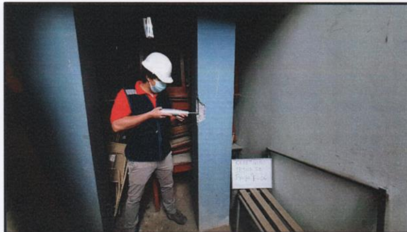
Vista fotográfica de la realización del ensayo de esclerometria E-06
