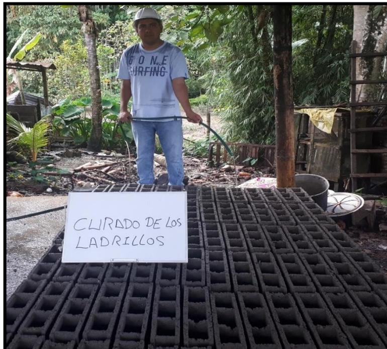
Se continua con el proceso de curado de los bloques de concreto (ladrillos), después de 08 horas del proceso de fabricación, para obtener una buena calidad y resistencia.
