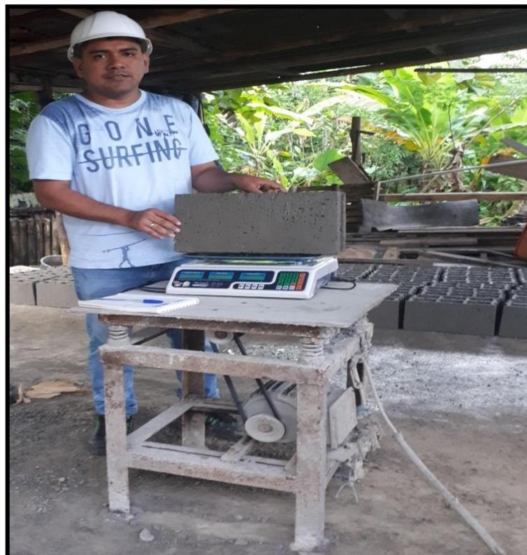
Realizamos el control de calidad con el pesado de los bloques de concreto (ladrillos).
