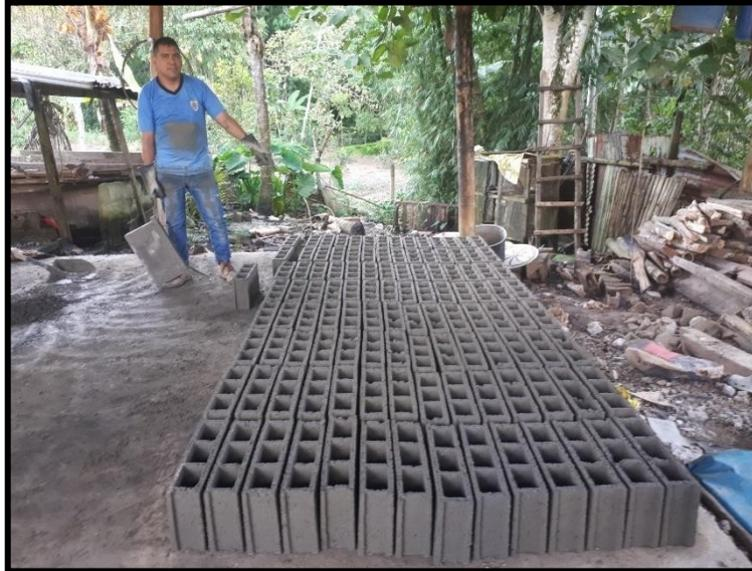
Se finaliza con el proceso de fabricación de los bloques de concreto (ladrillos), con una población total de 80 unidades.
