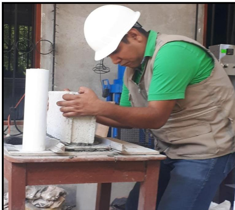
Seguidamente realizamos la colocación de bloque de concreto (ladrillos), a la mezcla obtenido entre yeso y cemento, para obtener una superficie uniforme.
