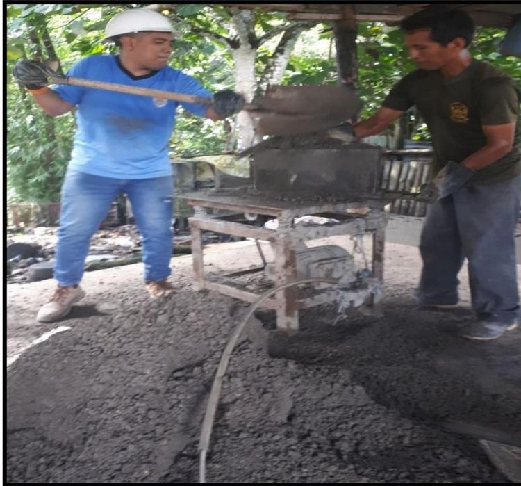
Se continua con el proceso del llenado de la mezcla echo con residuos de construcción y demolición al molde metálico para la fabricación de los bloques de concreto (ladrillos).
