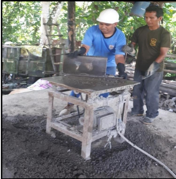
Se realiza el proceso del vibrado con el llenado de la mezcla al molde metálico para la fabricación de los bloques de concreto (ladrillos).
