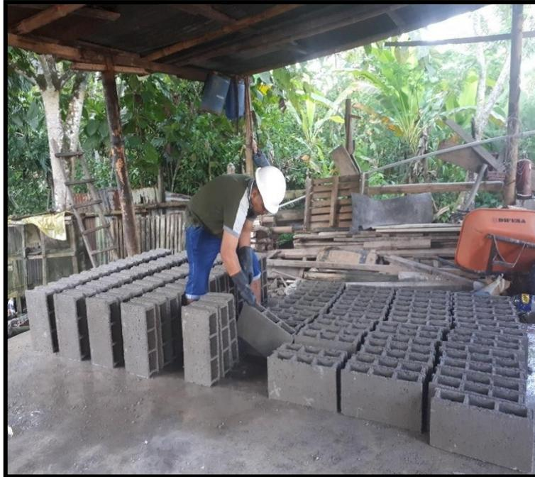
Para finalizar el proceso de cura realizamos, ponemos los bloques de concreto (ladrillo) en forma vertical para su secado.
