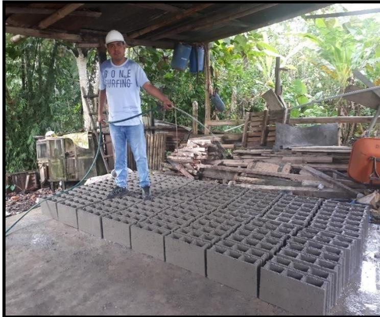
Se inician con el proceso de curado de los bloques de concreto (ladrillos), después de 04 horas de haberse finalizados con todo el proceso de fabricación.
