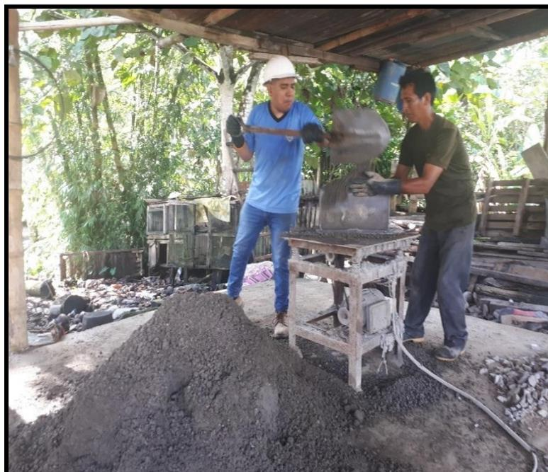
Se realiza el proceso de llenado de la mezcla realizado con RC y D, al molde metalico para la fabricación de los bloques de concreto (ladrillos).
