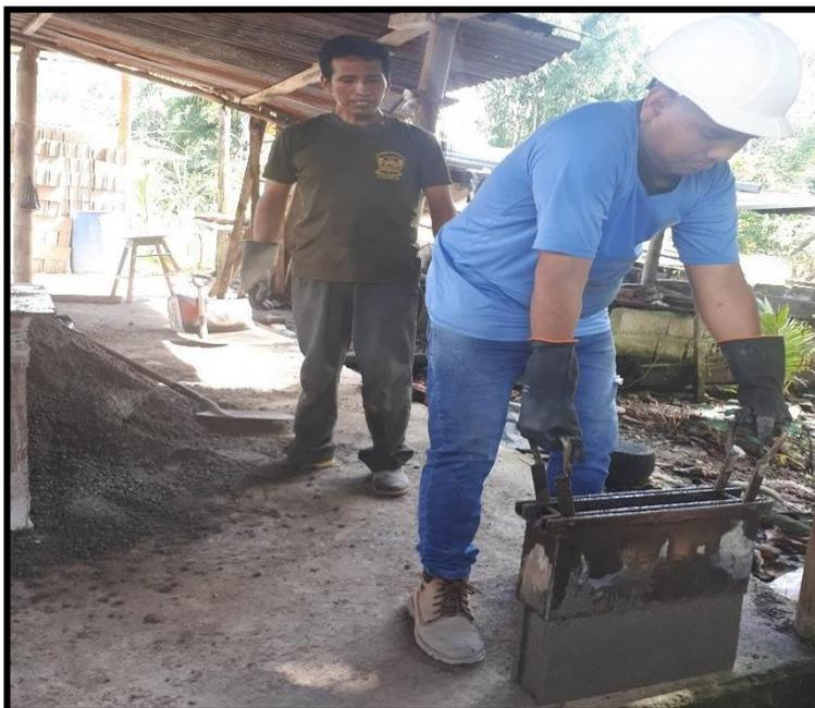
A continuación, realizamos proceso de desmolde del molde metálico luego del vibrado en mesa vibradora.
