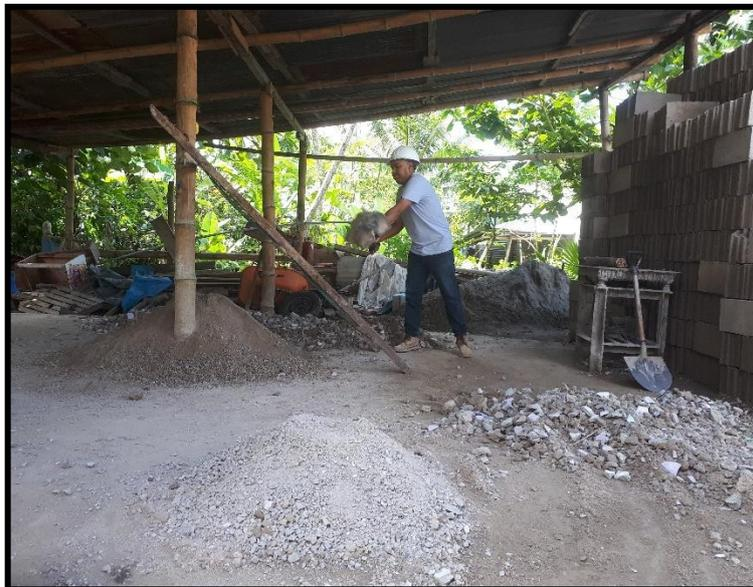
Se realiza el proceso de tamizaje de agregado pasando por la malla N°4, para obtener un agregado adecuado para realizar el proceso de mezclado, para la elaboración de los ladrillos.
