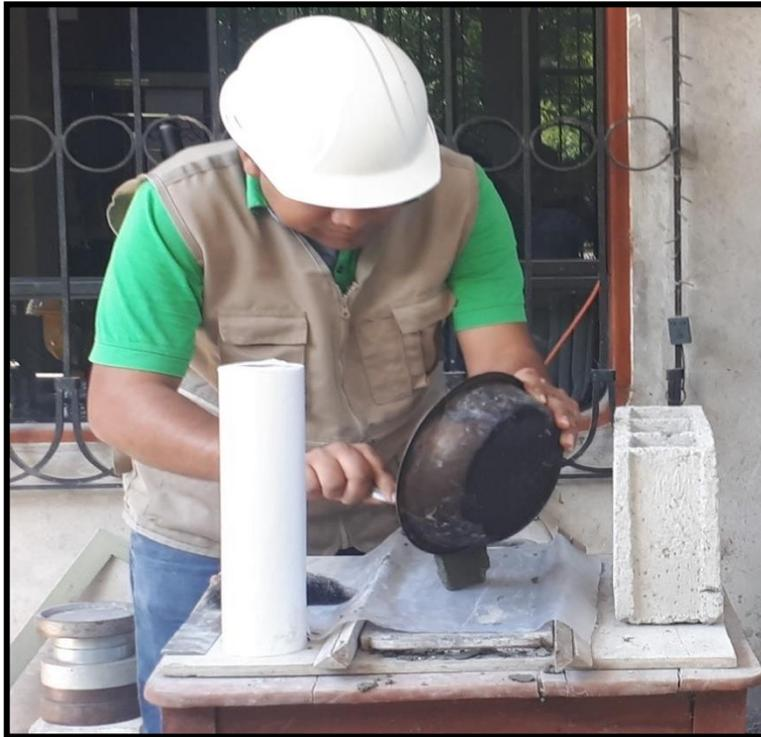
Aplicamos la mezcla obtenida entre yeso y cemento, una superficie uniforme para iniciar el procedimiento.
