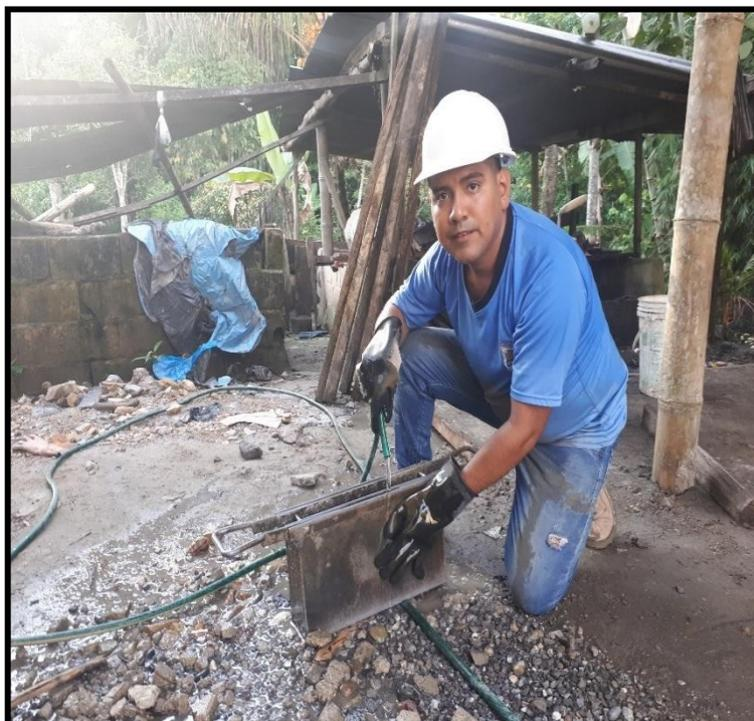
Finalizamos con todo el proceso de fabricación de los bloques de concreto (ladrillos) con la limpieza de molde metálico.
