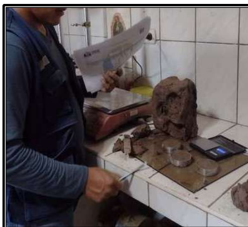
Nota: Preparación de la muestra para el Ensayo de Corte Directo canal Canchan Lindero – Tomaykichwa, Provincia de Ambo.
