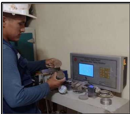
Nota: Ensayo de Corte Directo canal Canchan Lindero – Tomaykichwa, Provincia de Ambo.
