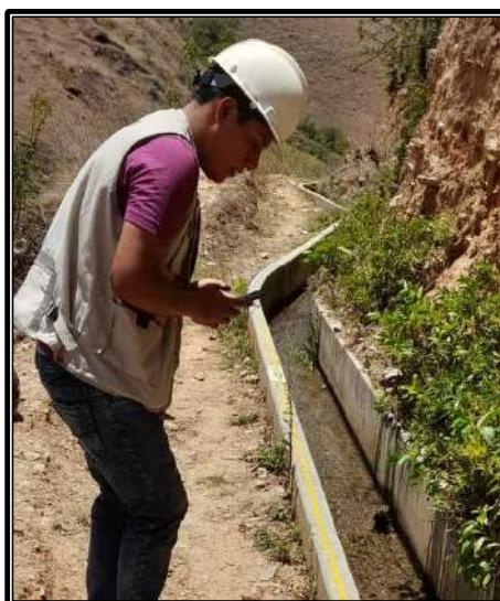
Nota: Toma de tiempos del tramo afectado en el canal Canchan Lindero – Tomaykichwa, Provincia de Ambo.
