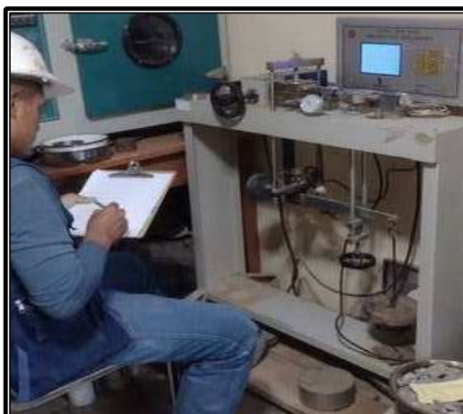
Nota: Ensayo de Corte Directo canal Canchan Lindero – Tomaykichwa, Provincia de Ambo.
