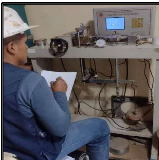
Nota: Toma de datos del Aparato de Corte Directo canal Canchan Lindero – Tomaykichwa, Provincia de Ambo.
