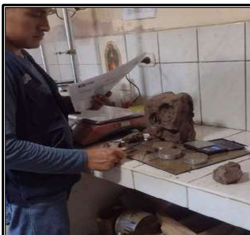
Nota: Preparación de la muestra para el Ensayo de Corte Directo canal Canchan Lindero – Tomaykichwa, Provincia de Ambo.
