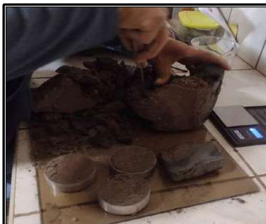
Nota: Preparación de la muestra para el Ensayo de Corte Directo canal Canchan Lindero – Tomaykichwa, Provincia de Ambo.
