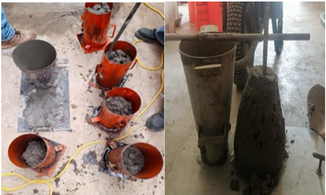
Fotografía 32 Ensayo de Slump a las probetas
