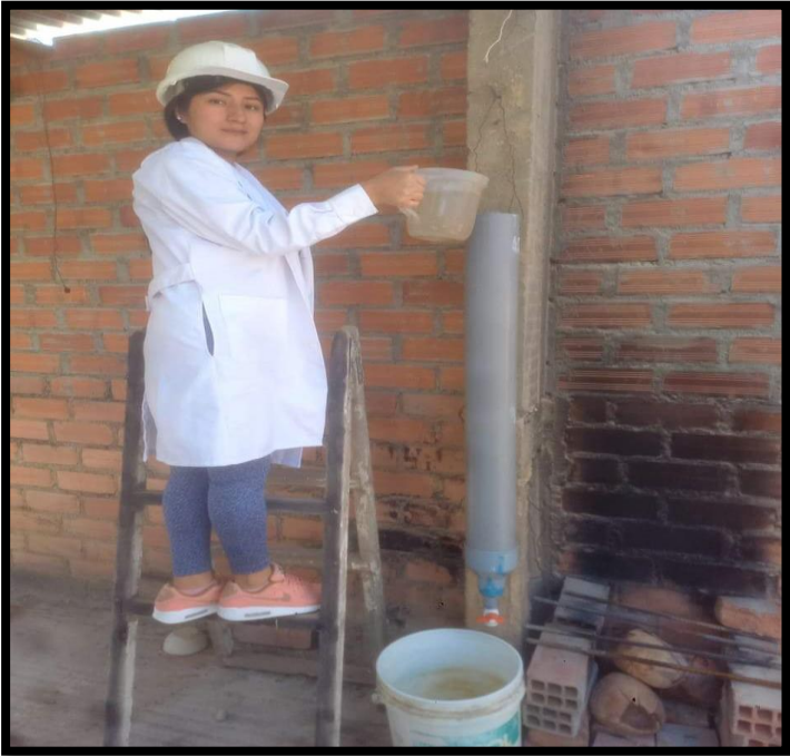
Filtración del lixiviado en el filtro con carbón activado de coco
