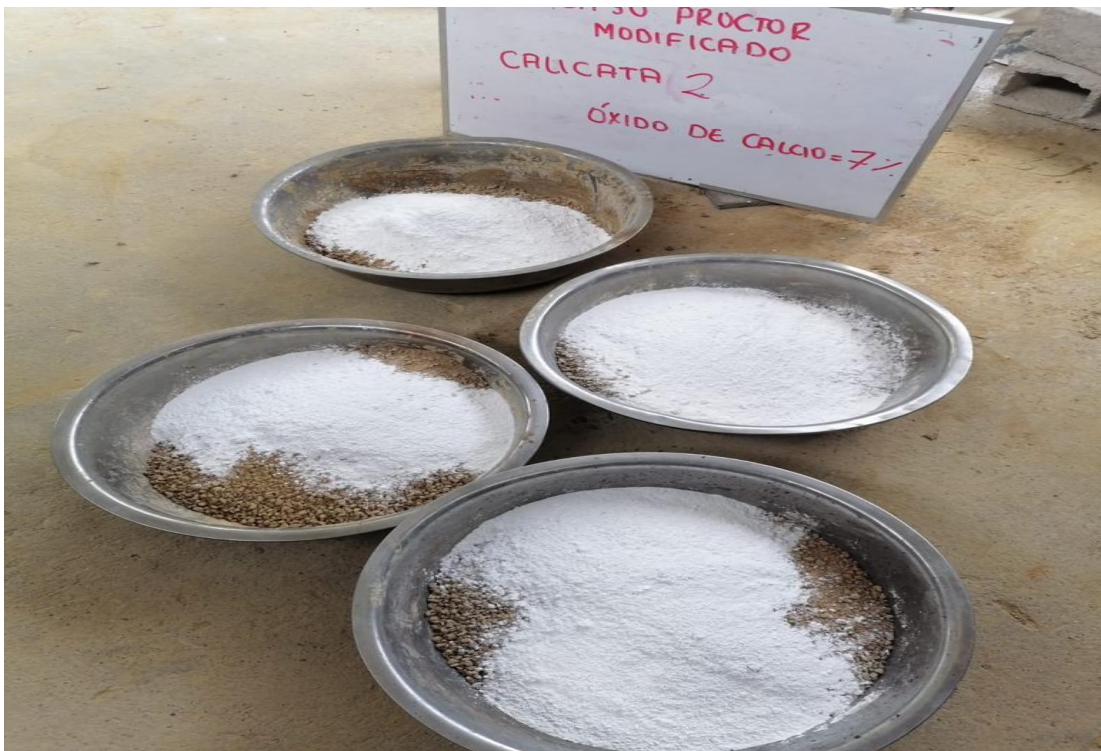
Aplicación del 7 % de óxido de calcio a la muestra de la calicata N° 02, para el ensayo de Proctor Modificado.
