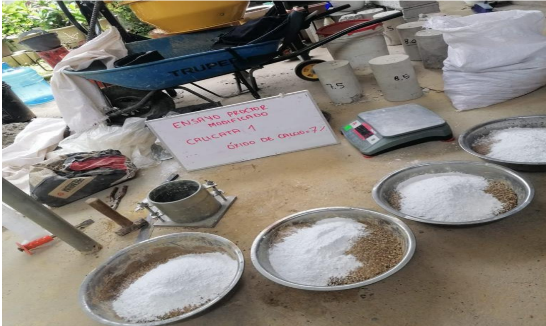
Aplicación del 7 % de óxido de calcio a la muestra de la calicata N° 01, para el ensayo de Proctor Modificado.
