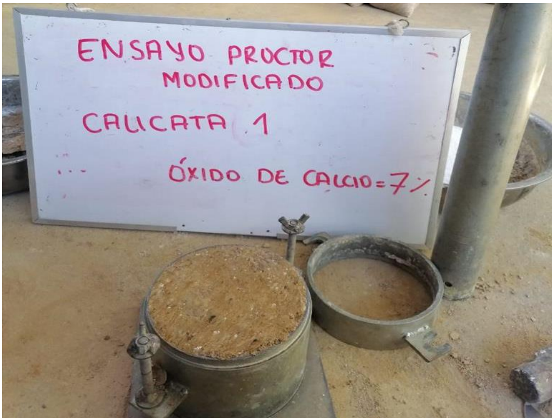
Molde de compactación con la adición del 7 % de óxido de calcio a la muestra de la calicata N° 01, para el ensayo de Proctor Modificado.
