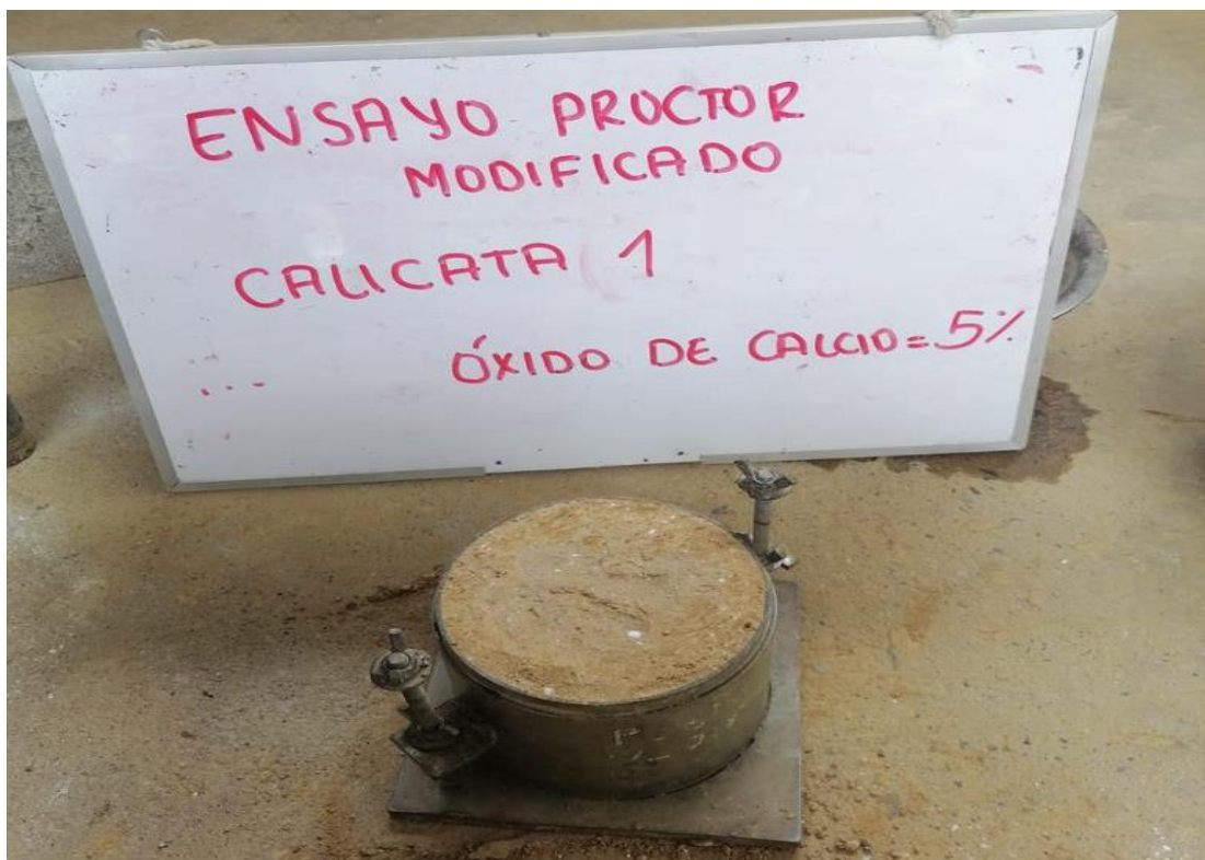
Molde de compactación con la adición del 5 % de óxido de calcio a la muestra de la calicata N° 01, para el ensayo de Proctor Modificado.
