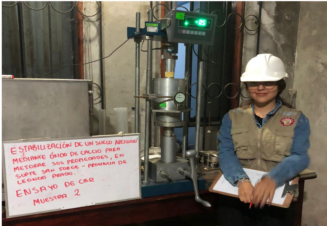
Ensayo de penetración en la prensa CBR para la muestra N° 02 de la Calicata N° 01.
