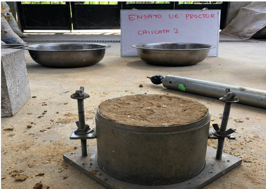
Molde de compactación con la adición del 3 % de óxido de calcio a la muestra de la calicata N° 02, para el ensayo de Proctor Modificado.
