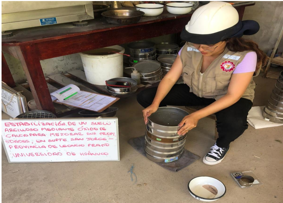
Se realizó el ensayo granulométrico a las muestras de las calicatas.
