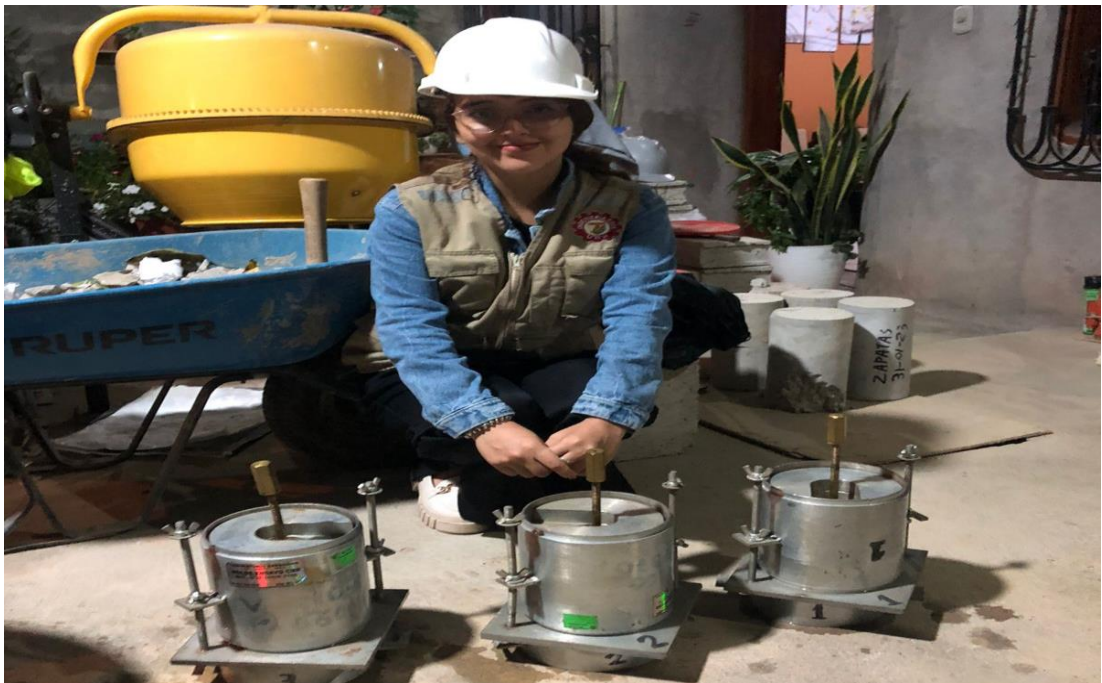
Moldes de compactación para el ensayo de CBR, que contiene el collar y disco espaciador, a diferente energía de compactación que fueron de 56, 25, 10 golpes respectivamente.
