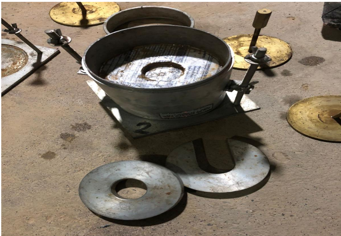
Se puede observar el molde de la muestra N° 02 que se realizó a través de Ensayo de penetración en la prensa CBR.
