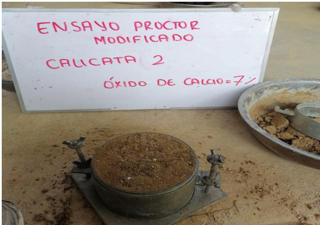
Molde de compactación con la adición del 7 % de óxido de calcio a la muestra de la calicata N° 02, para el ensayo de Proctor Modificado.
