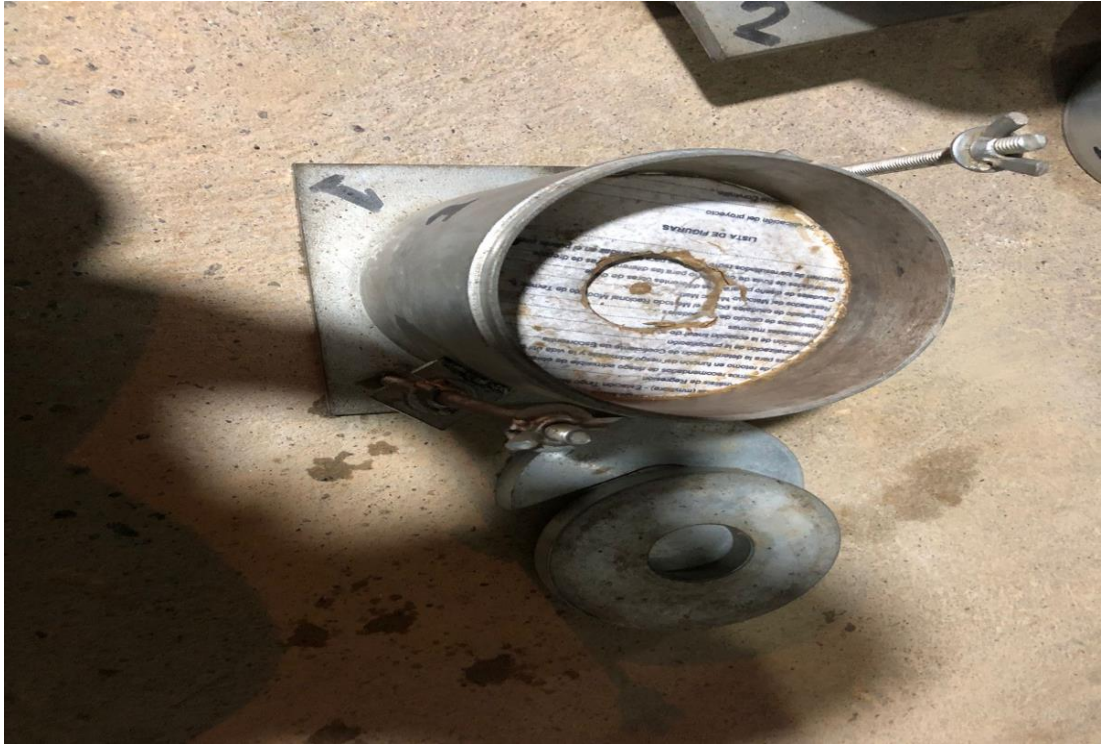
Se puede observar el molde de la muestra N° 01 que se realizó a través de Ensayo de penetración en la prensa CBR.
