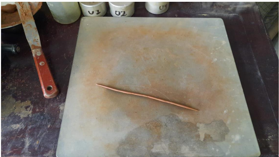
Se realizó el ensayo de índice de plasticidad, con el suelo saturado, realizando rollos con un diámetro de 3 mm y un largo de 6 mm.
