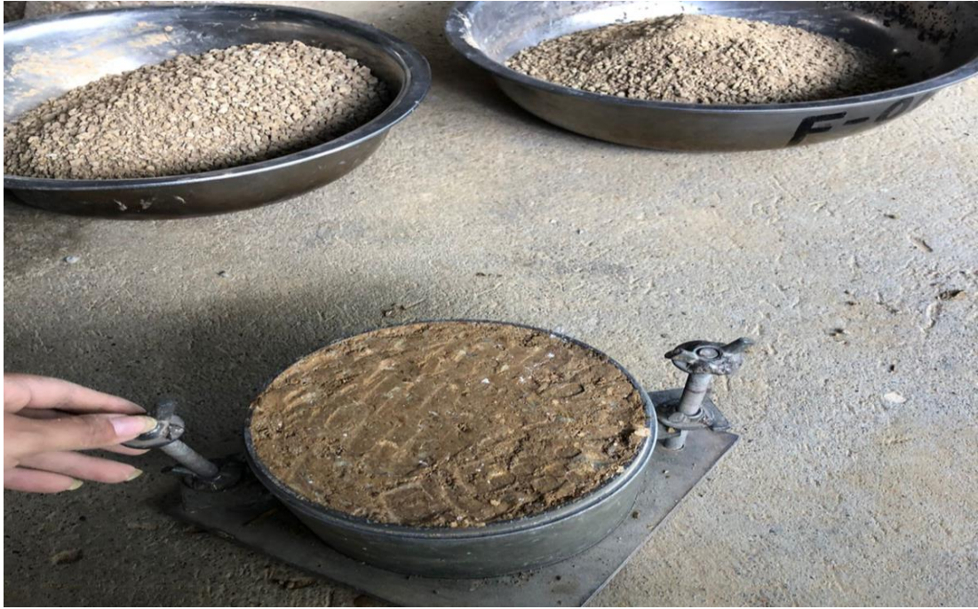
Molde de compactación con la adición del 5 % de óxido de calcio a la muestra de la calicata N° 02, para el ensayo de Proctor Modificado.
