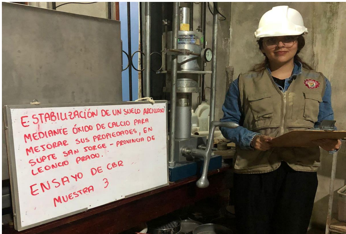
Ensayo de penetración en la prensa CBR para la muestra N° 03 de la Calicata N° 01.
