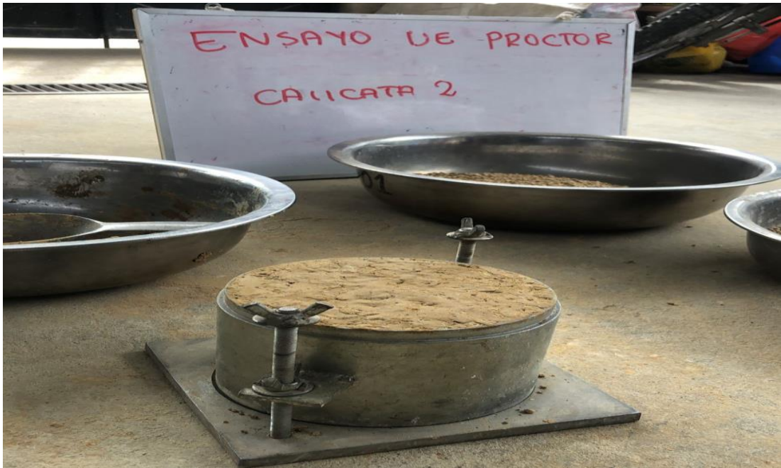
Molde de compactación con la adición del 1 % de óxido de calcio a la muestra de la calicata N° 02, para el ensayo de Proctor Modificado.
