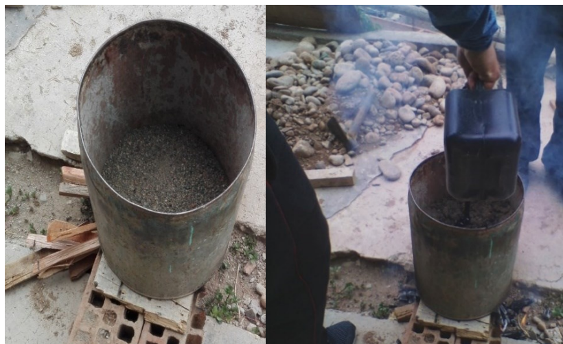
Calentado de la arena por 5 minutos y posterior vaciado del asfalto para su mezclado respectivo.
