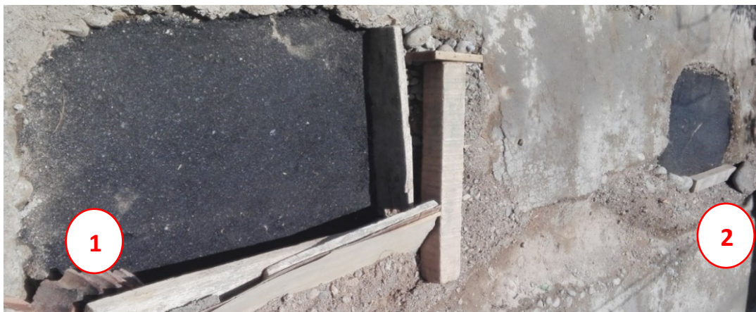
Prototipos de vía asfaltada. La primera con capa de piedras de canto rodado.
