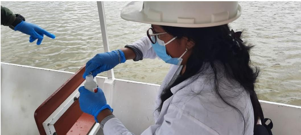
*Toma de muestra de Coliformes Termotolerantes*
