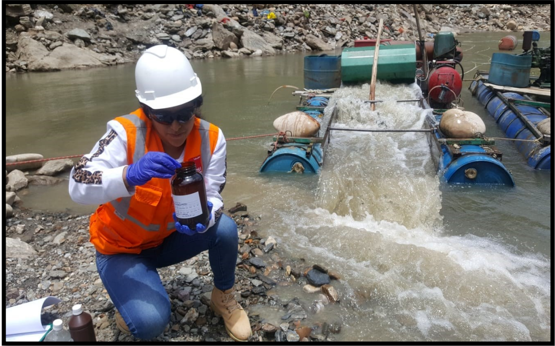
Fotografía: En las muestras de agua recolectada se ha añadido reactivos como H_2SO_4 y HNO_3 con la finalidad de preservar las muestras de agua.
