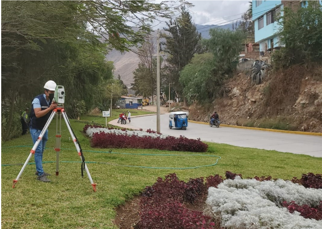
Trabajos de Levantamiento Topográfico con la ayuda de un ESTACION TOTAL- Leica en la zona en Estudio.
