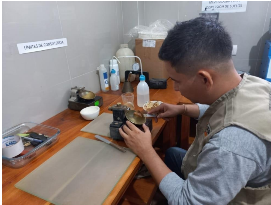
Se aprecia al personal técnico especializado realizando el Ensayo de Límite Líquido (NTP: 339.129)
