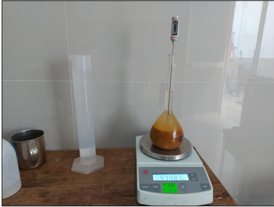
Se aprecia al personal técnico especializado realizando el Ensayo de Gravedad Específica (NTP: 339.131)
