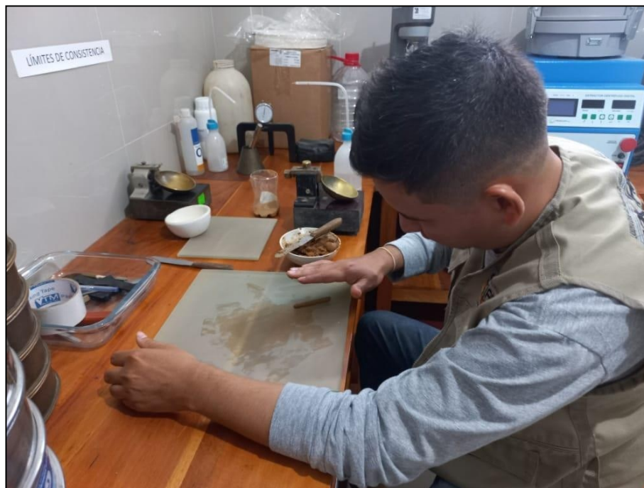
Se aprecia al personal técnico especializado realizando el Ensayo de Límite Plástico (NTP: 339.129)
