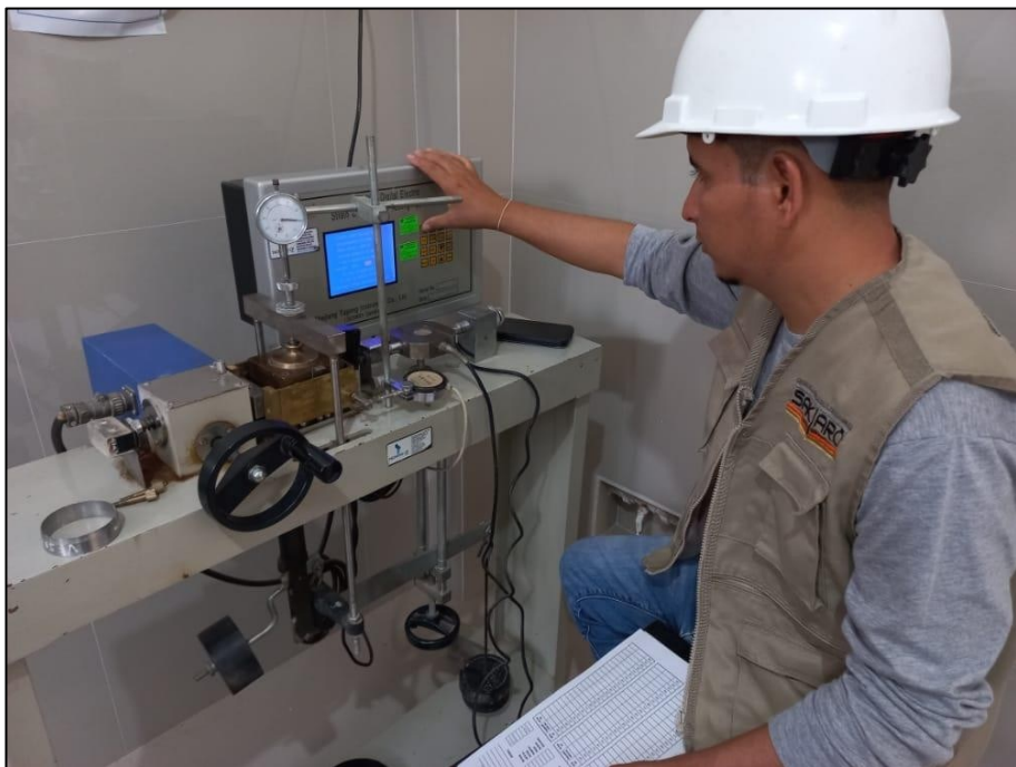
Se aprecia al personal técnico especializado realizando el Ensayo de Corte Directo Residual (NTP: 339.171)
