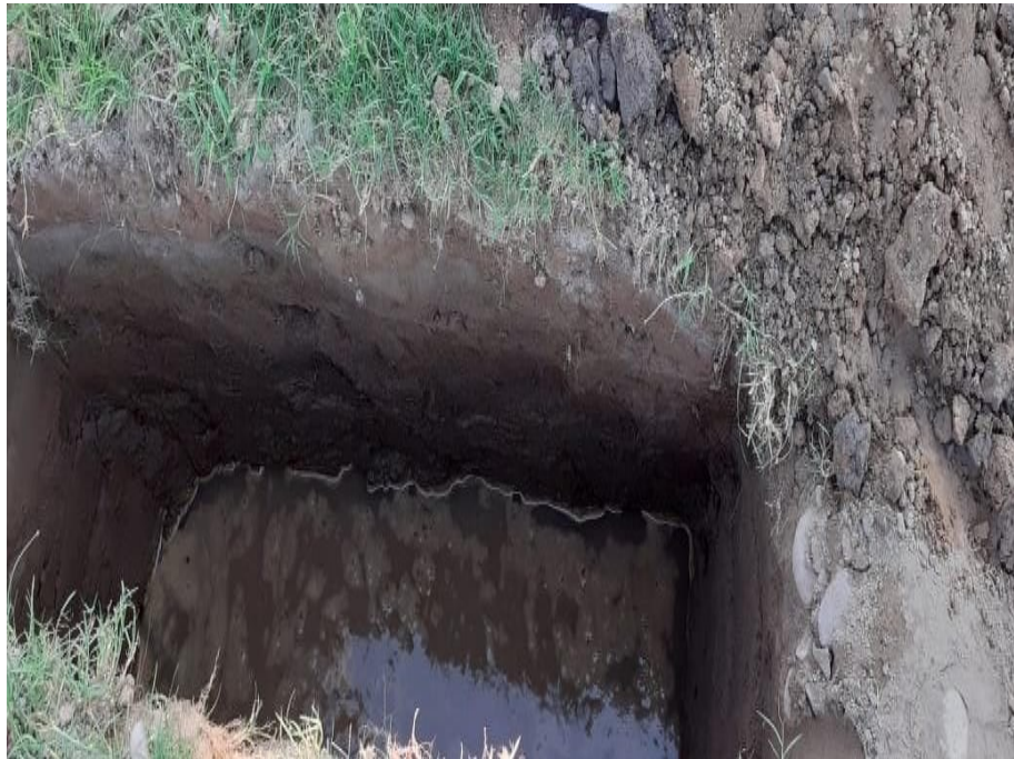
Foto : Se observa calicata excavada N° 04 (Progresiva: 0+100 - UTM WGS 84 / Zona 18S: E: 376176– N: 9048415) - Perfil del Suelo
