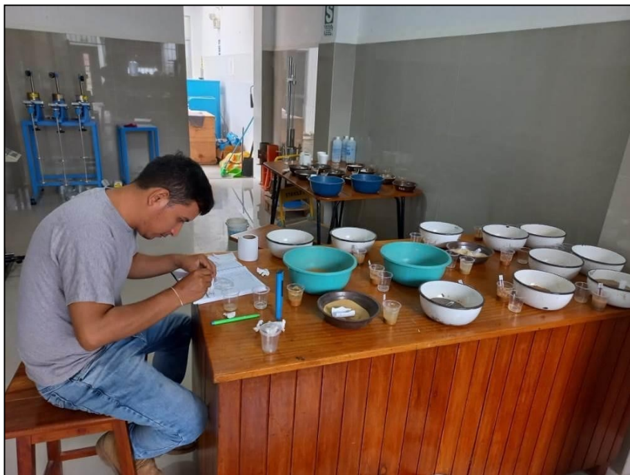
Se aprecia al personal técnico especializado realizando el Ensayo de Agresividad del Suelo (NTP: 339.152)
