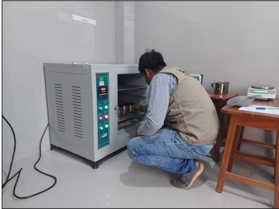
Se aprecia al personal técnico especializado realizando el Ensayo de Porcentaje de Humedad Natural (NTP: 339.127)
