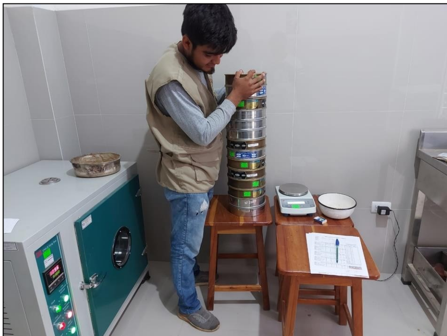
Se aprecia al personal técnico especializado realizando el Ensayo de Análisis Granulométrico por el Método de Tamizado (NTP: 339.128)
