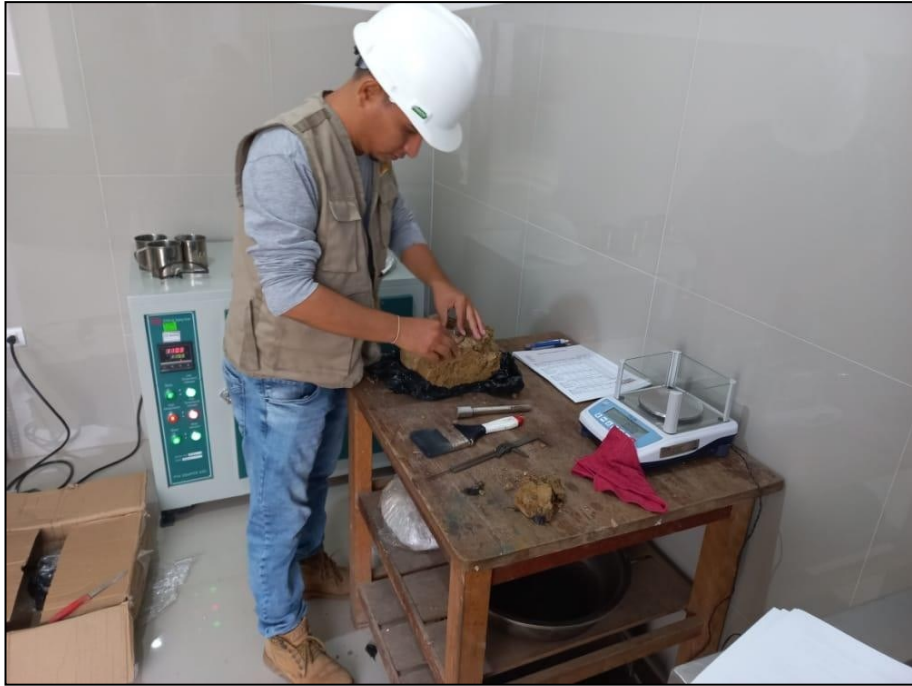
Se aprecia al personal técnico especializado realizando el Ensayo de Masa Volumétrica (NTP: 339.19)
