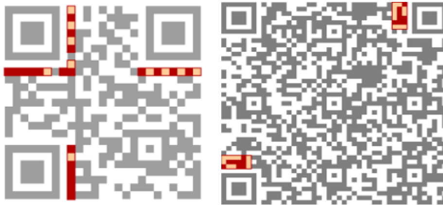
Figura 6: Datos y Nivel de Corrección de Errores / Versión
