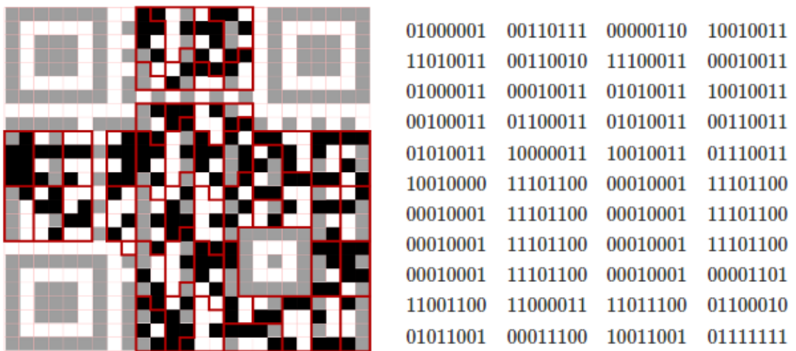
Figura 9: QR con sus bits marcados
