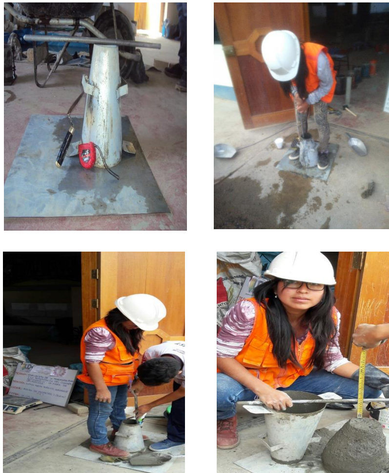
Gráfico 3.22 Realización del ensayo de asentamiento del concreto.
