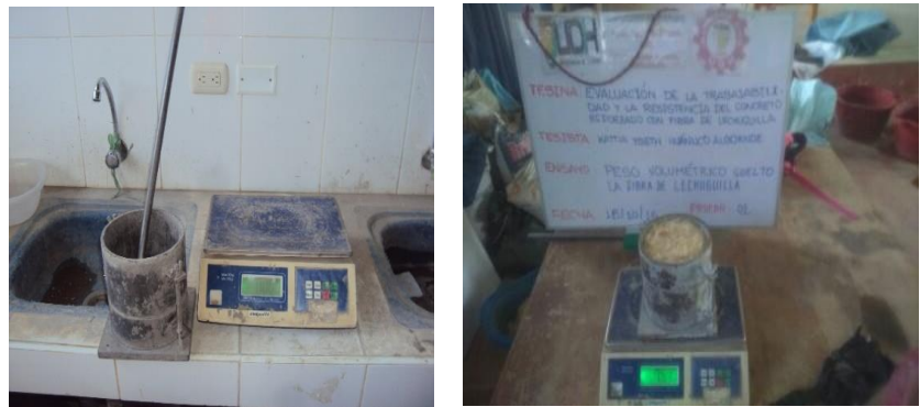
Gráfico 3.18 Ensayo del peso volumétrico suelto de la fibra de lechuguilla
