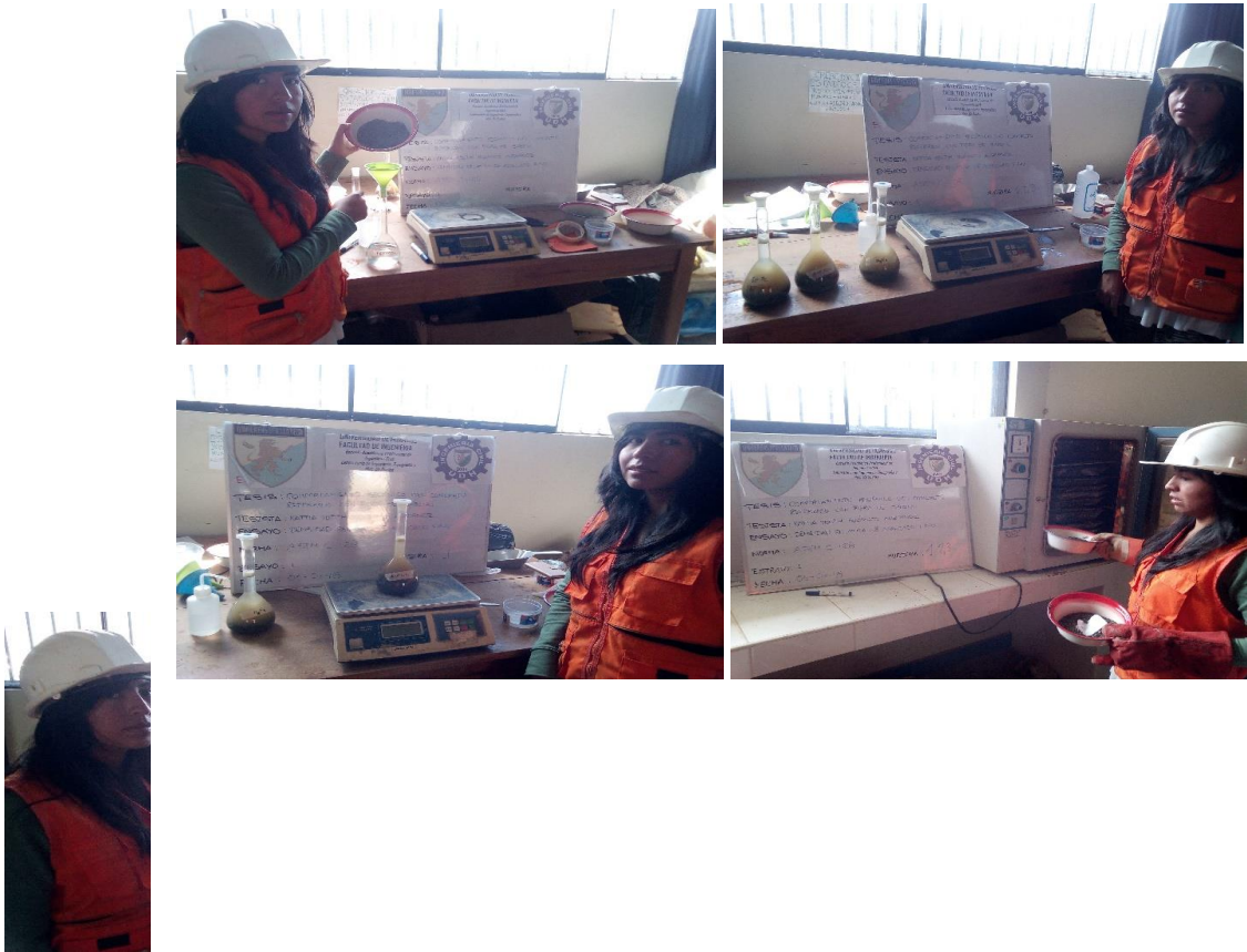
Gráfico 3.9 Ensayo del peso específico y absorción de la arena haciendo uso del picnómetro.
