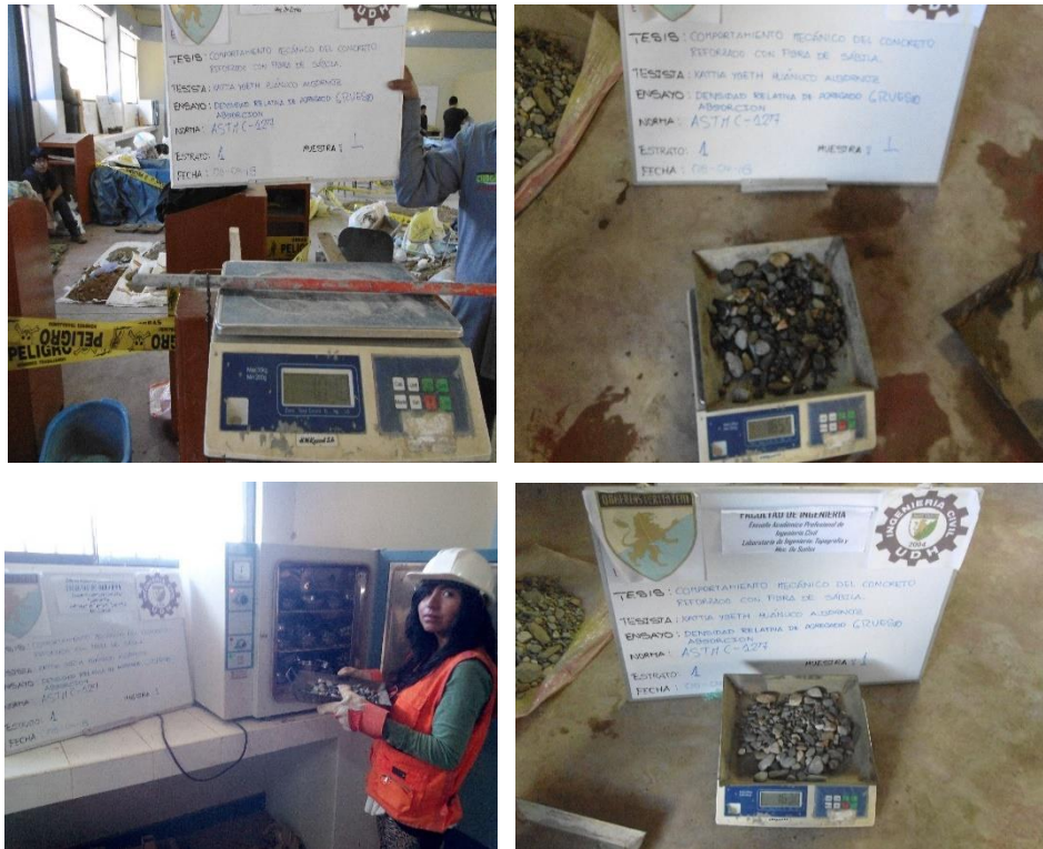
Gráfico 3.10 Ensayo del peso específico y absorción del agregado grueso haciendo uso de la canastilla.
