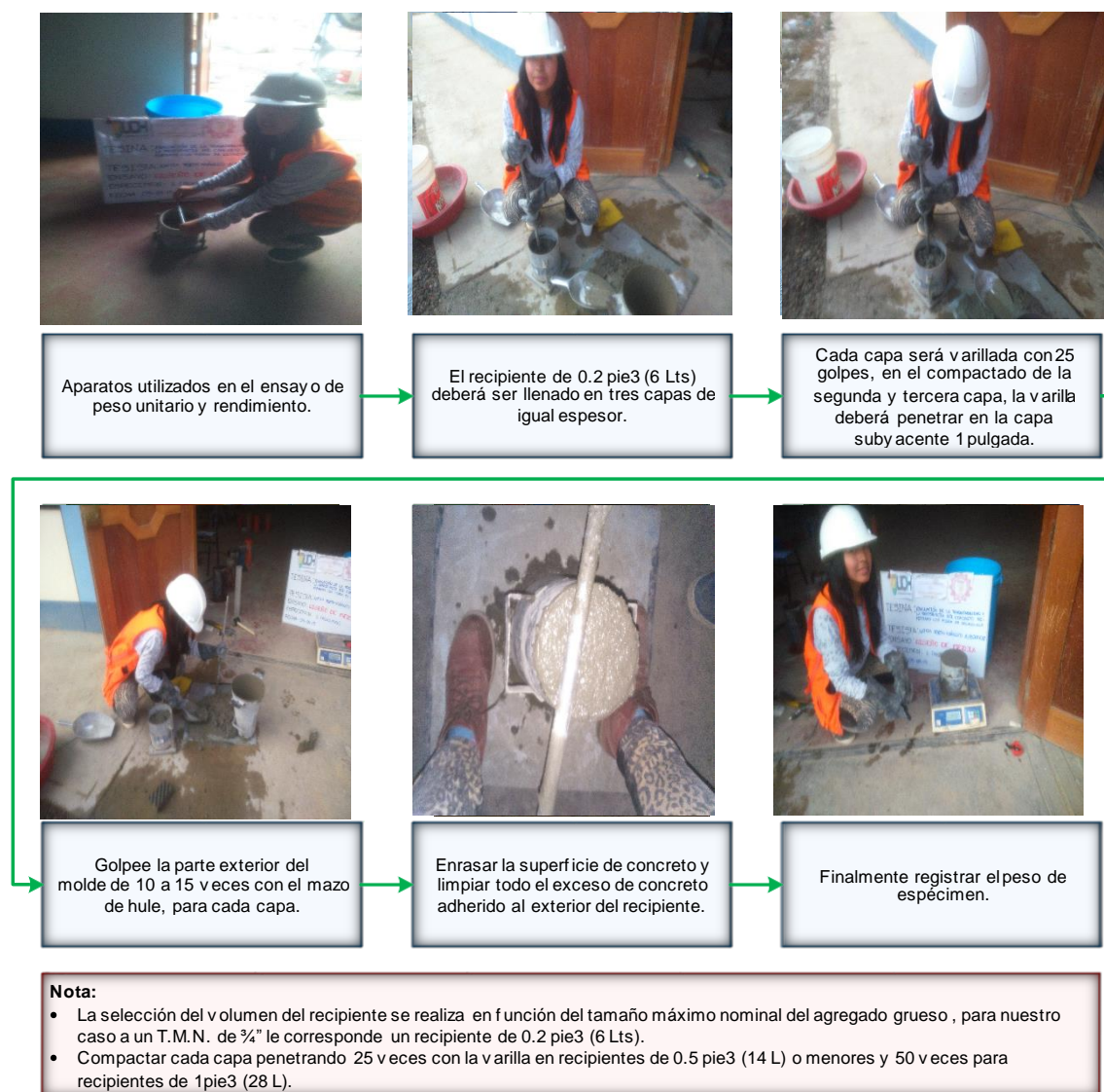
Figura 3.11 Secuencia de actividades para el ensayo de peso unitario y rendimiento del concreto.
