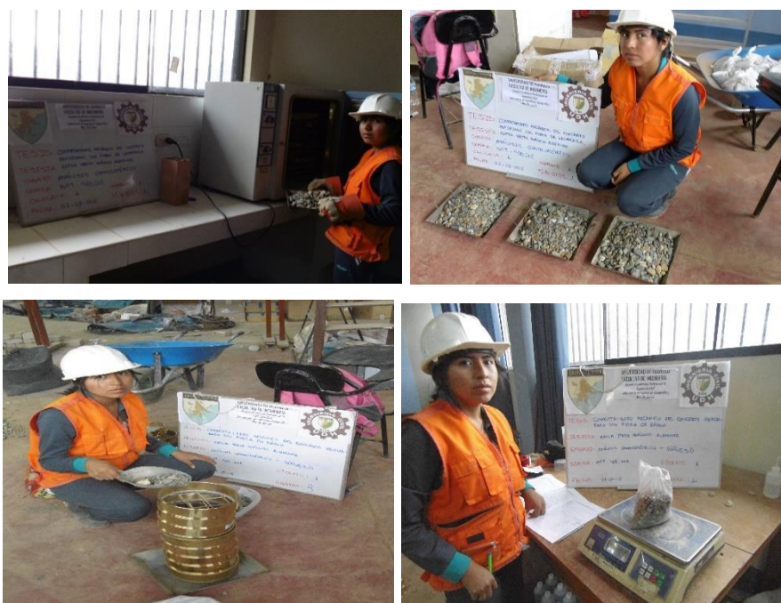
Gráfico 3.14 Ensayo granulométrico del agregado grueso
