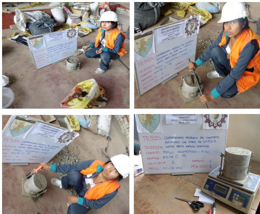
Gráfico 3.11 Ensayo del peso volumétrico suelto del agregado fino.
