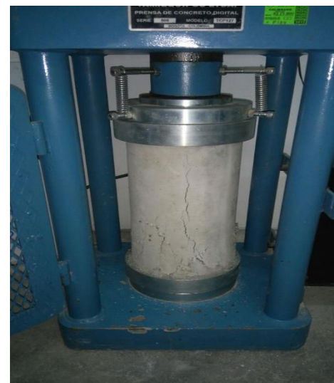
Gráfico 3.31 Ensayo de la resistencia del concreto de 210° reforzado con fibra de lechuguilla de la compresión de la edad de los 14 días.
