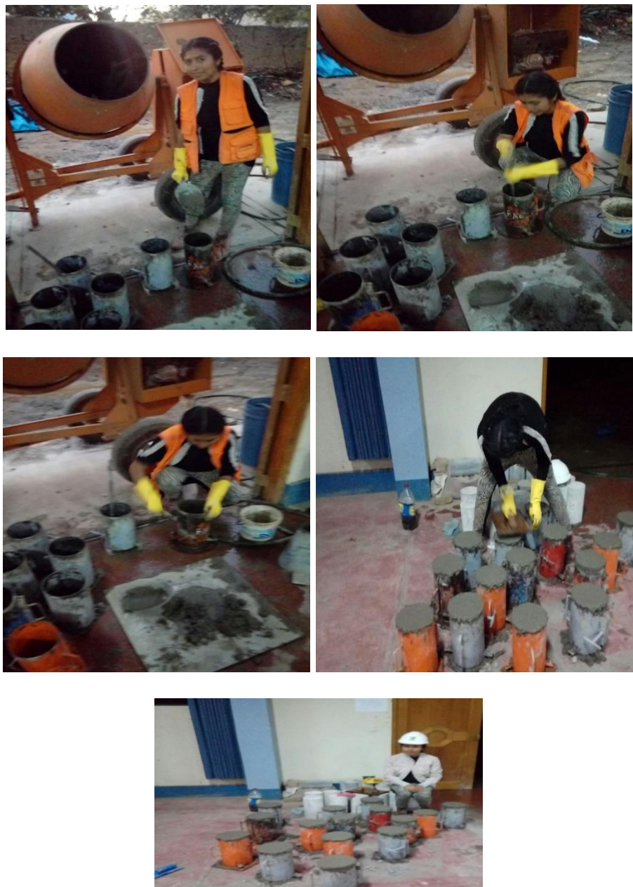
Gráfico 3.21 Elaboración de los especímenes (probetas) de concreto.
