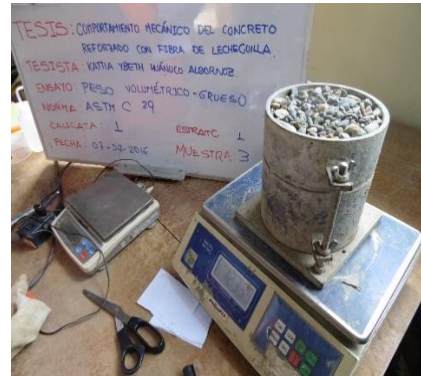
Gráfico 3.12 Ensayo del peso volumétrico suelto del agregado grueso.
