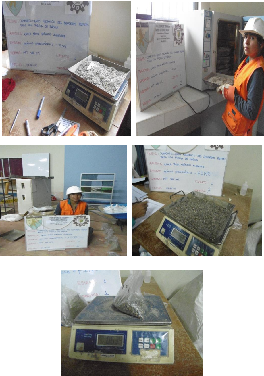
Gráfico 3.13 Ensayo granulométrico del agregado fino
