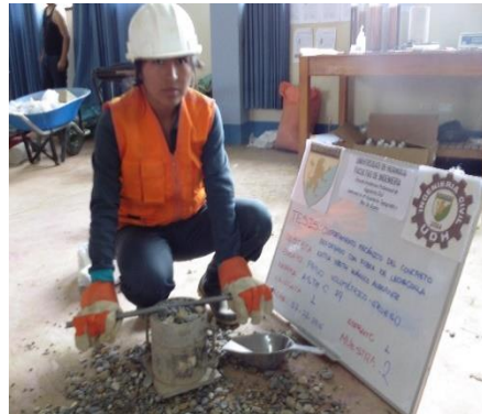
Gráfico 3.12 Ensayo del peso volumétrico suelto del agregado grueso.
