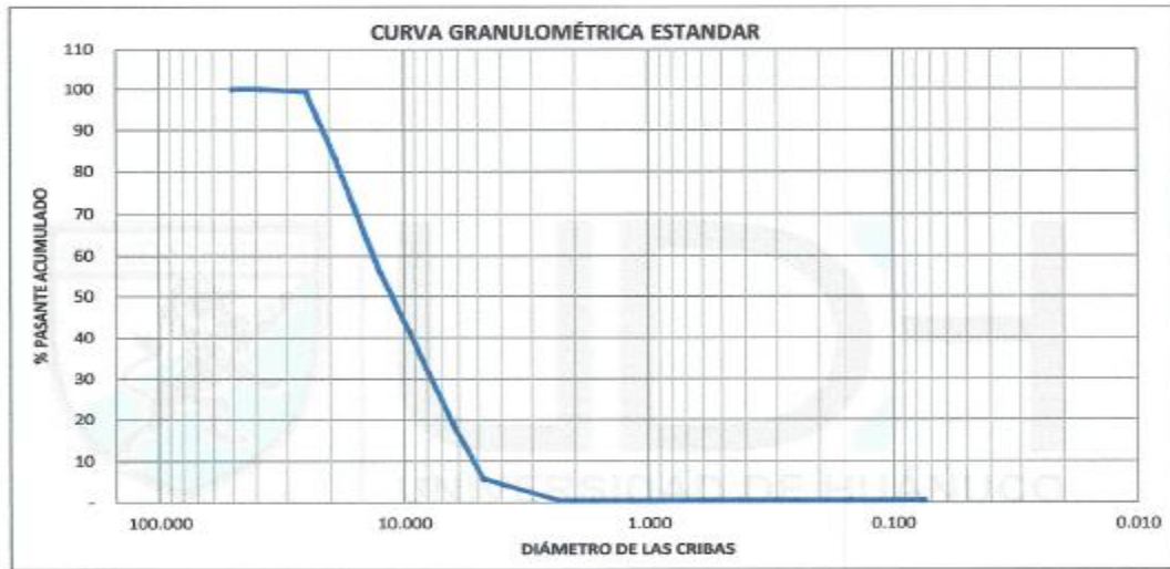
Figura 3.7 Curva granulométrica de la M-03 del agregado grueso
