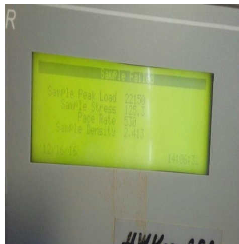
Gráfico 3.30 Ensayo de la resistencia del concreto de 210° reforzado con fibra de lechuguilla de la compresión de la edad de los 7 días
