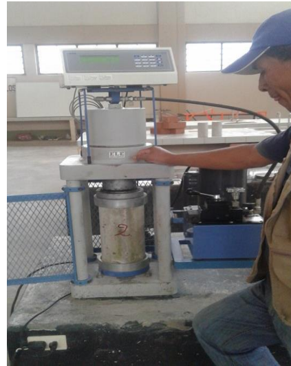
Gráfico 3.32 Ensayo de la resistencia del concreto de 210 o reforzado con fibra de lechuguilla de la compresión de la edad de los 28 días
