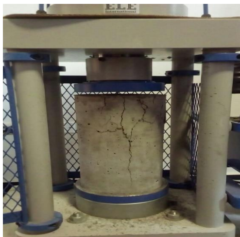
Gráfico 3.30 Ensayo de la resistencia del concreto de 210° reforzado con fibra de lechuguilla de la compresión de la edad de los 7 días
