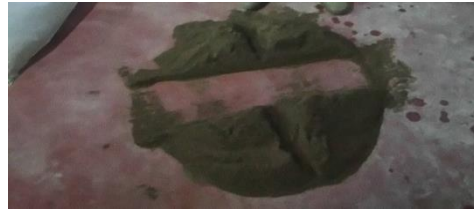
Gráfico 3.8 Reducción a tamaño de prueba del agregado fino, mediante cuarteo manual.
