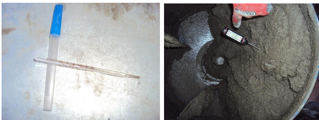
Gráfico 3 23 Realización del ensayo de temperatura del concreto.
