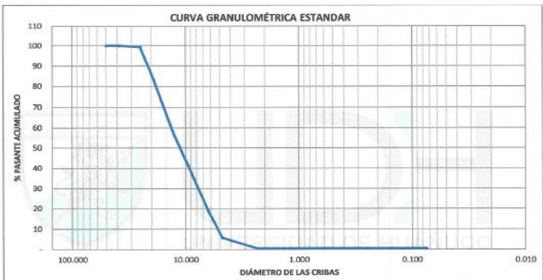
Figura 3.6 Curva granulométrica de la M -02 del agregado grueso
