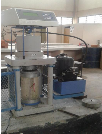
Gráfico 3.32 Ensayo de la resistencia del concreto de 210 o reforzado con fibra de lechuguilla de la compresión de la edad de los 28 días
