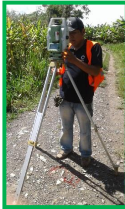
FOTO N°01: Se observa el estacionamiento de la estación total LEICA TS02, que será utilizado para el levantamiento topográfico del proyecto.
