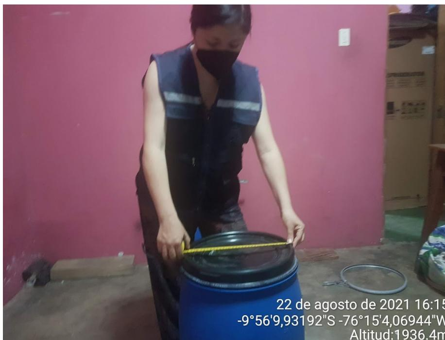
IMAGEN 04: MIDIENDO EL DIAMETRO PARA LAS PERFORACIONES
