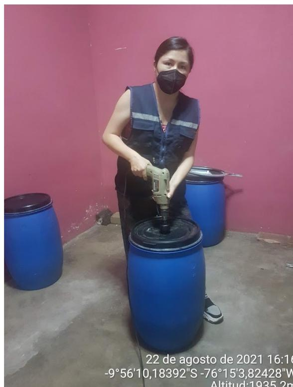
IMAGEN 05 y 06: REALIZANDO LAS PERFORACIONES DE LA PARTE SUPERIOR
