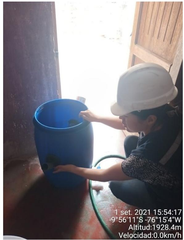
IMAGEN 13 y 14: REALIZANDO LA PRUEBA DE LA PERMEABILIDAD A LOS BIDONES.
