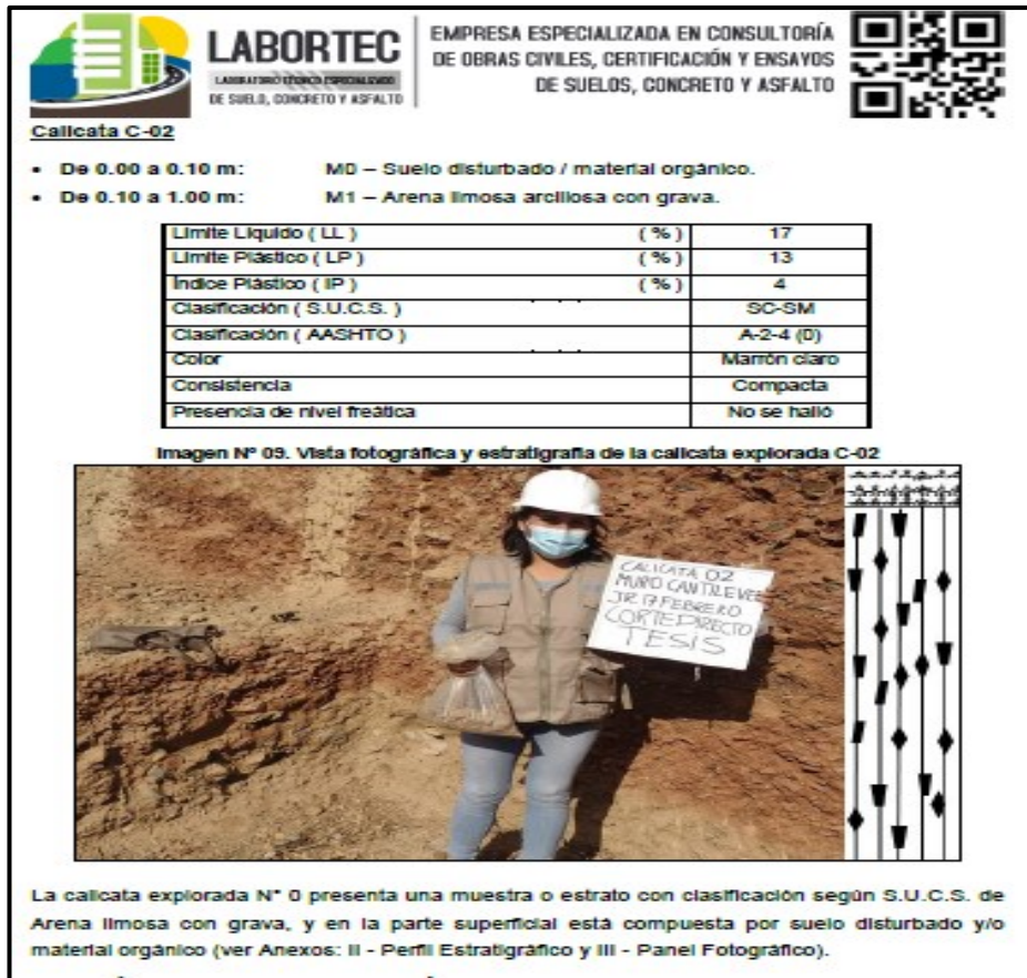
Figura 92 Caracterización de la calicata 02
