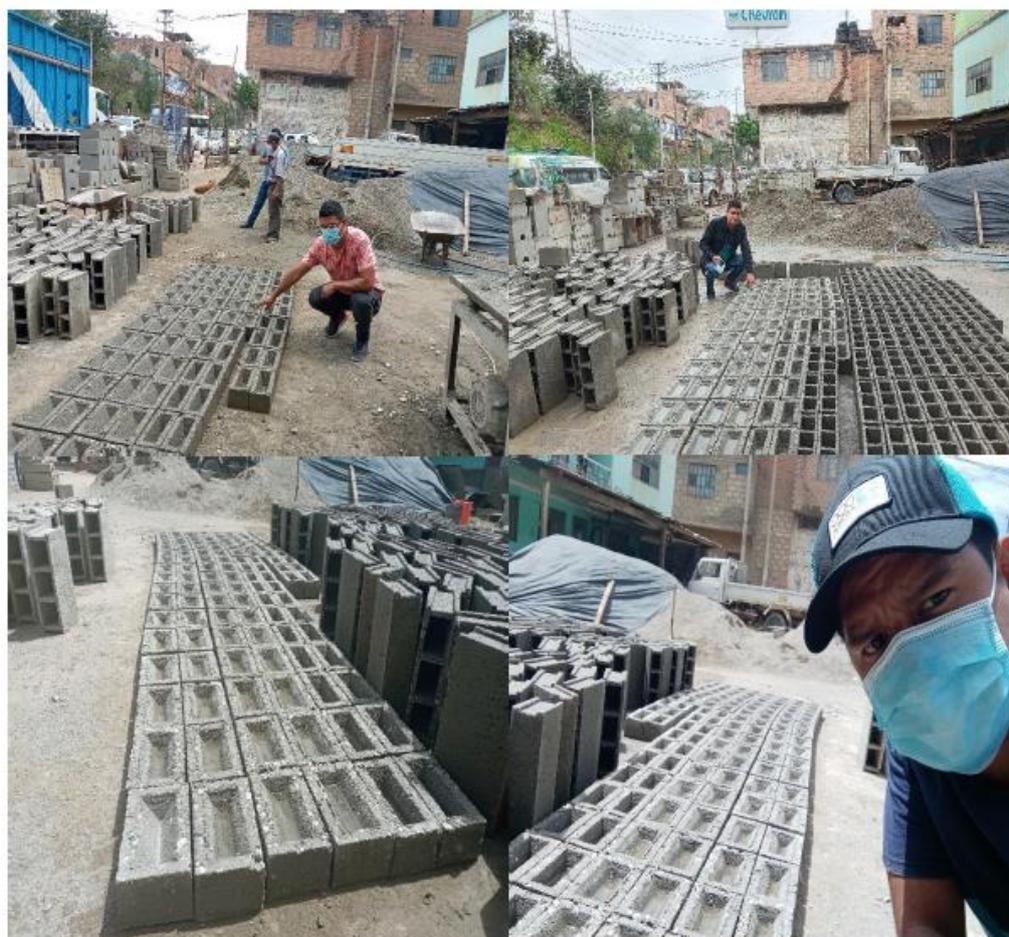
**Figura 20. Proceso de curado de los bloques de concreto**
