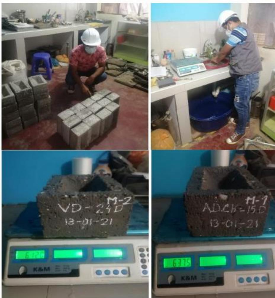
**Figura 24. Proceso de los ensayos de absorción, densidad y contenido de humedad.**
