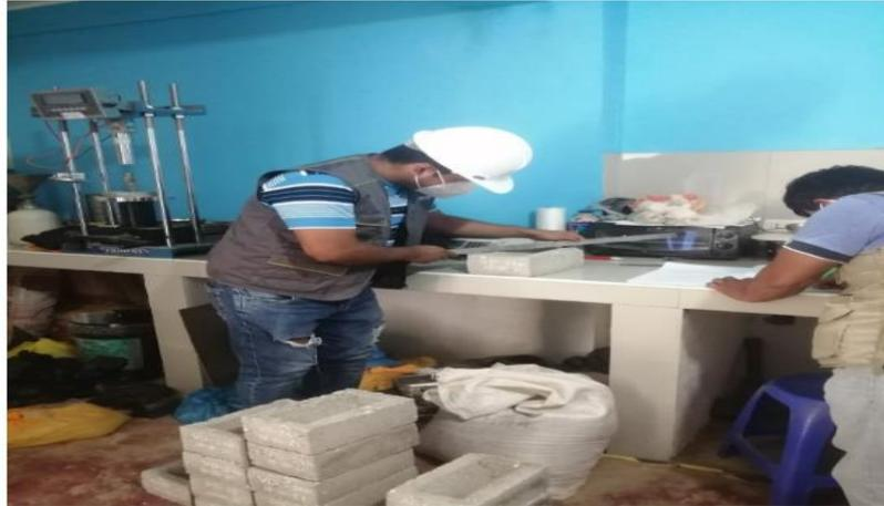
**Figura 21. Ensayo variación dimensional de las 10 unidades de albañilería.**
