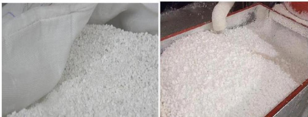
**Figura 12. Trituración del EPS en forma manual**
