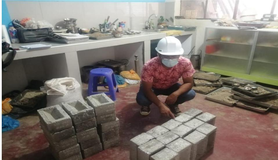
**Figura 23. Ensayo Resistencia a la compresión de las 60 unidades de albañilería.**
