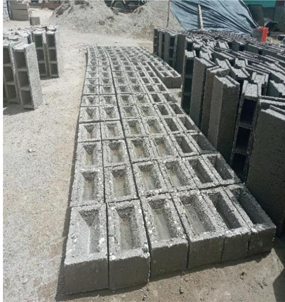
**Vista de las unidades de albañilería a partir del poliestireno expandido reciclado**
