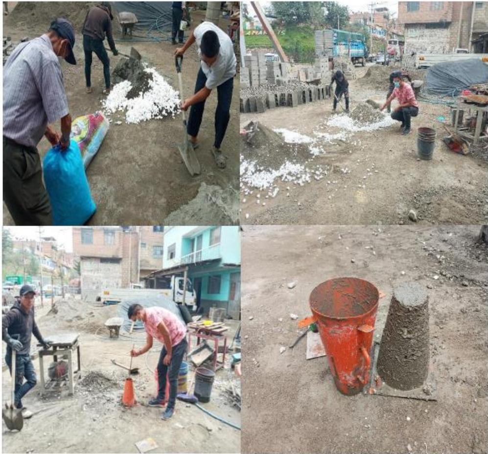
**Figura 18. Proceso de mezcla del material seleccionado utilizando el ensayo de Cono de Abrams.**
