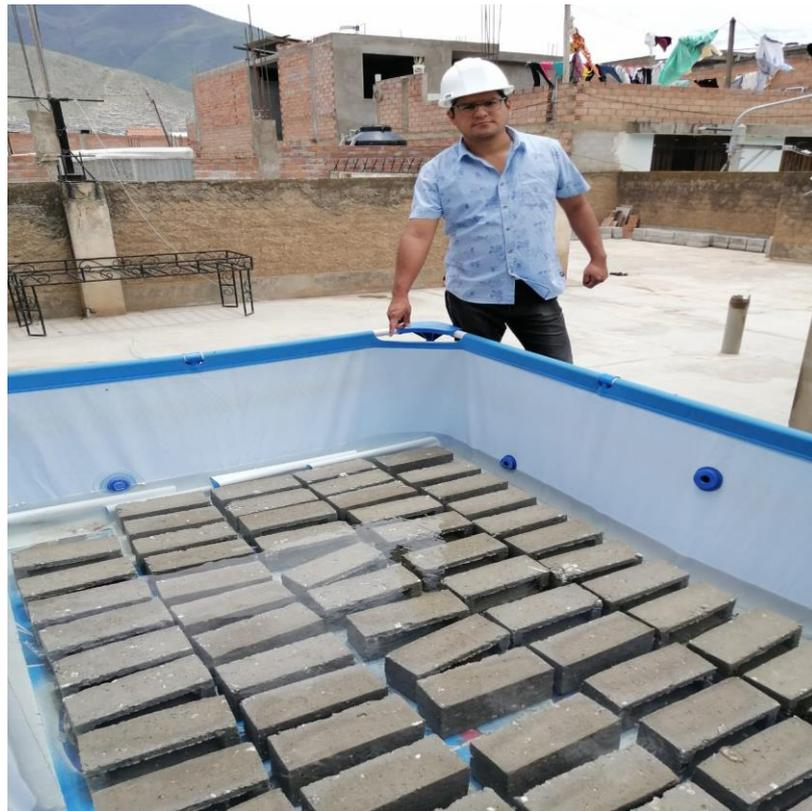
**Curado de los bloques de concreto para los ensayos correspondientes según la Norma Técnica Peruana.**
