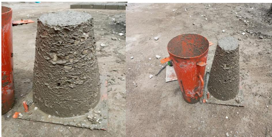
**Figura 25. Medición del asentamiento del concreto 1½", con consistencia seca.**
