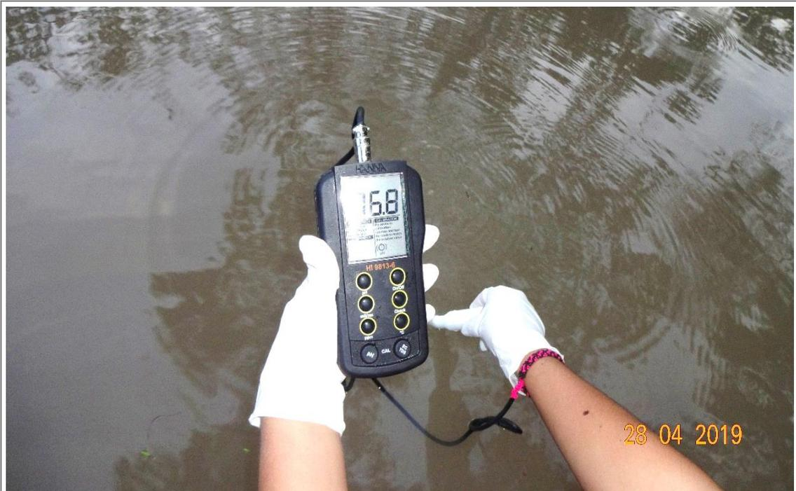
**Fotografía 7:** Medición de parámetros in situ (pH, temperatura y conductividad).
