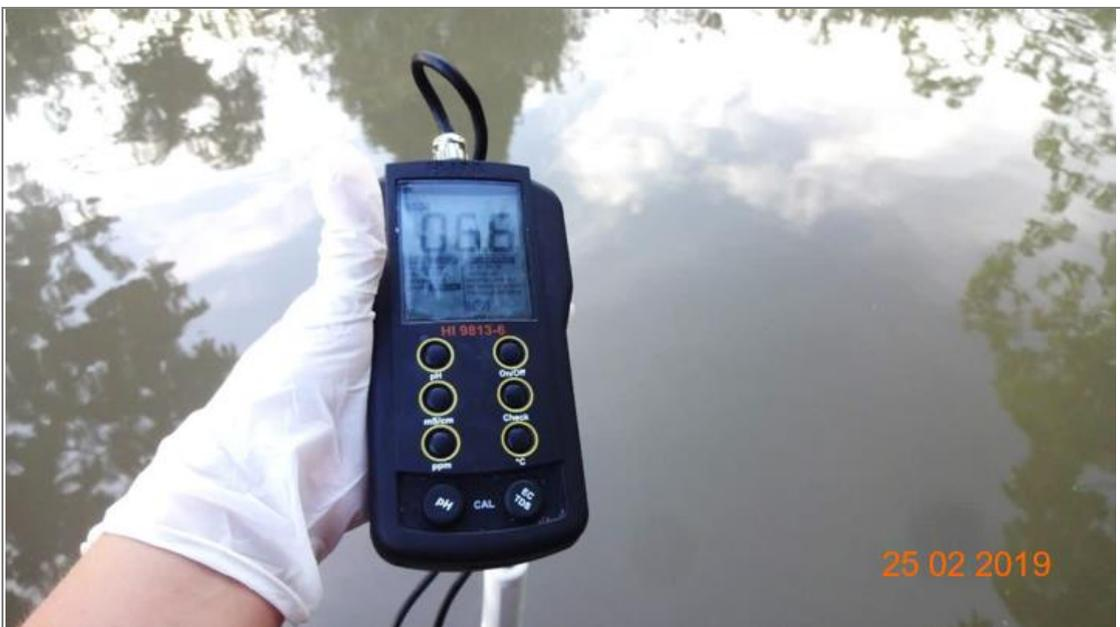
**Fotografía 2:** Se puede apreciar que con la ayuda de un multiparámetro, se está realizando la medición de parámetros in situ (pH, temperatura y conductividad).
