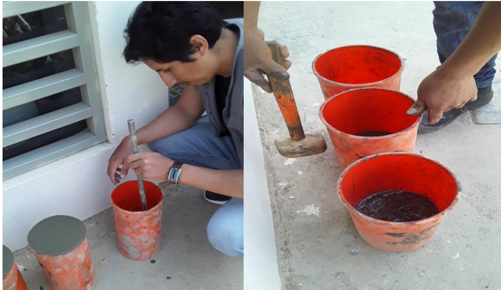
Figura 36: Golpes con la Varilla y el Mazo de Goma Para Eliminar Vacíos.
