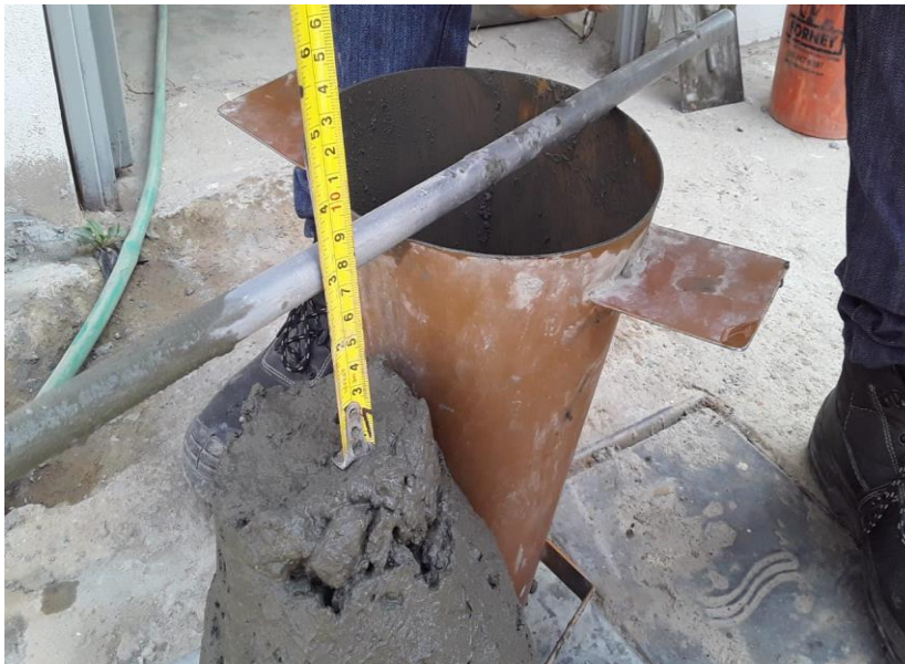
Figura 7: Diferencia de Alturas Entre el Molde y la Mezcla.
