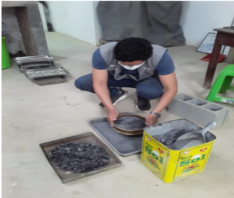
Figura 13: Tamizado de Ceniza de Cáscara de Café con la Malla N°100.
