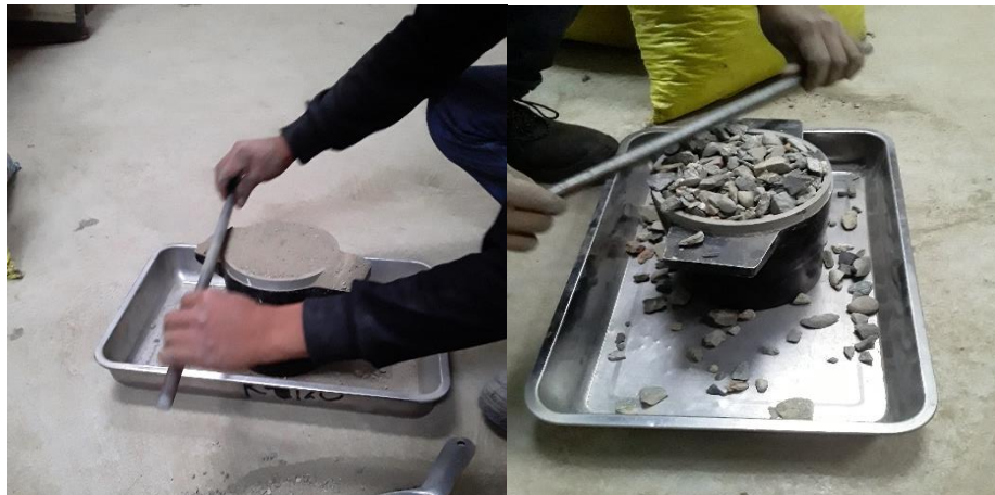
Figura 22: Peso Unitario Suelto del AF y AG.
