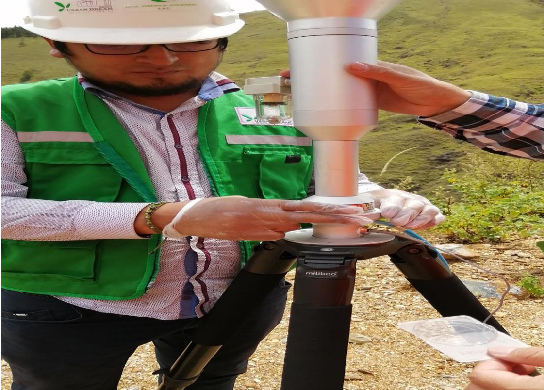
Fotografía 5: Instalación del filtro celulosa en el Muestreador de Bajo Volumen LOW-VOL PM10 marca Dual Samper.
