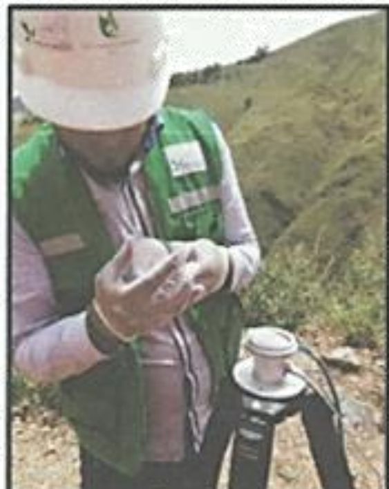
Imagen 04: Instalación filtro PM10 en el Low Vol
