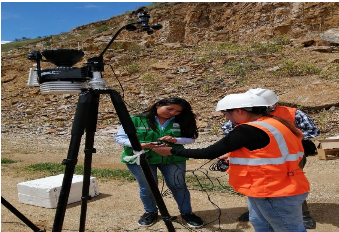
Fotografía 8: Instalación eléctrica de Estación Meteorológica portátil Digital, en el pasivo ambiental minero Quisqui junto al equipo técnico de Grupo Urban Dream Ingeniería y Arquitectura Sostenible S.A.C y el Ing. Marco Antonio Torres Marquina.
