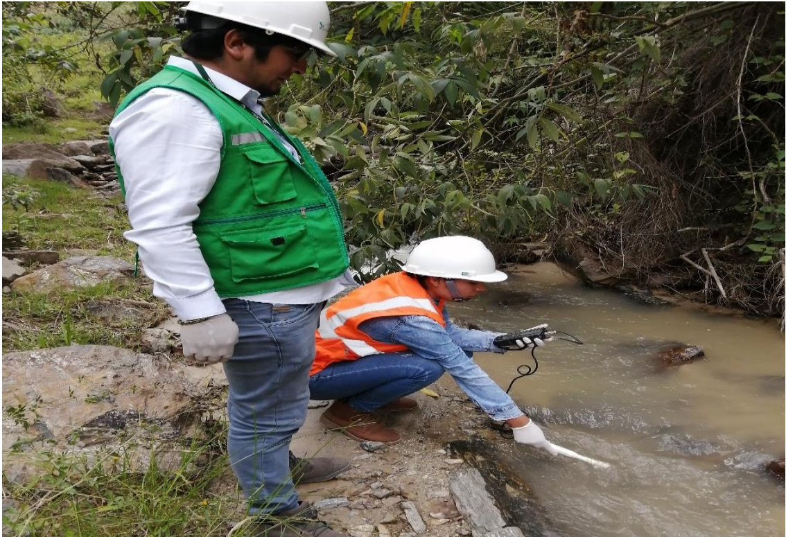
Fotografía 23: Toma de datos de los parámetros in situ de agua, supervisado por el equipo técnico Grupo Urban Dream Ingeniería y Arquitectura Sostenible S.A.C.
