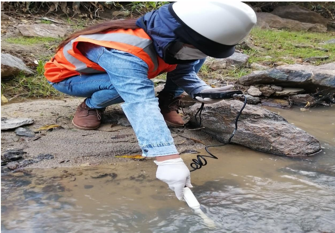
Fotografía 24: Toma de datos de los parámetros de agua in situ con el multiparametro Hanna.
