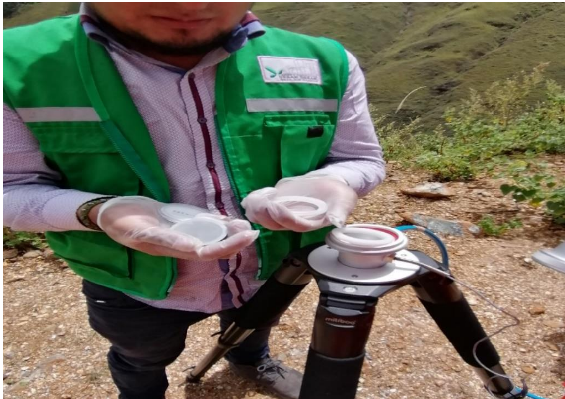
Fotografía 4: Colocación del filtro celulosa en el Muestreador de Bajo Volumen LOW-VOL PM10 marca Dual Samper.
