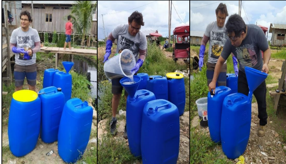
Figura 33. Recolección de las aguas residuales negras en bullones para el trabajo experimental.
