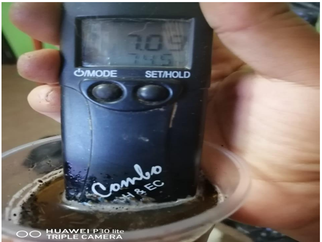
Fotografía 22: Medición de pH de la ruma.
