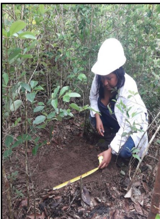
Limpieza y medidas del área para las calicatas.
