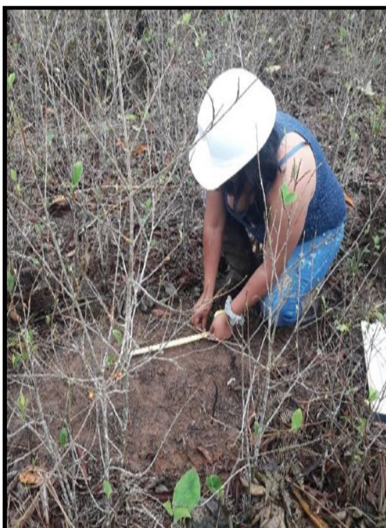
Limpieza y medidas del área para las calicatas.
