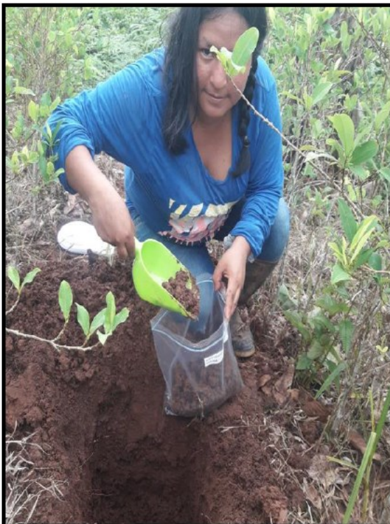
Toma de muestras (etiquetado y embolsado de muestras).
