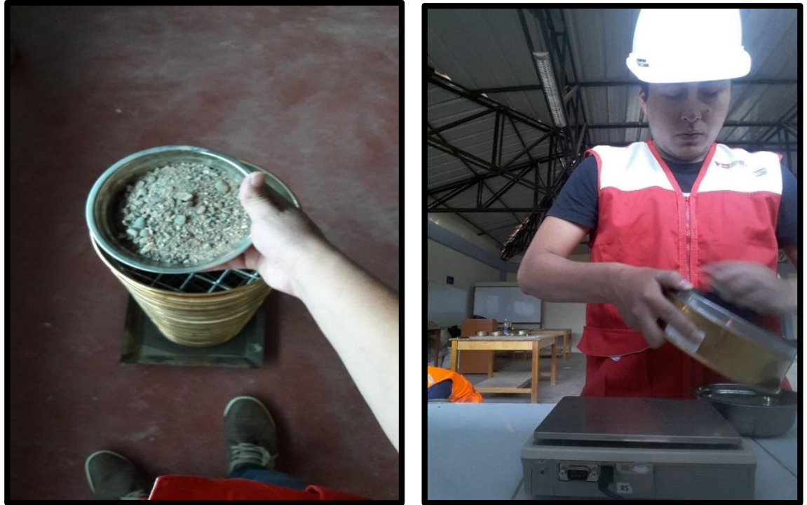
Fotografía 5: Ensayo de Granulometría mediante los tamices Estandarizados, ASTM D-422 (Fuente: Propia).
