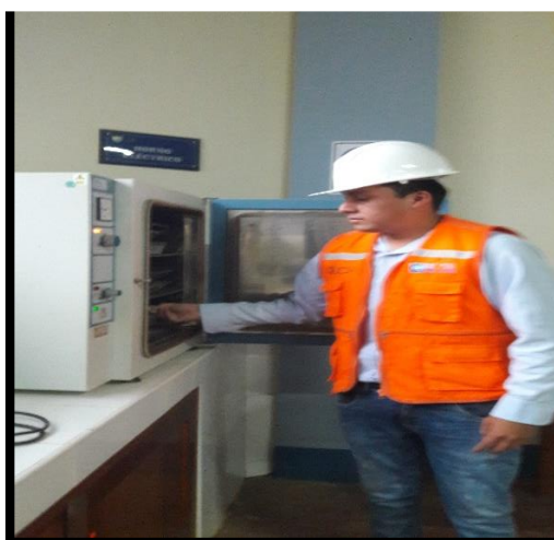
Fotografía 2: Secado al horno de la muestra con temperatura controlada.
