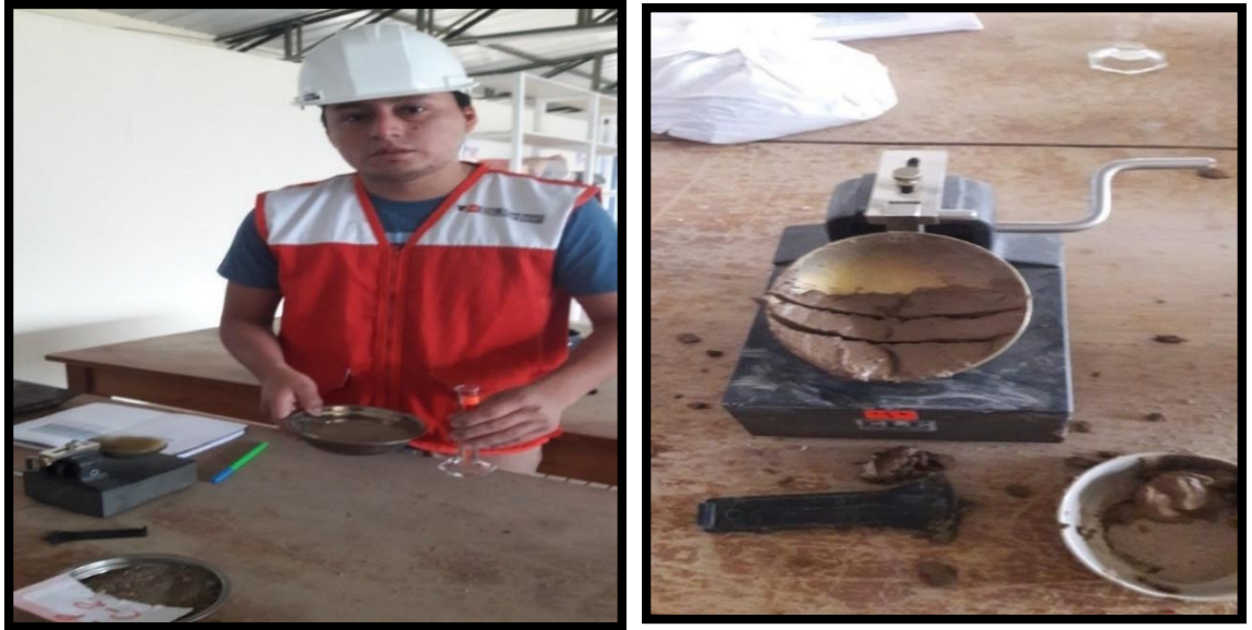
Fotografía 10: Procedimiento del ensayo de plasticidad (copa Casagrande).
