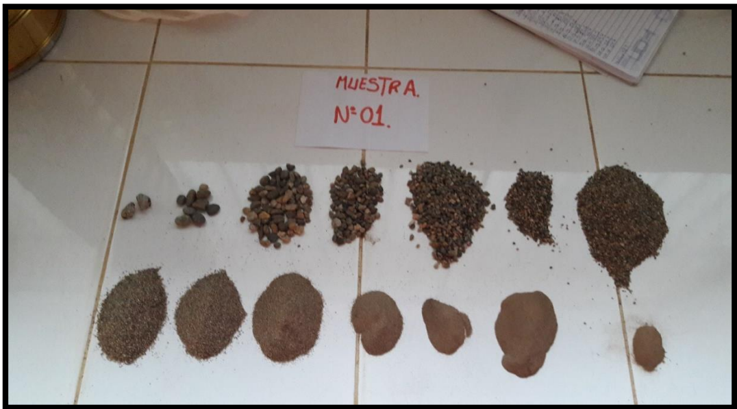
fotografía 6: Clasificación de la muestra por el Análisis Granulométrico C-1.
