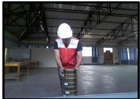
Fotografía 4: realización del análisis granulométrico por tamizado. ASTM D-422, AASHTO T88.
