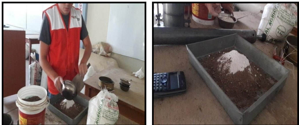
Fotografía 14: Porcentajes de óxido de Calcio respecto al peso de las muestras y mezclado.
