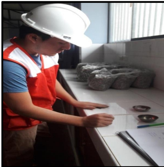
Fotografía 11:Rodamiento de material para efectuar el límite plástico.
