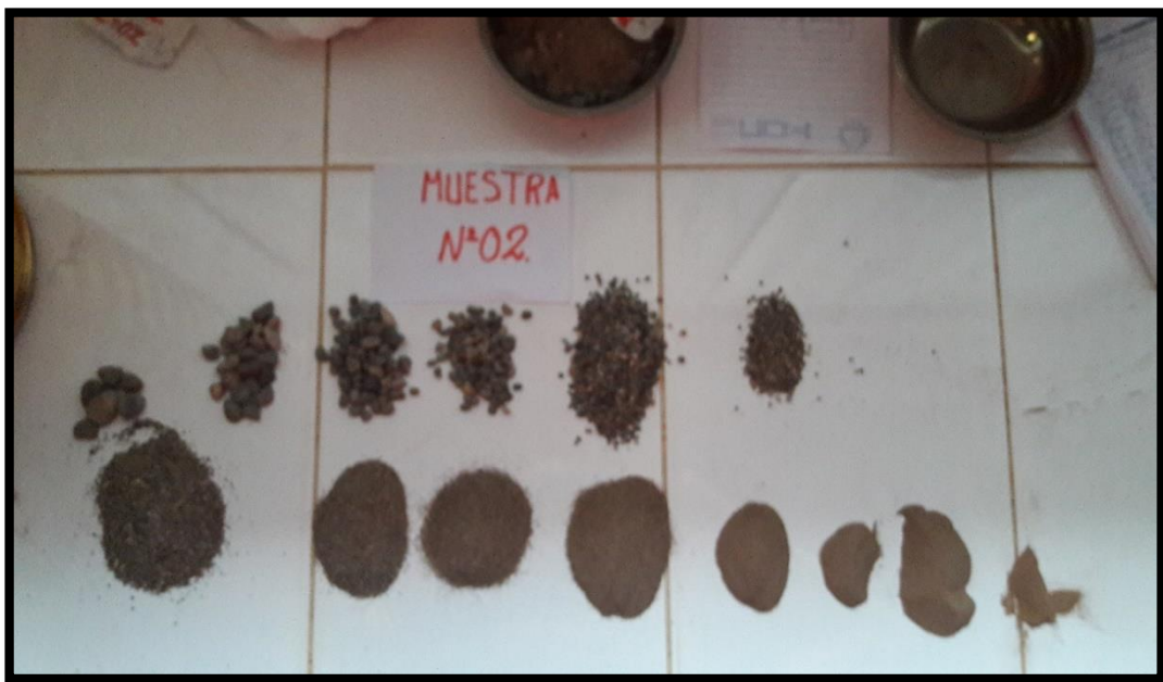
Fotografía 6:Clasificación de la muestra por el Análisis Granulométrico C-2.
