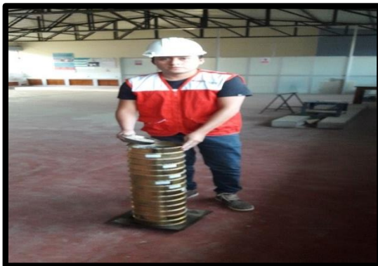
Fotografía 4: realización del análisis granulométrico por tamizado. ASTM D-422, AASHTO T88.
