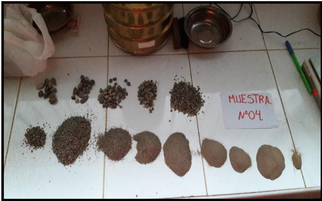
Figura 7: Clasificación de la muestra por el Análisis Granulométrico C-4.
