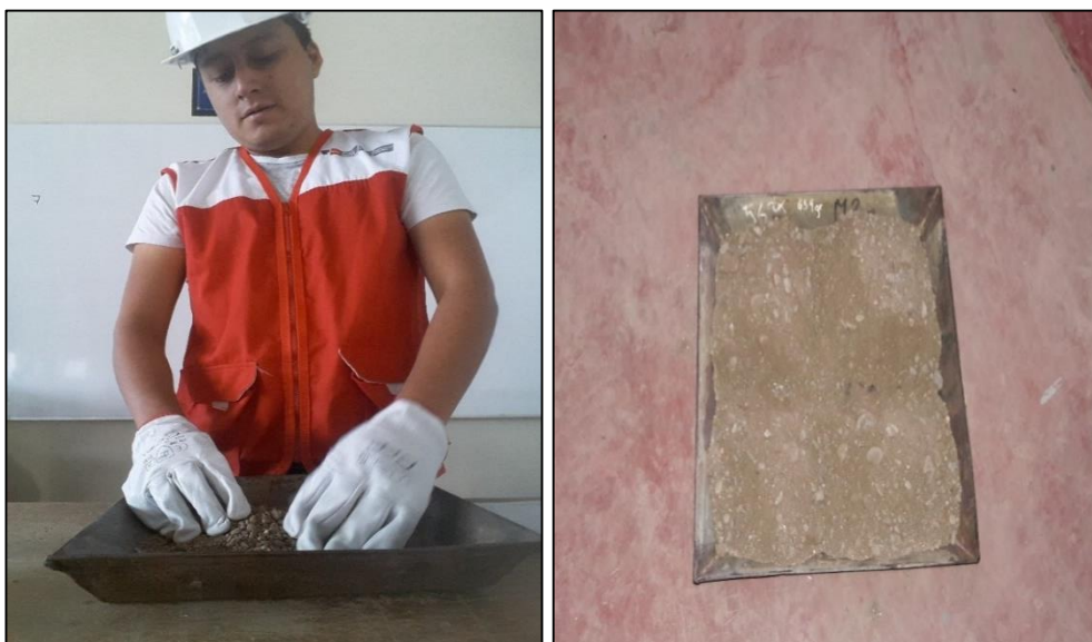
Fotografía 1:Cuarteo de la muestra representativa.
