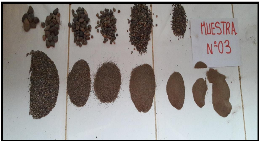
Fotografía 7: Clasificación de la muestra por el Análisis Granulométrico C-3.
