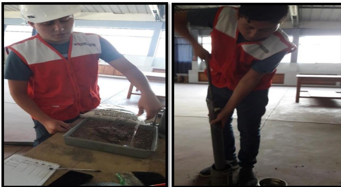
Fotografía 12: Compactación del espécimen con el pistón y el Molde.
