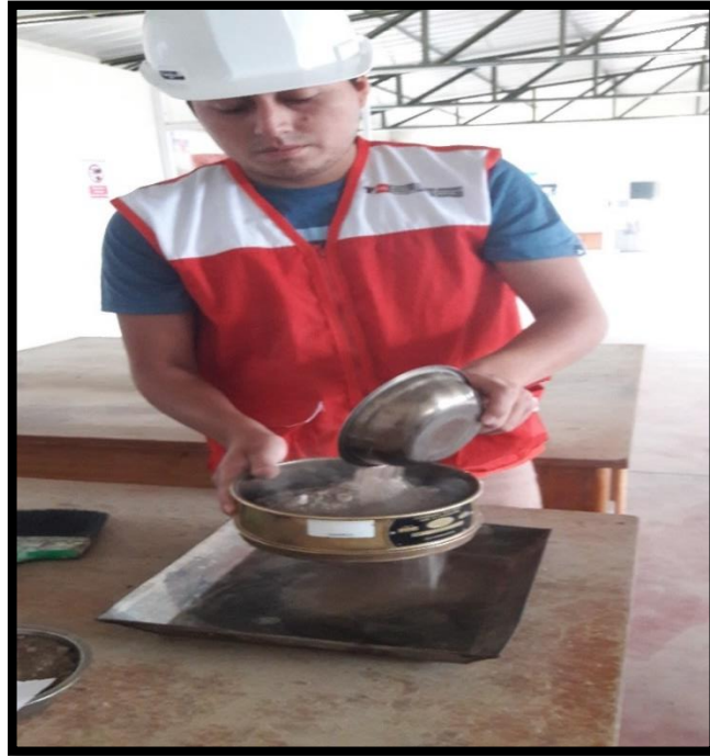
Fotografía 9: Tamizado de material por tamiz N°40.
