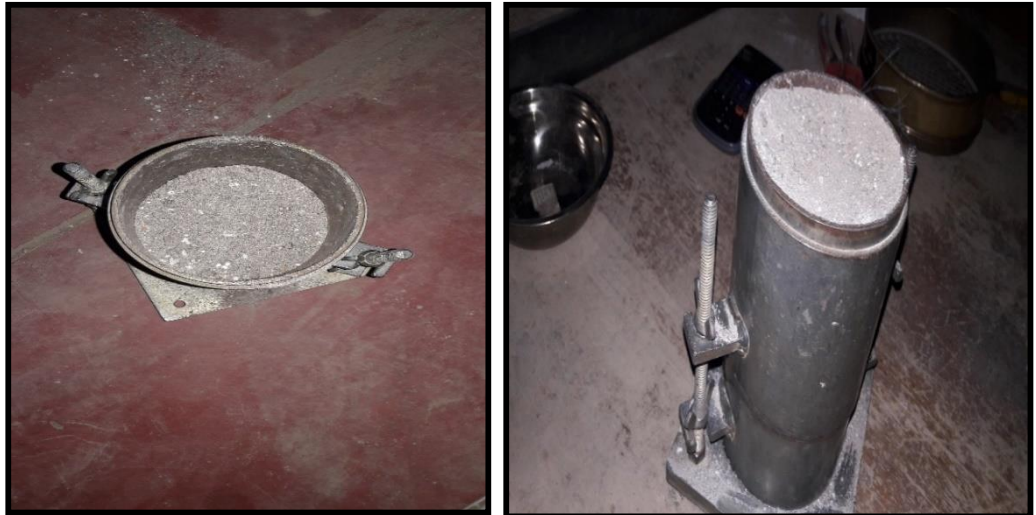
Fotografía 15: Suelos estabilizado con óxido de calcio, sometido al ensayo de Valor Soporte California.
