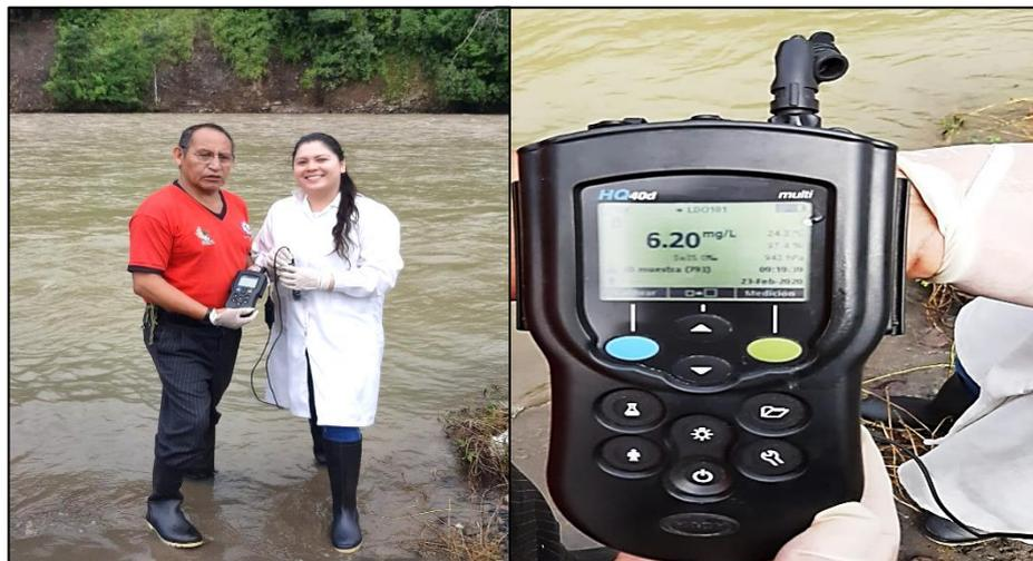
**Figura 18.** Medición del oxígeno disuelto
