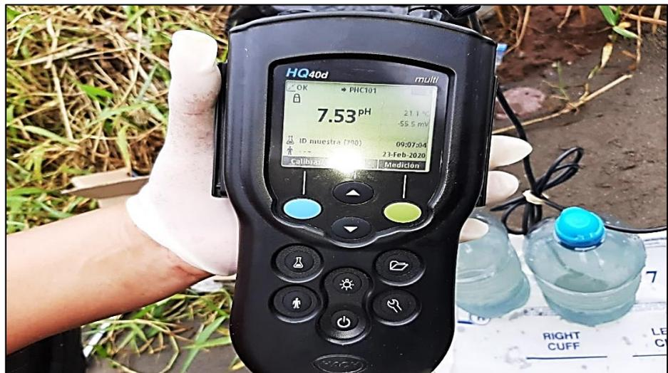
**Figura 16.** Medición de pH
