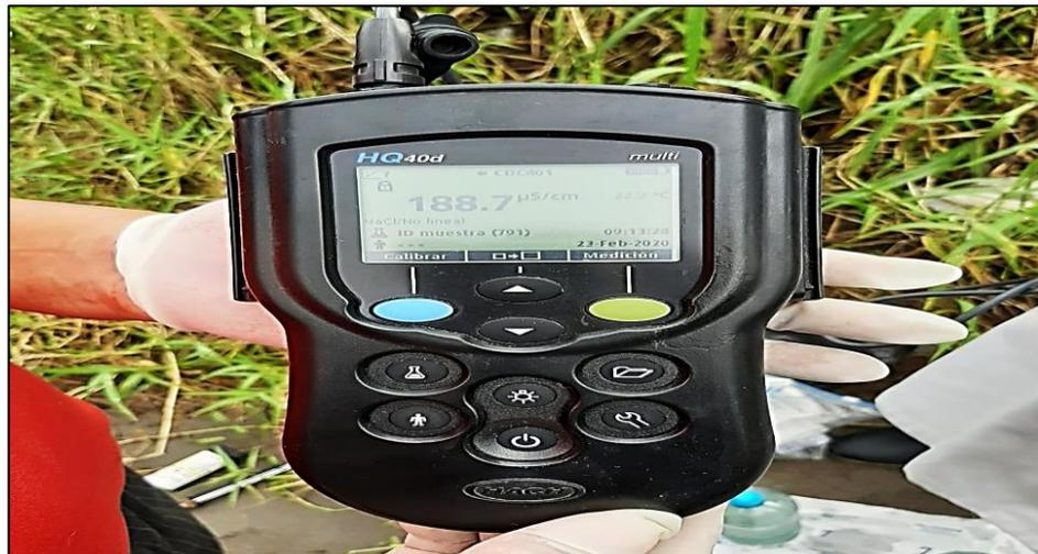
**Figura 17.** Medición de la conductividad
