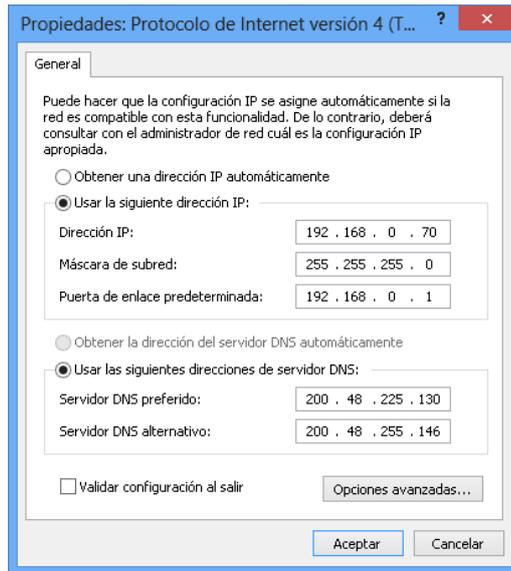
2. Nos conectamos al panel de configuración inicial del router usando el navegador chrome con la dirección 192.168.0.1 (el cable azul que va al puerto wan o internet del router debe estar desconectado).
