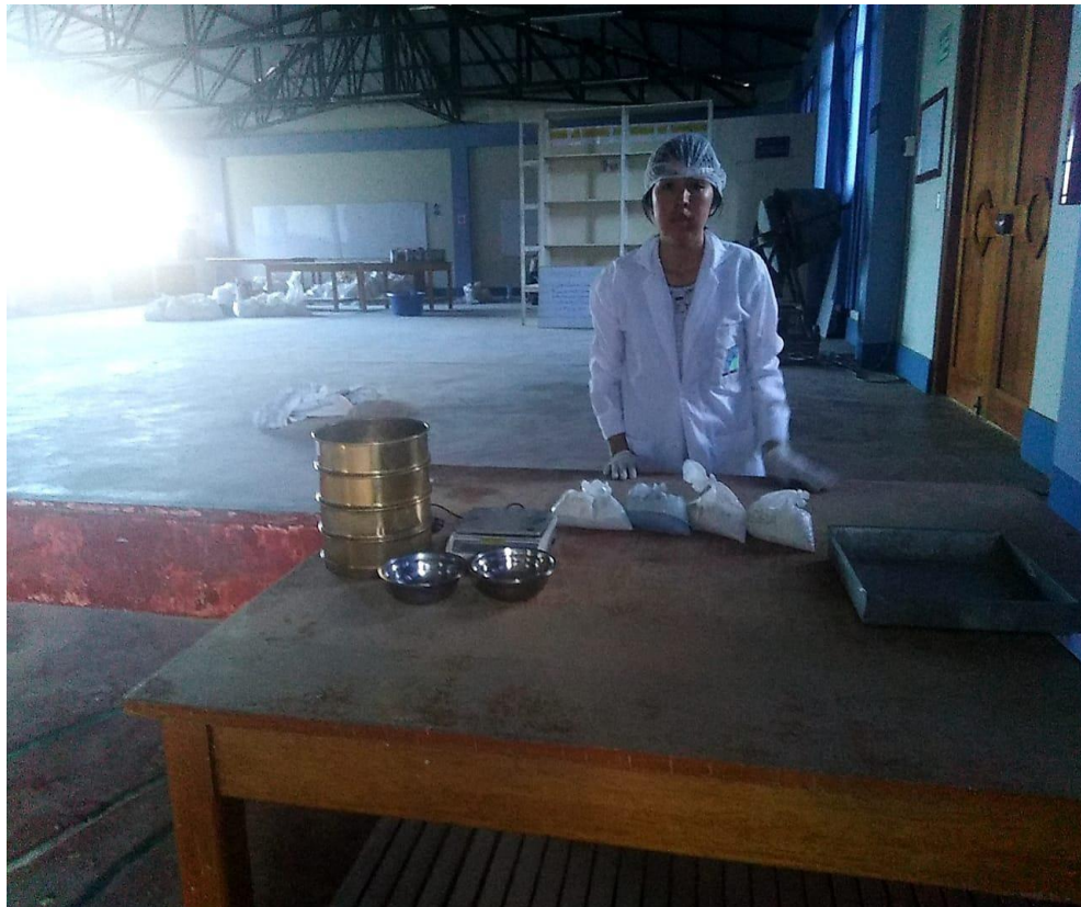
Imagen 1: Previa del proceso del tamizado, en el laboratorio de suelos de la UDH
