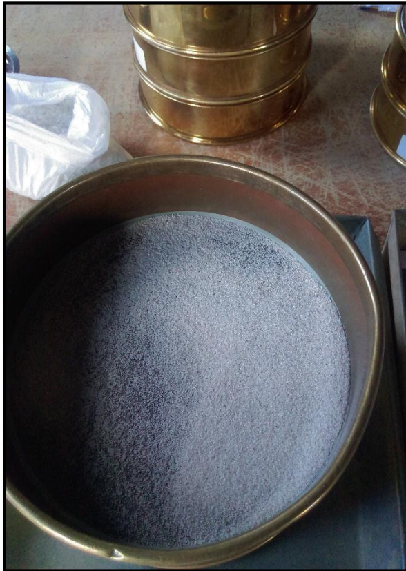
Imagen 6: Los 100gr de Arena fina puesto sobre los Tamices
