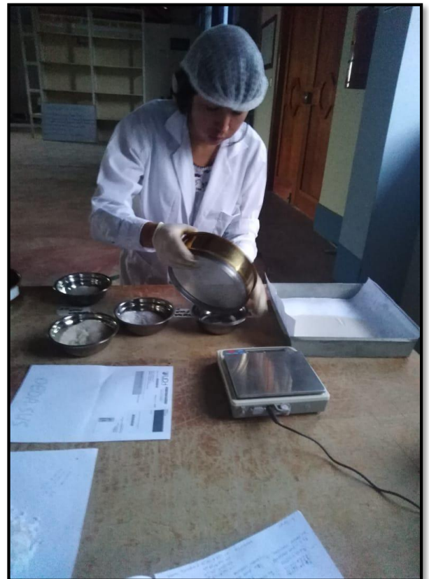
Imagen 7: Gramos de arena que quedo retenido en el primer tamiz
