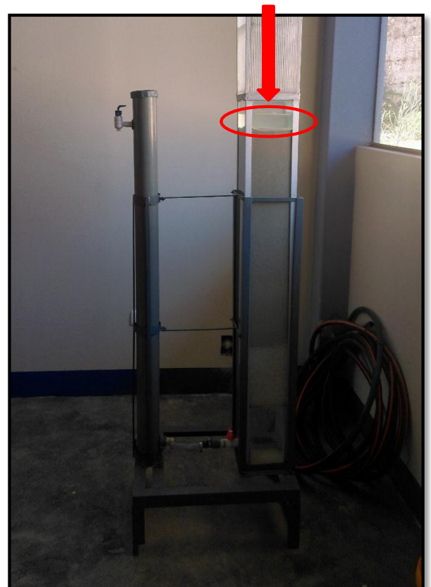
Imagen 11: 5cm de cabeza de agua sobre el lecho filtrante.
