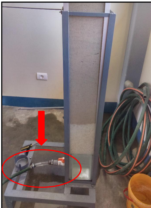
Imagen 10: Llenado de agua en el filtro, de manera ascendente
