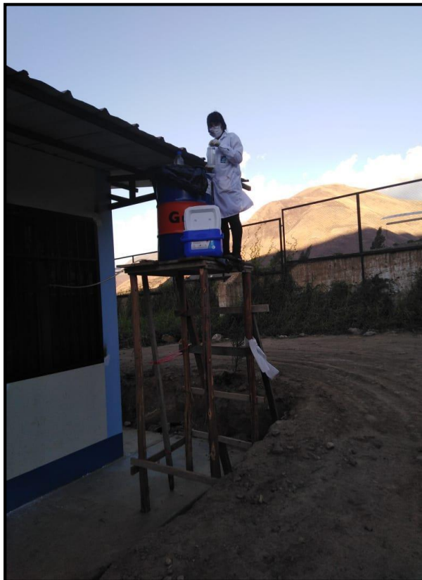
Imagen 14: Sacado de muestras de entrada al filtro, que serán analizadas en el laboratorio de Biotecnología.
