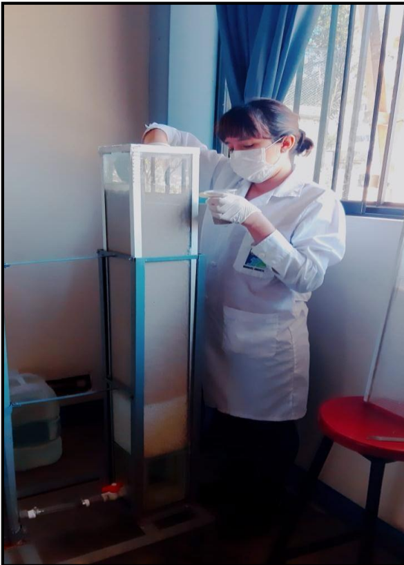
Imagen 19: Raspado de la biomasa, encontrándose a una altura de 2cm.
