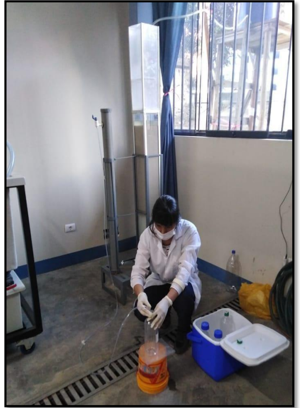
Imagen 15: Sacado de muestras en la salida del filtro, lo cual serán analizadas en el laboratorio de Biotecnología.
