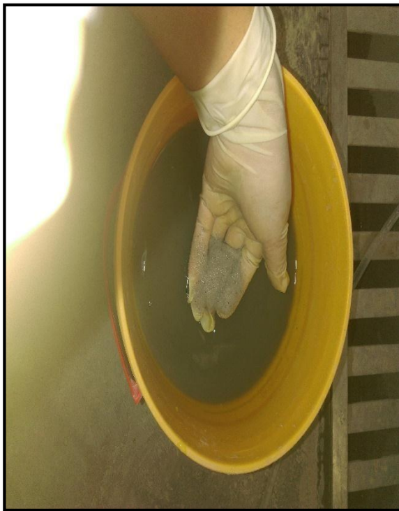
Imagen 20: Lavado del medio filtrante con el agua filtrada que se obtuvo en el ensayo.
