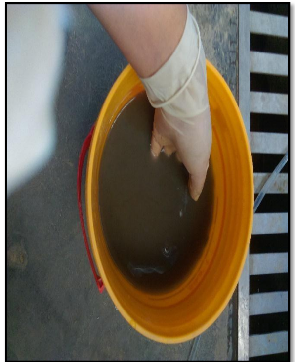
Imagen 20: Lavado del medio filtrante con el agua filtrada que se obtuvo en el ensayo.
