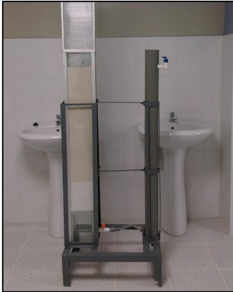
Imagen 9: Proceso de filtración acoplado con el proceso de almacenamiento para agua filtrada
