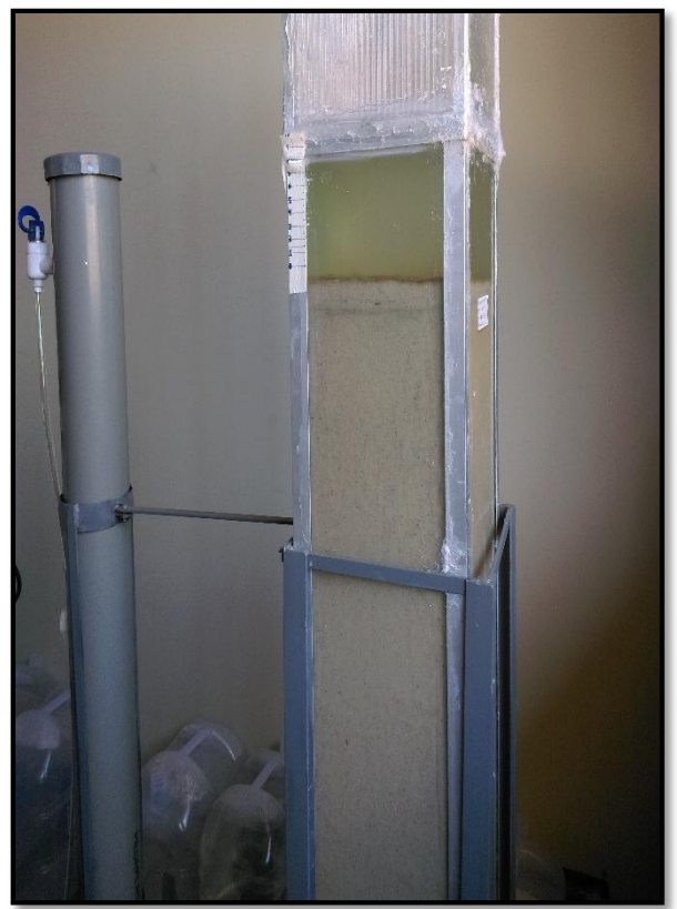
Imagen 17: Inicios de saturación del medio filtrante.
