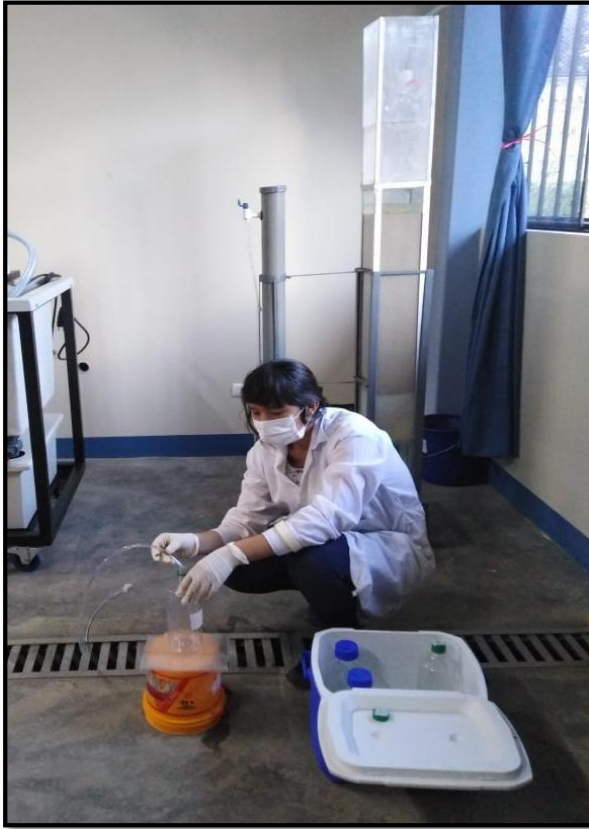
Imagen 15: Sacado de muestras en la salida del filtro, lo cual serán analizadas en el laboratorio de Biotecnología.
