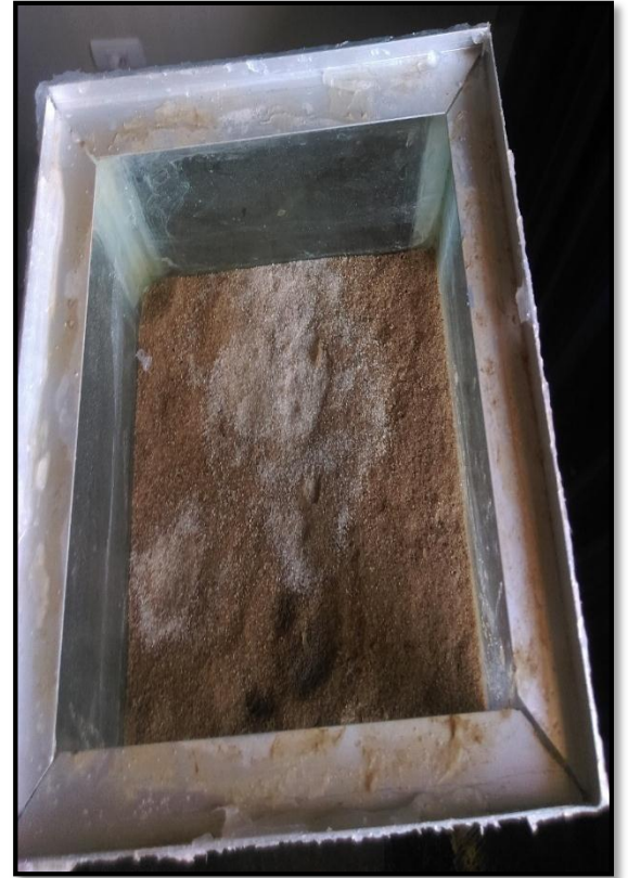
Imagen 18: Medio filtrante saturado, lo cual se requiere una limpieza y mantenimiento del filtro.
