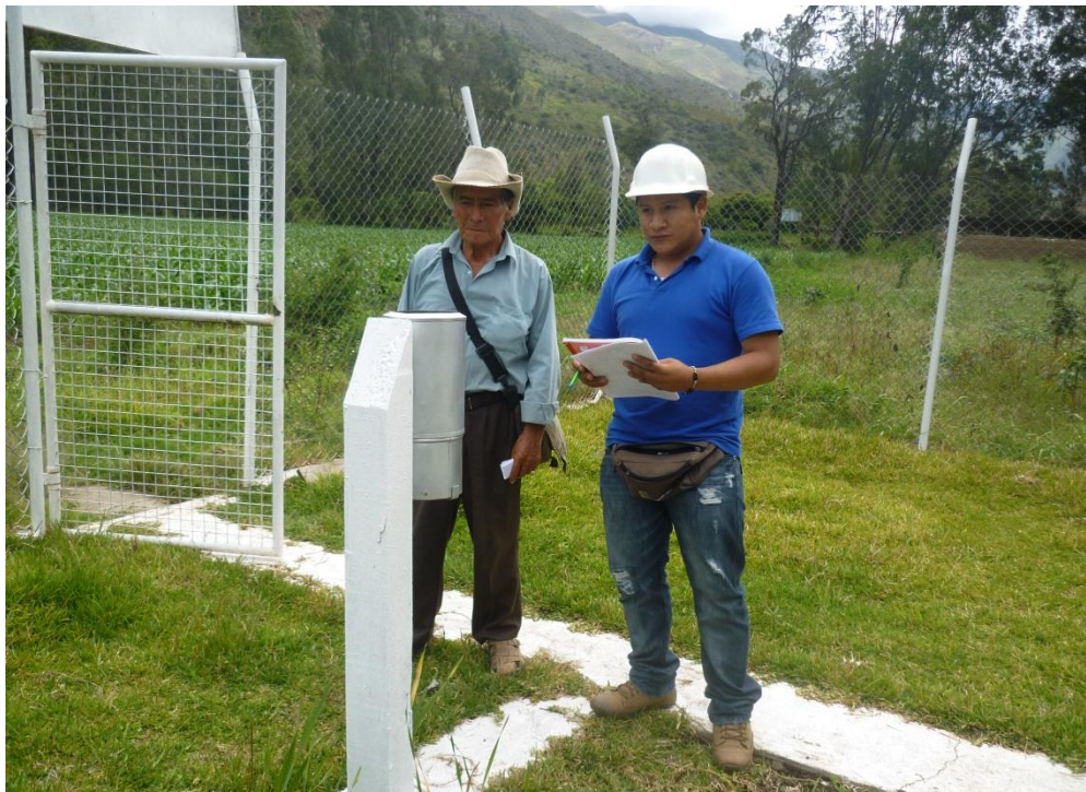
Fotografía N°14: Reconocimiento del pluviómetro de la estación meteorológica de Canchan.
