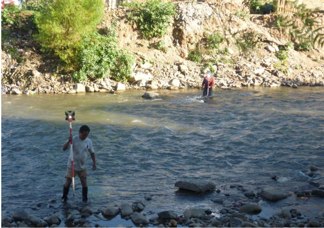
Fotografía N°42: Tesista y personal ubicando los prismas en el cauce del río.
