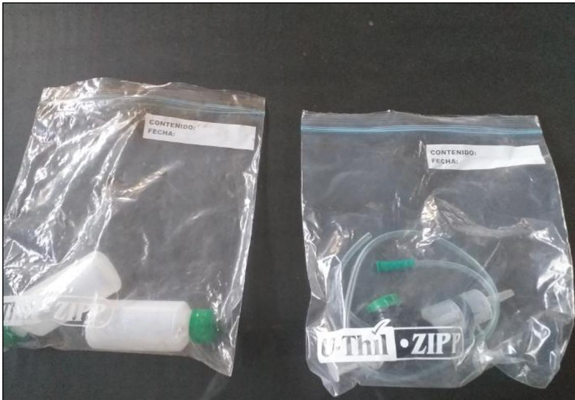
**Foto06:** Los materiales para obtención de la muestra aceite automotriz tienen que ser de primer uso.
