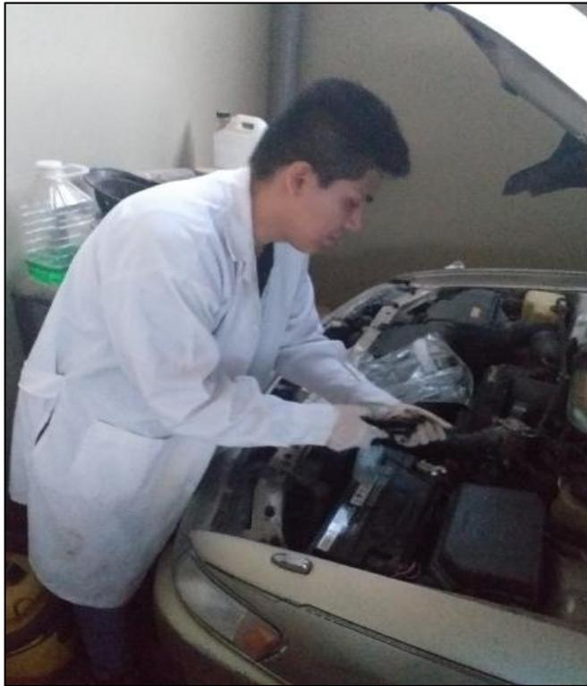
**Foto03:** Extracción de la muestra de aceite automotriz.
