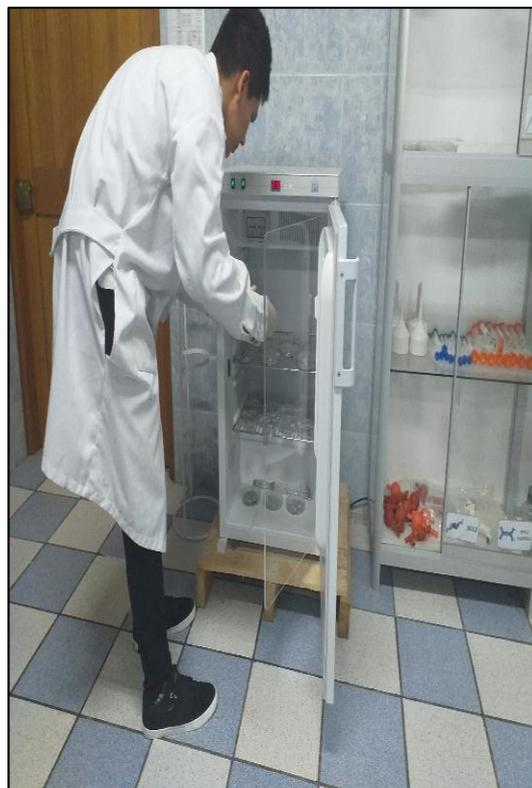
**Foto31:** Estando todo listo se colocara la incubadora con un tiempo 5 días para obtener la toxicidad que puede afectar hacia estas semillas.
