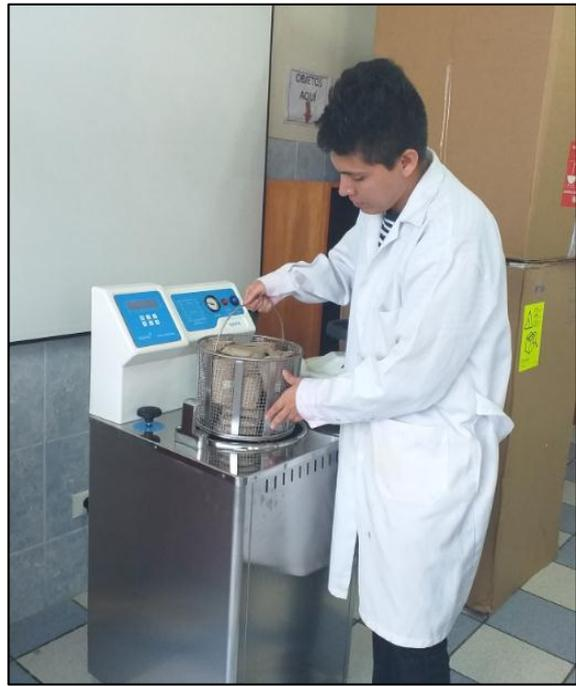
**Foto13:** Unas ves forradas se colocaran de manera cuidadosa en el balde del autoclave y luego se procedera para su esterelizacion a un tiempo de 20 min.
