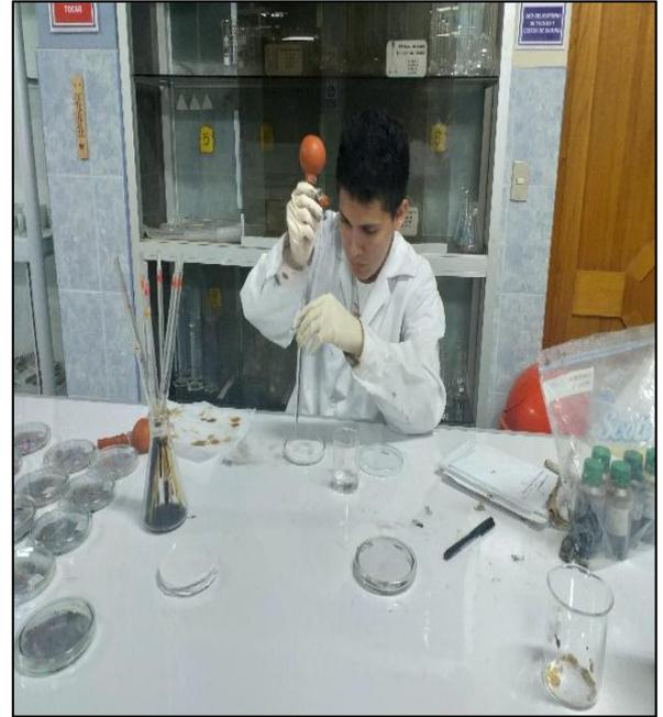
**Foto28:** Colocacion 7ml de solucion de agua destilada en cada plata petri.
