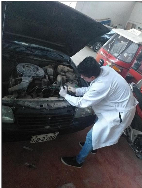
**Foto02:** Extracción de la muestra de aceite Automotriz.
