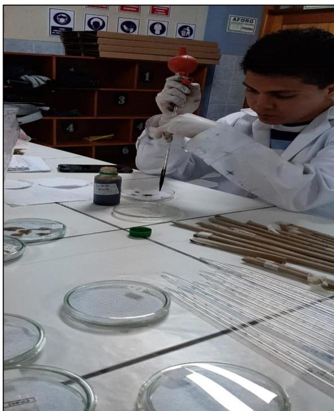
**Foto20:** Colocacion de aceite automotriz hacia placas con sus debidas concentraciones.
