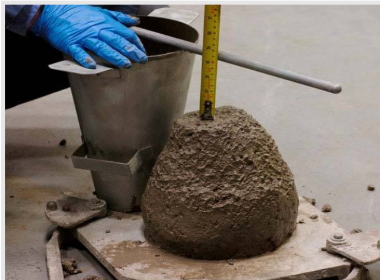
Imagen 2. Prueba de Slump del concreto
