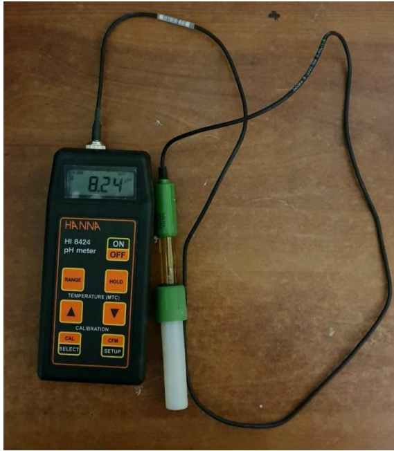
Phmetro HANNA HI 8424, usado para medir las muestras de saliva durante la investigación.
