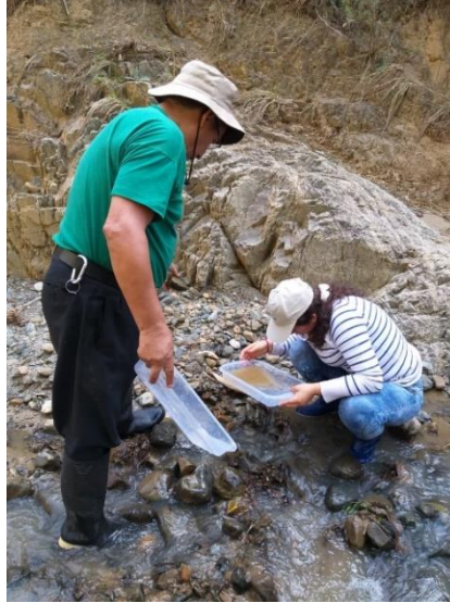
IMAGEN 04: Recojo de muestras de macroinvertebrados – Método manual
