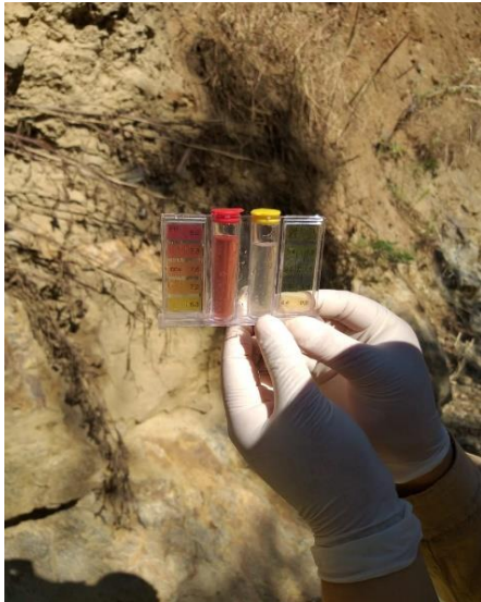
Fotografía 09. Determinación del Bromo y Cloro en el agua
