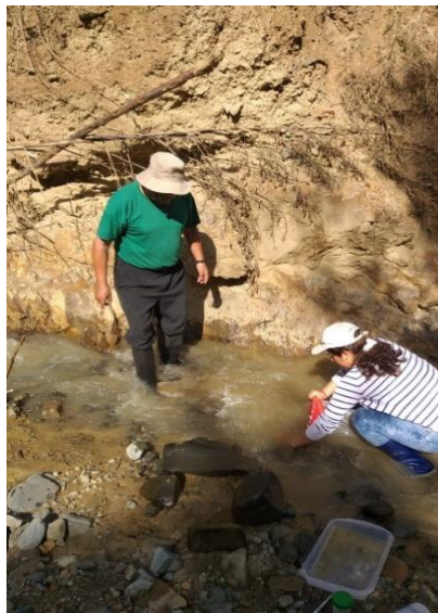
IMAGEN 03: Recojo de muestras de macroinvertebrados – Método tipo red D-net
