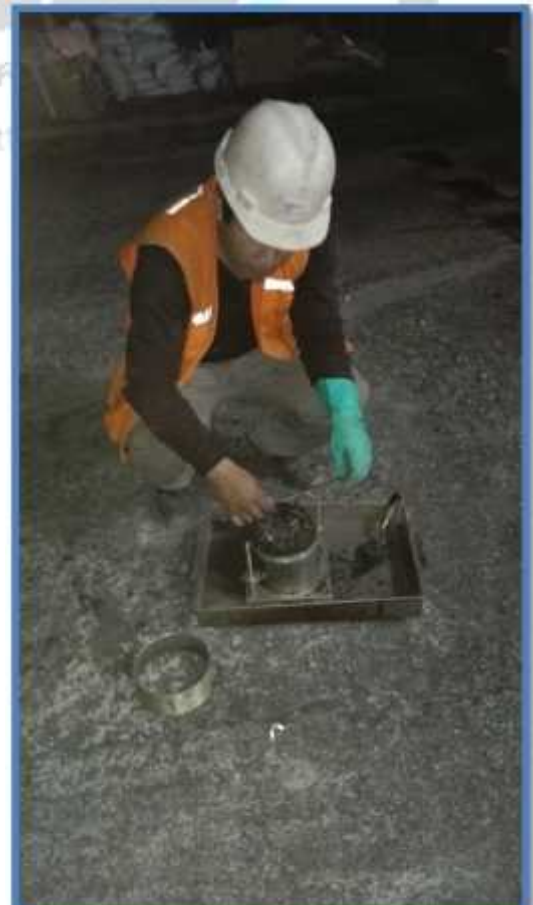
VISTA: INSERCIÓN Y CHANCADO DE MUESTRA EN EL MOLDE – 5 CAPAS DE 56 GOLPES CADA UNO, PARA EL SUCESIVO DESMOLDE Y LOS PESAJES.
