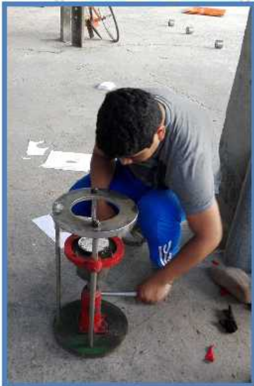
VISTA: OBTENCIÓN DE LAS BRIQUETAS LUEGO DEL CURADO PARA SER ANALIZADAS.
