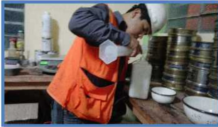
VISTA: PREPARACIÓN DEL LIQUIDO DE ENSAYO (AGUA DESTILADA Y CLORURO DE SODIO) Y HABILITACIÓN DEL TUBO IRRIGADOR.
