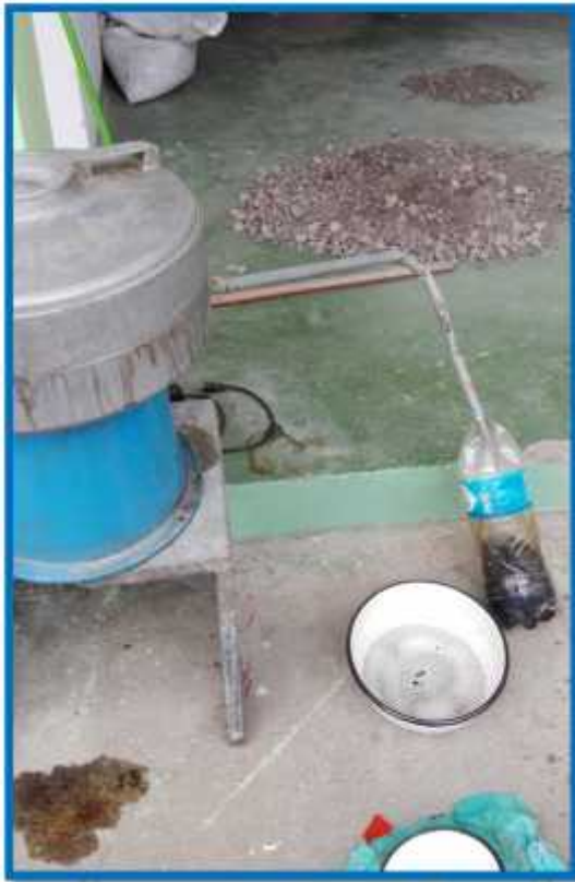
VISTA: LAVADO ASFALTICO Y OBTENCIÓN DE LA MUESTRA DESPUÉS DE LAVADO.
