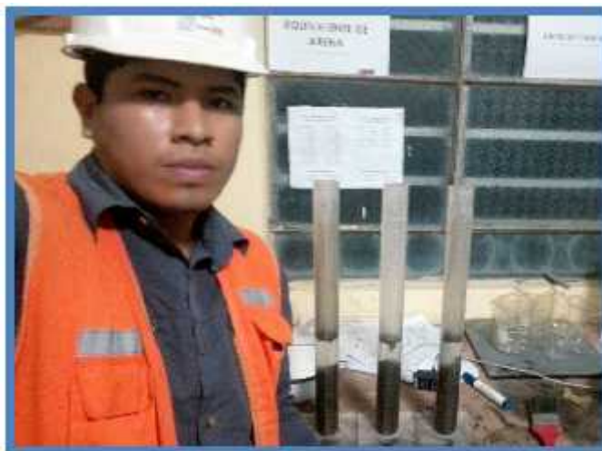
VISTA: INSERCIÓN DEL MATERIAL, AGITACIÓN DE LOS TUBOS GRADUADOS Y OBTENCIÓN DE MEDIDAS PARA LOS RESPECTIVOS CÁLCULOS.
