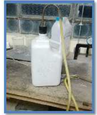
VISTA: PREPARACIÓN DEL LIQUIDO DE ENSAYO (AGUA DESTILADA Y CLORURO DE SODIO) Y HABILITACIÓN DEL TUBO IRRIGADOR.
