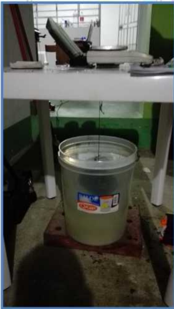
VISTA: PESAJE SUMERGIDO EN EL AGUA Y PESAJE SUMERGIDO SUPERFICIALMENTE SECA.
