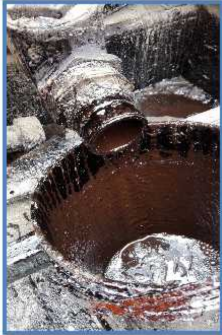
VISTA: PESAJE DE ALAMBIQUE Y INSERCIÓN DE LA EMULSIÓN PARA EL ENSAYO.
