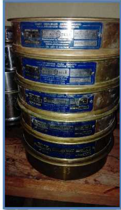
VISTA: INSERCIÓN Y TAMIZADO DE LA MUESTRA HASTA LA MALLA N° 4.
