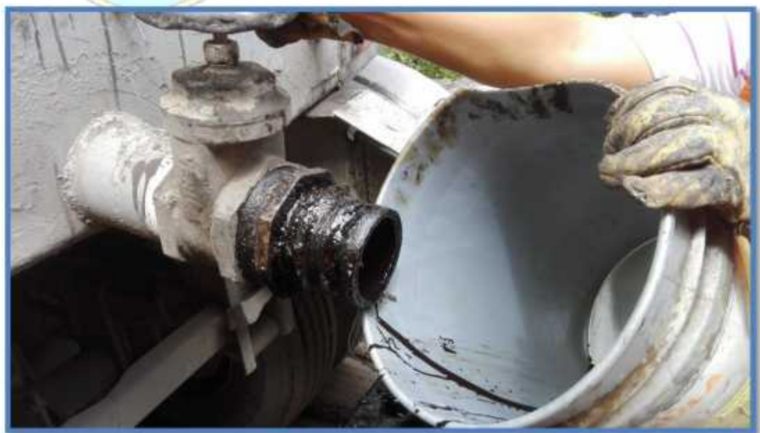
VISTA: TOMA DE MUESTRA DE EMULSIÓN ASFÁLTICA DE LOS TANQUES.
