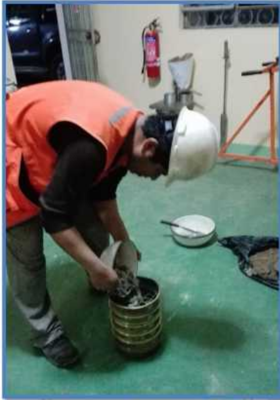
VISTA: INSERCIÓN Y TAMIZADO DE LA MUESTRA HASTA LA MALLA N° 4.
