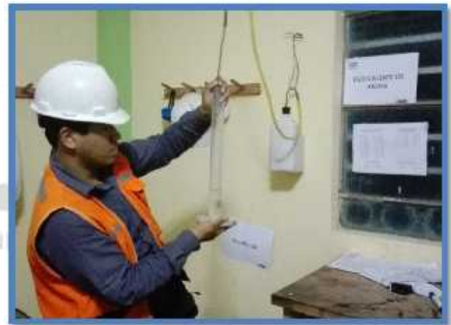
VISTA: PREPARACIÓN DEL LIQUIDO DE ENSAYO (AGUA DESTILADA Y CLORURO DE SODIO) Y HABILITACIÓN DEL TUBO IRRIGADOR.
