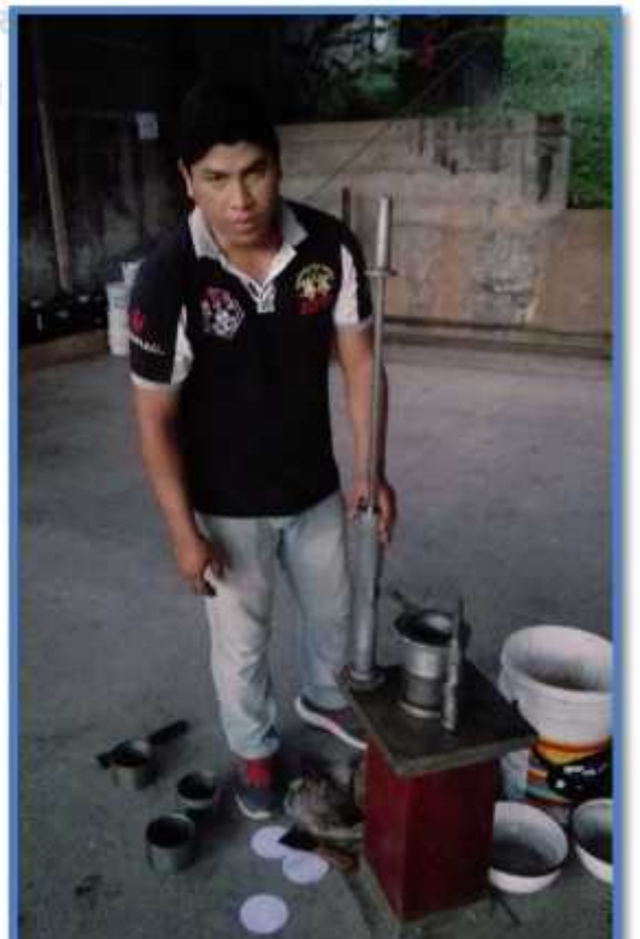
VISTA: FORMACIÓN DE MOLDES Y CHANCADO, 75 GOLPES POR CADA CARA CON EL MARTILLO MARSHALL.
