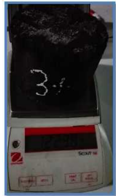
VISTA: BRIQUETAS DESPUÉS DE SER SUMERGIDAS E INICIO DE LOS PESAJES.
