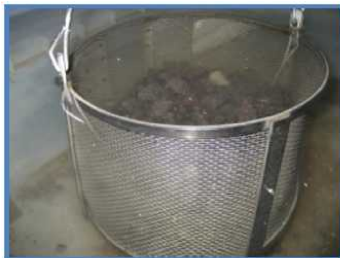
VISTA: PESADO DE LA MUESTRA SUMERGIDA EN AGUA MEDIANTE LA CANASTA.
