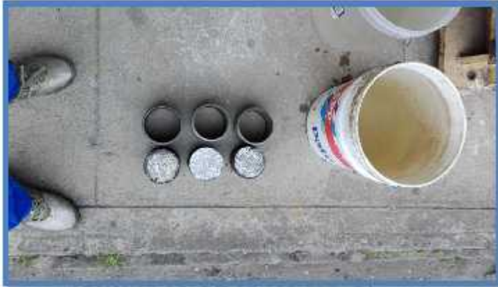
VISTA: BRIQUETAS DESPUÉS DE SER SUMERGIDAS E INICIO DE LOS PESAJES.
