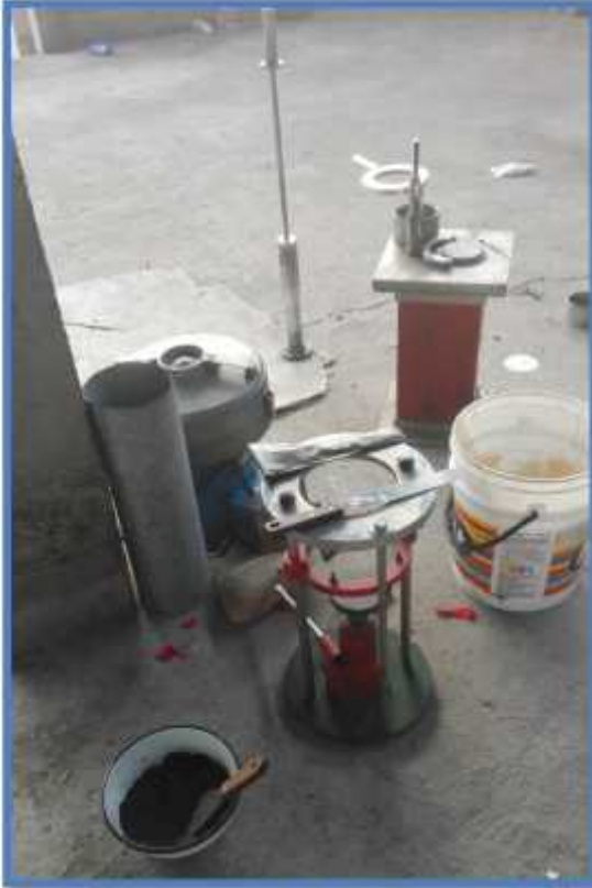
VISTA: HABILITACIÓN DE EQUIPOS DEL ENSAYO E INSERCIÓN DEL MATERIAL AL MOLDE UBICADO EN EL TABURETE SUJETADOR.
