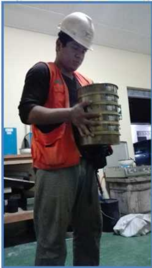
VISTA: INSERCIÓN Y TAMIZADO DE LA MALLA N° 10 A LA N° 200 PARA EL SUCESIVO PESADO.
