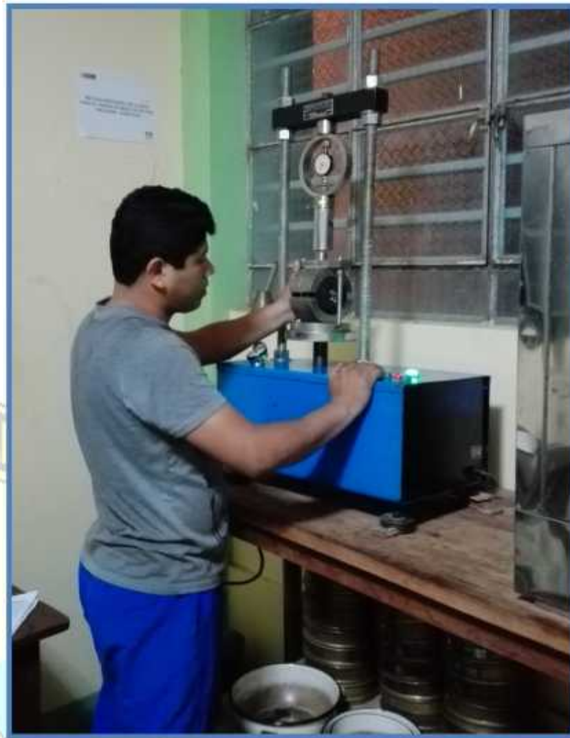
VISTA: BRIQUETAS ENSAYADAS EN LA PRENSA MARSHALL PARA LA OBTENCIÓN DE LA ESTABILIDAD Y EL FLUJO.
