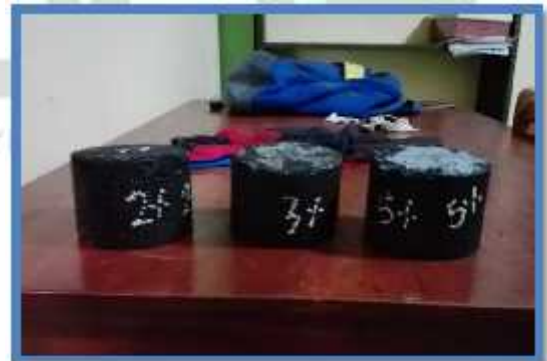
VISTA: BRIQUETAS DESPUÉS DE SER SUMERGIDAS E INICIO DE LOS PESAJES.
