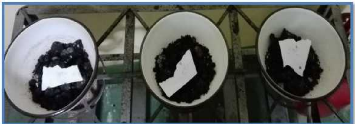
VISTA: HABILITACIÓN DE PARTES DE LAS BRIQUETAS ENSAYADAS PARA INSERTAR AL HORNO Y SECUENCIALMENTE LOS CÁLCULOS RESPECTIVOS.
