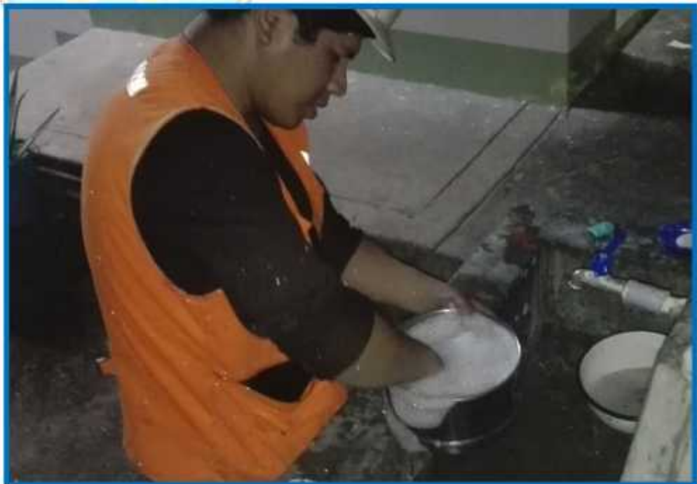
VISTA: LAVADO DE MUESTRA EN EL TAMIZ N° 200 PARA SECARLO EN EL HORNO Y PROSEGUIR CON LOS CÁLCULOS.
