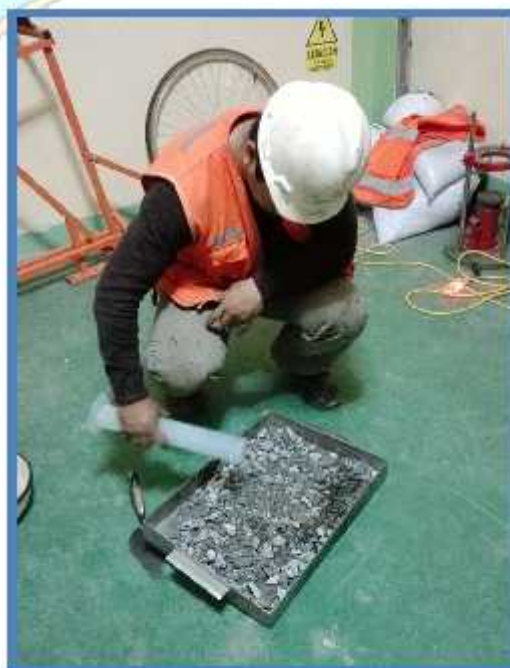
VISTA: INSERCIÓN DEL PORCENTAJE DE AGUA PARA LA MEZCLA Y EL ANÁLISIS.
