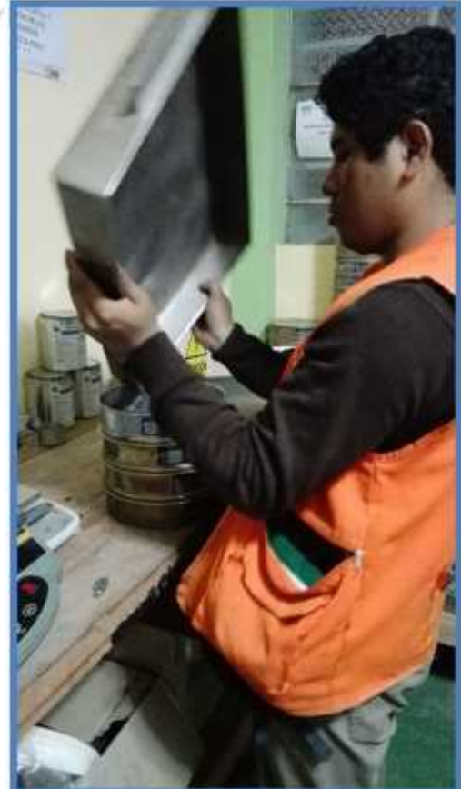
VISTA: INSERCIÓN Y TAMIZADO DE LA MALLA N° 10 A LA N° 200 PARA EL SUCESIVO PESADO.
