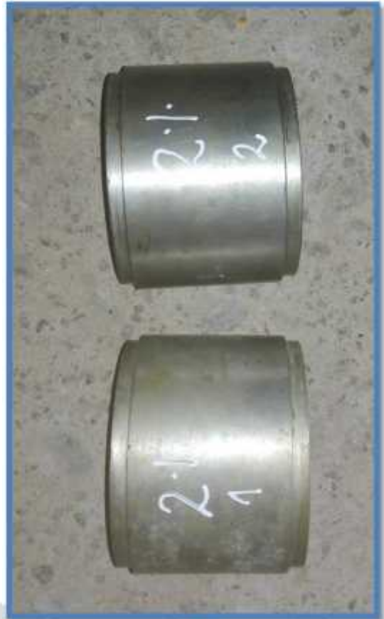
VISTA: BRIQUETAS EN PROCESO DE CURADO PARA DETERMINACIÓN DE LA DENSIDAD BULK Y ESTABILIDAD.
