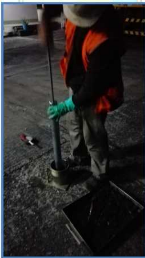
VISTA: INSERCIÓN Y CHANCADO DE MUESTRA EN EL MOLDE – 5 CAPAS DE 56 GOLPES CADA UNO, PARA EL SUCESIVO DESMOLDE Y LOS PESAJES.
