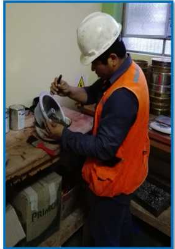
VISTA: LAVADO ASFALTICO Y OBTENCIÓN DE LA MUESTRA DESPUÉS DE LAVADO.
