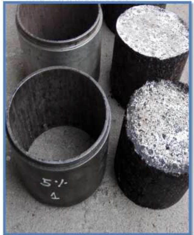
VISTA: OBTENCIÓN DE LAS BRIQUETAS LUEGO DEL CURADO PARA SER ANALIZADAS.
