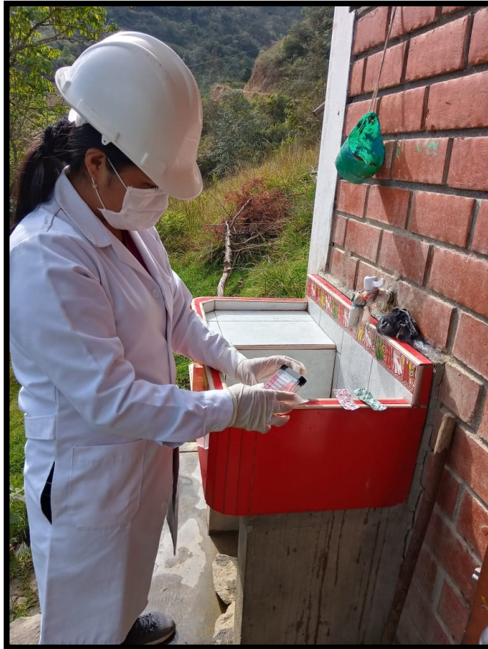
Fotografía 12: Vista fotográfica del monitoreo de parámetros físico – químico y bacteriológico del sistema de abastecimiento de agua, vivienda intermedia.
