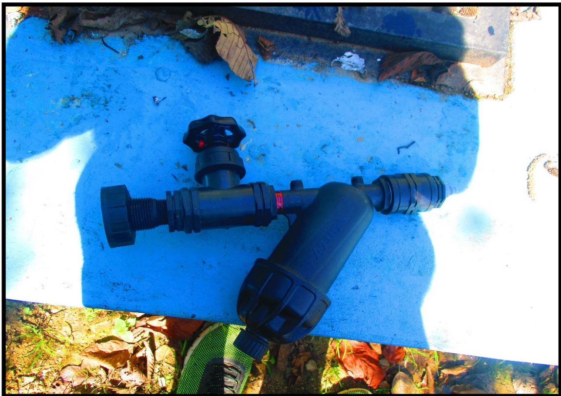
Fotografía 03: Vista fotográfica del kit del sistema de cloración autocompensante para el sistema de abastecimiento de agua.
