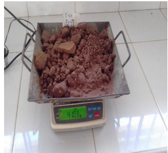
Fotografía 47,48: PESO DE LAS MUESTRAS ANTES DE SER LAVADAS.
