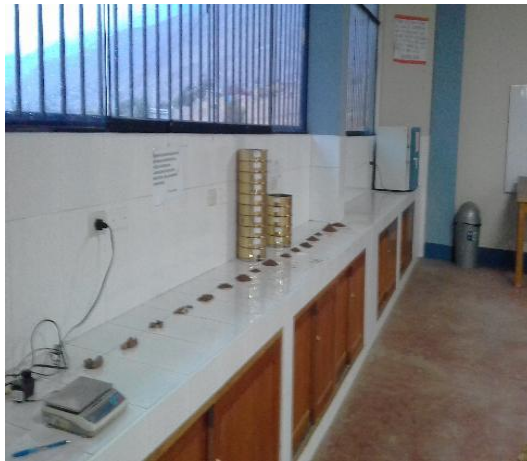
Fotografía 67,68: PESADO DEL PORCENTAJE RETENIDO EN CADA TAMIZ.
