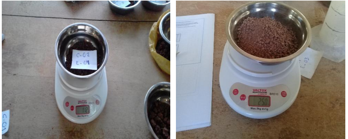
PESO ESPECIFICO DE LOS SUELOS Fotografía 09,10: SELECCIÓN DE MUESTRA QUE PASA EL TAMIZ N°4 Y PESADO UN APROX. 250 gr.
