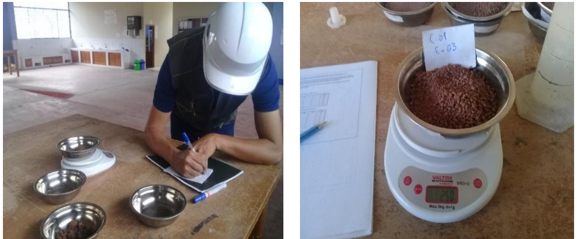
Fotografía 11,12: PESO DE LA FIOLA + EL AGUA POTABLE DESTILADA, PESO DE MUESTRA SECA.
