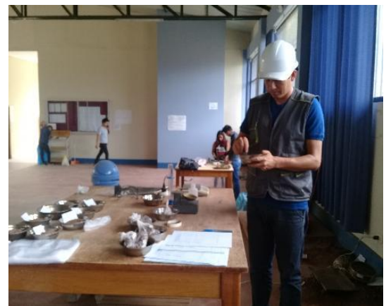
Fotografía 35,36: DEJAR REPOSAR EN BOLSAS O TAPER DURANTE UN PERIODO PARA HOMOGENIZAR LA HUMEDAD OPTIMA.
