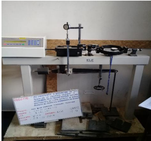
Fotografía 77,78: CARGADO DE LA MUESTRA, CON PESOS DE 2,4,8, Kg, EN EL EQUIPO.
