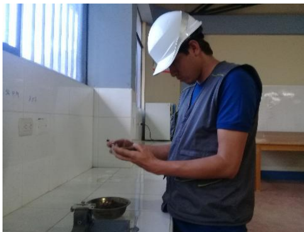
Fotografía 41,42: SE COMBINA CON AGUA POTABLE HASTA OBTENER UNA PASTA ESPESA SUAVE Y SE LLENA LA CUCHARA DE BRONCE.
