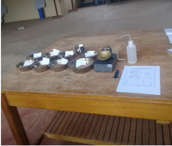
Fotografía 33,34: AÑADIR AGUA POTABLE A CADA ESTRATO HASTA LOGRAR UN CONSISTENCIA TRABAJABLE, LUEGO DEJAR REPOSAR UNAS 8 horas PARA SEGUIR CON EL ENSAYO.
