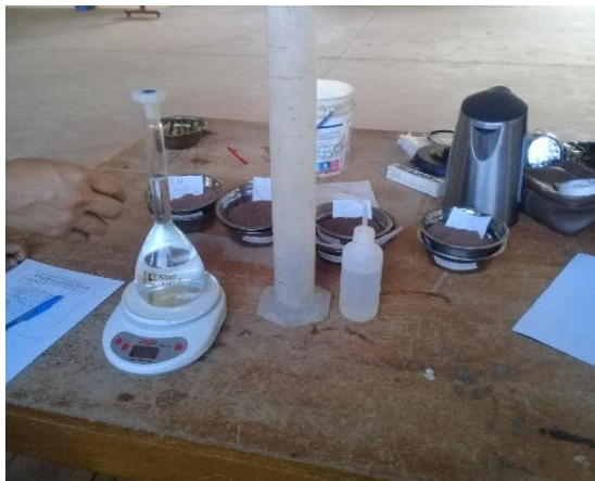
Fotografía 17,18: PESO DE LA FIOLA CON EL AGUA POTABLE DESTILADA, PESO DE LA FIOLA + LA MUESTRA.
