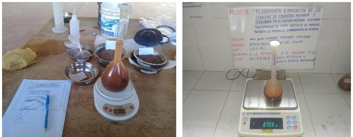
Fotografía 11,12: PESO DE LA FIOLA + EL AGUA POTABLE DESTILADA, PESO DE MUESTRA SECA.
