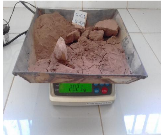
Fotografía 53,54: PESADO DE LAS MUESTRAS SECAS DE CADA ESTRATO.
