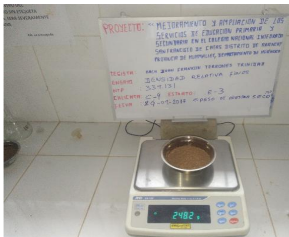
Fotografía 29,30: PESO DEL ESTRATO SECO + PESO FIOLA + ESTRATO EN CONJUNTO.
