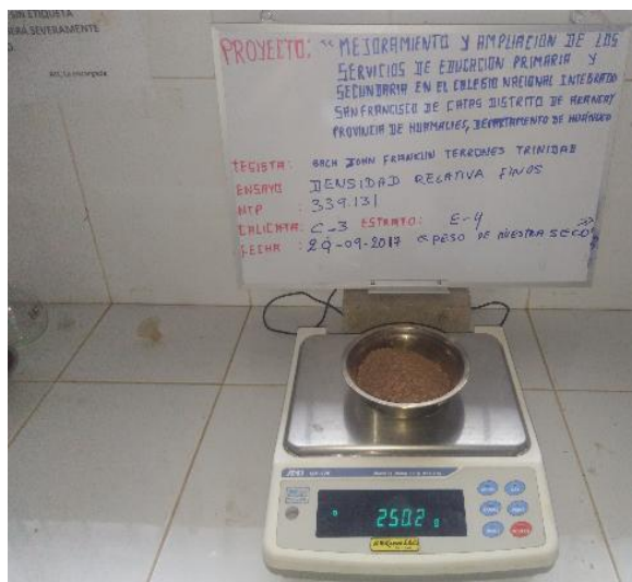
Fotografía 23,24: PESO DEL ESTRATO SECO + PESO FIOLA + ESTRATO EN CONJUNTO.
