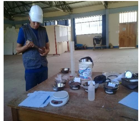
Fotografía 27,28: PESO DEL ESTRATO SECO + PESO FIOLA + ESTRATO EN CONJUNTO.
