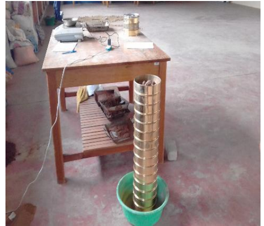
Fotografía 65,66: TAMIZADO DE LA MUESTRAS SECAS Y PESADO DE CADA TAMIZ, EL RETENIDO.
