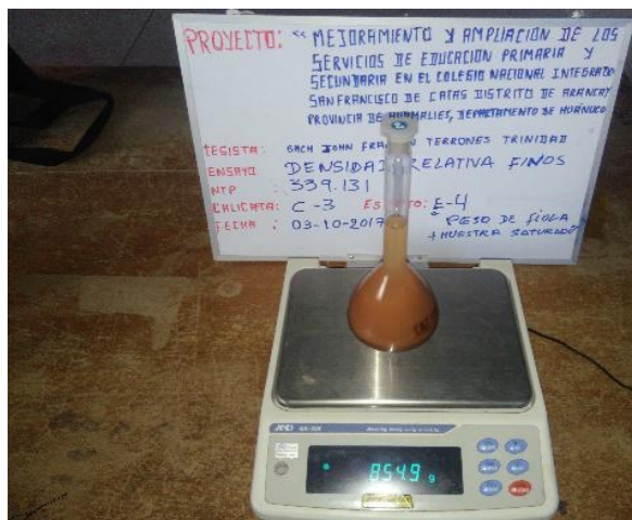
Fotografía 29,30: PESO DEL ESTRATO SECO + PESO FIOLA + ESTRATO EN CONJUNTO.
