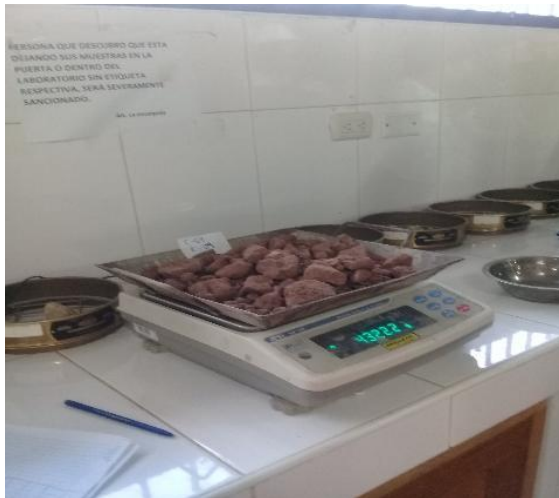
Fotografía 47,48: PESO DE LAS MUESTRAS ANTES DE SER LAVADAS.
