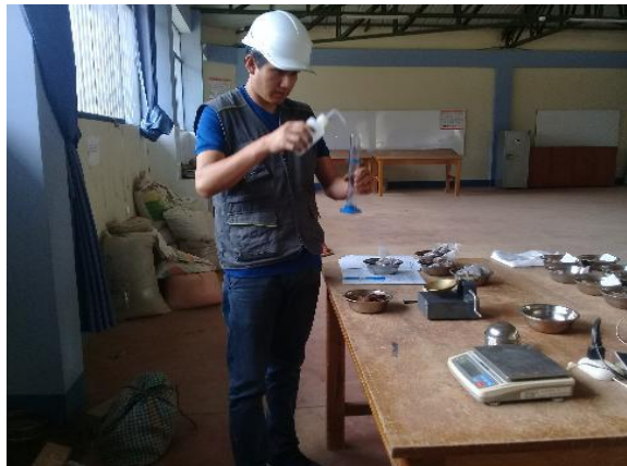
Fotografía 35,36: DEJAR REPOSAR EN BOLSAS O TAPER DURANTE UN PERIODO PARA HOMOGENIZAR LA HUMEDAD OPTIMA.
