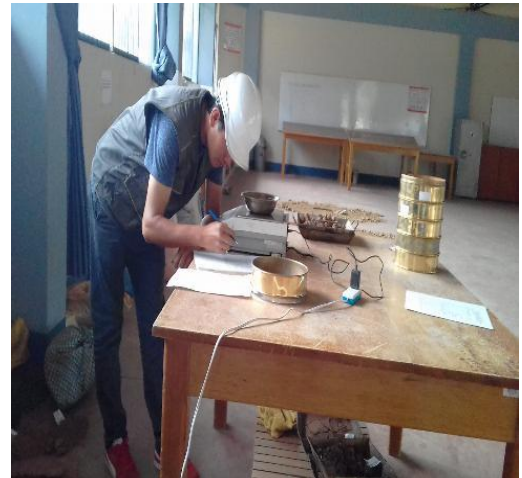
Fotografía 53,54: PESADO DE LAS MUESTRAS SECAS DE CADA ESTRATO.
