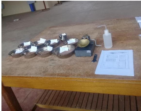
Fotografía 39,40: SE PESAN LOS SUELO HÚMEDOS, Y SE LLEVA AL HORNO Y SE VUELVEN A PESAR PARA CALCULAR EL CONTENIDO DE HUMEDAD EN EL LIMITE PLÁSTICO.
