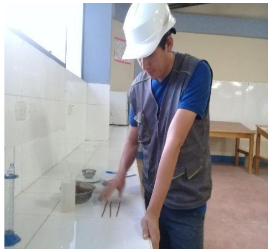
Fotografía 35,36: DEJAR REPOSAR EN BOLSAS O TAPER DURANTE UN PERIODO PARA HOMOGENIZAR LA HUMEDAD OPTIMA.
