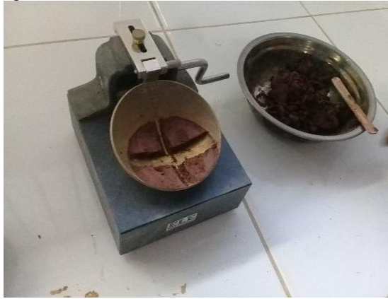
Fotografía 43,44: NUMERO DE GOLPES VARIADOS HASTA CERRAR LA ACANALADURA.
