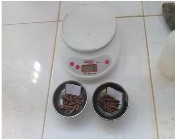
Fotografía 39,40: SE PESAN LOS SUELO HÚMEDOS, Y SE LLEVA AL HORNO Y SE VUELVEN A PESAR PARA CALCULAR EL CONTENIDO DE HUMEDAD EN EL LIMITE PLÁSTICO.
