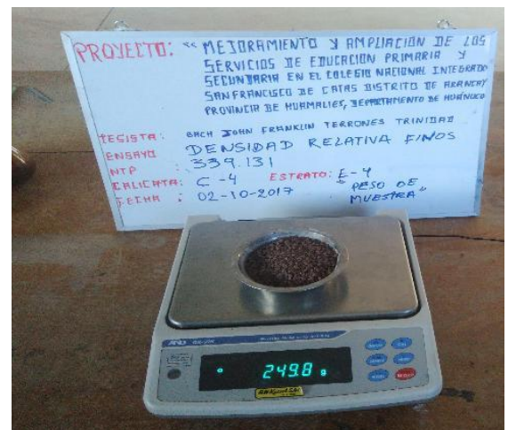
Fotografía 21,22: PESO DEL ESTRATO SECO + PESO FIOLA + ESTRATO EN CONJUNTO.
