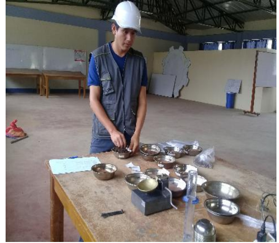
Fotografía 33,34: AÑADIR AGUA POTABLE A CADA ESTRATO HASTA LOGRAR UN CONSISTENCIA TRABAJABLE, LUEGO DEJAR REPOSAR UNAS 8 horas PARA SEGUIR CON EL ENSAYO.
