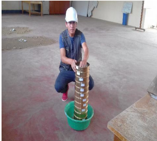
Fotografía 65,66: TAMIZADO DE LA MUESTRAS SECAS Y PESADO DE CADA TAMIZ, EL RETENIDO.
