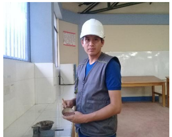
Fotografía 41,42: SE COMBINA CON AGUA POTABLE HASTA OBTENER UNA PASTA ESPESA SUAVE Y SE LLENA LA CUCHARA DE BRONCE.
