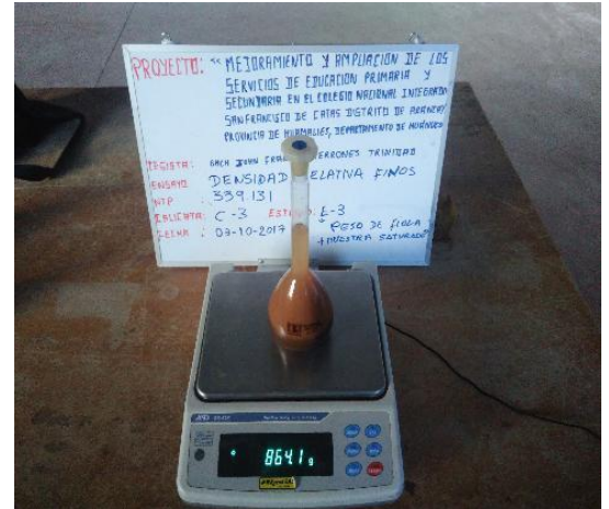
Fotografía 29,30: PESO DEL ESTRATO SECO + PESO FIOLA + ESTRATO EN CONJUNTO.
