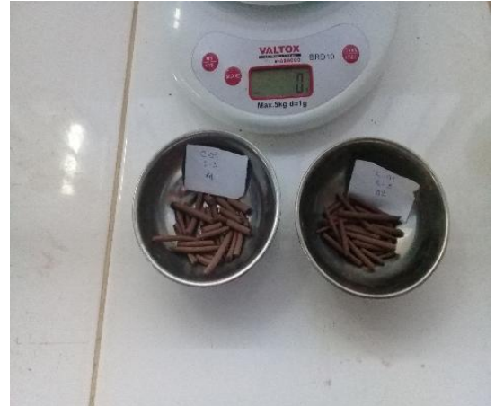
Fotografía 39,40: SE PESAN LOS SUELO HÚMEDOS, Y SE LLEVA AL HORNO Y SE VUELVEN A PESAR PARA CALCULAR EL CONTENIDO DE HUMEDAD EN EL LIMITE PLÁSTICO.
