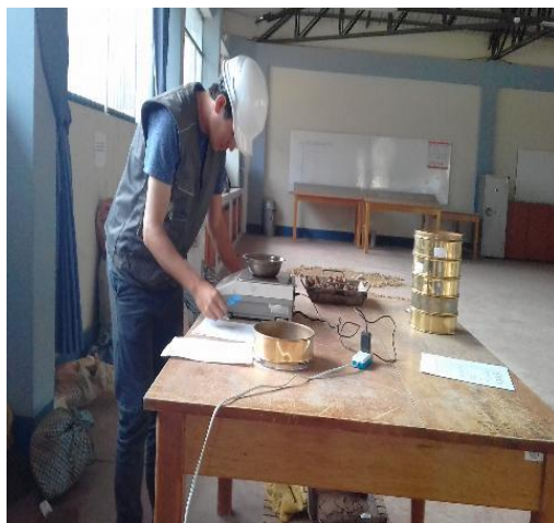
Fotografía 53,54: PESADO DE LAS MUESTRAS SECAS DE CADA ESTRATO.
