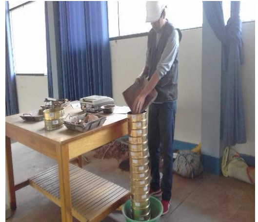
Fotografía 67,68: PESADO DEL PORCENTAJE RETENIDO EN CADA TAMIZ.
