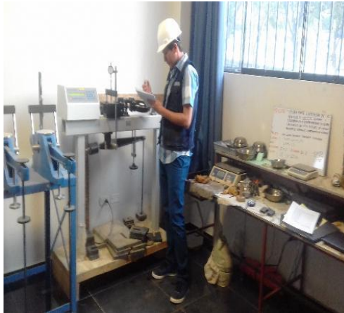
Fotografía 79,80: TOMA DE LECTURA DE CON LAS DISTINTAS CARGAS, PARA CADA MUESTRA.
