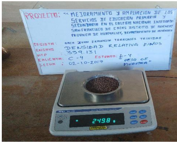
Fotografía 27,28: PESO DEL ESTRATO SECO + PESO FIOLA + ESTRATO EN CONJUNTO.
