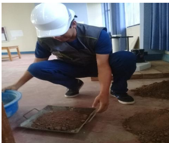
Fotografía 47,48: PESO DE LAS MUESTRAS ANTES DE SER LAVADAS.
