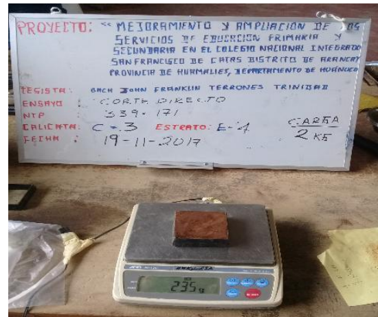
Fotografía 69,70: PREPARADO DE LA MUESTRA Y PESADO ANTES DEL ENSAYO.
