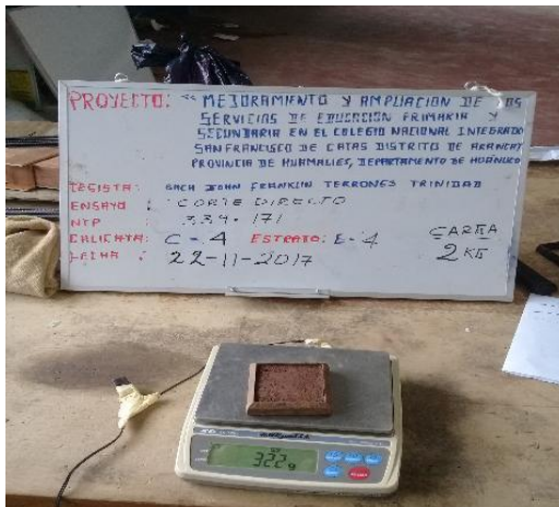
Fotografía 69,70: PREPARADO DE LA MUESTRA Y PESADO ANTES DEL ENSAYO.
