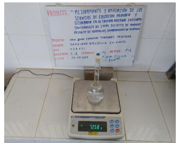
Fotografía 17,18: PESO DE LA FIOLA CON EL AGUA POTABLE DESTILADA, PESO DE LA FIOLA + LA MUESTRA.
