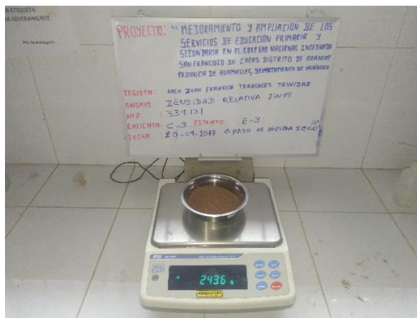
Fotografía 21,22: PESO DEL ESTRATO SECO + PESO FIOLA + ESTRATO EN CONJUNTO.
