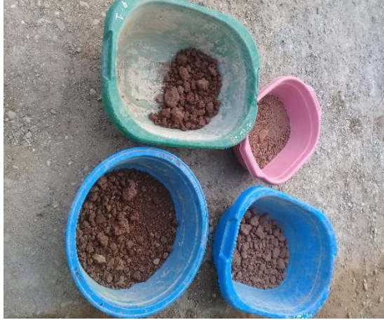
Fotografía 51,52: SECADO AL HORNO Y PESADO PARA CALCULAR EL PORCENTAJE DE DESPERDICIO
