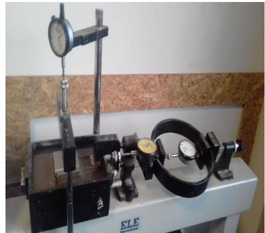
Fotografía 79,80: TOMA DE LECTURA DE CON LAS DISTINTAS CARGAS, PARA CADA MUESTRA.
