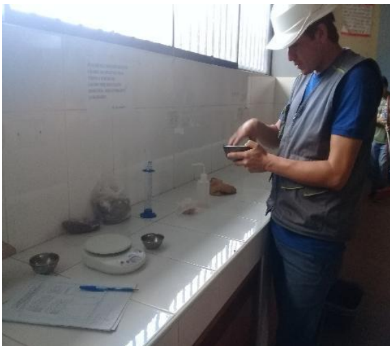
Fotografía 35,36: DEJAR REPOSAR EN BOLSAS O TAPER DURANTE UN PERIODO PARA HOMOGENIZAR LA HUMEDAD OPTIMA.
