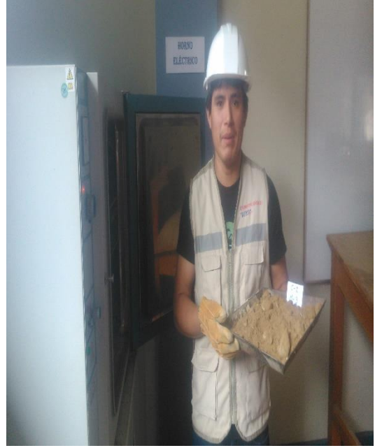
Fotografía 11,12: PESADO Y SU POSTERIOR COLOCACION EN EL HORNO PARA CALCULAR EL CONTENIDO DE HUMEDAD DE LA MUESTRA.
