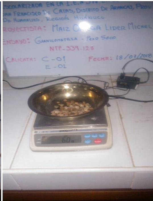
Fotografía 19,20: PESADO DE LA MUESTRA LAVADA Y TAMIZADA.
