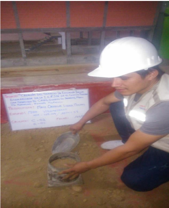
Fotografía 25,26: TOMA DE MUESTRA NATURAL Y PESADO PARA EL CALCULO DEL PESO VOLUMETRICO.
