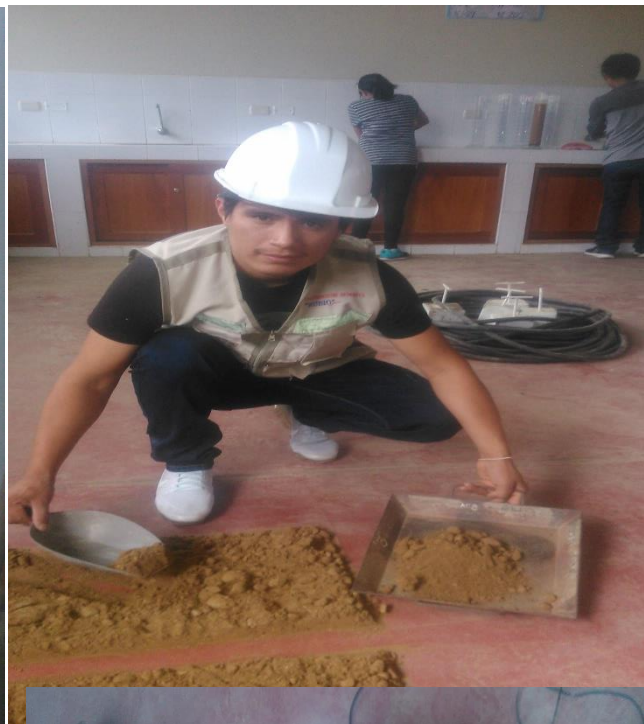
Fotografía 01,02: APRECIAMOS EL CUARTEO DE MUESTRAS DE LAS CALICATAS.
