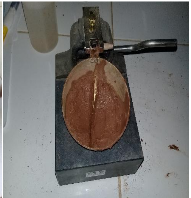
Fotografía 35, 36: SE MEZCLA CON AGUA HASTA OBTENER UNA PASTA ESPESA SUAVE Y SE LLENA LA CUCHARA DE BRONCE.
