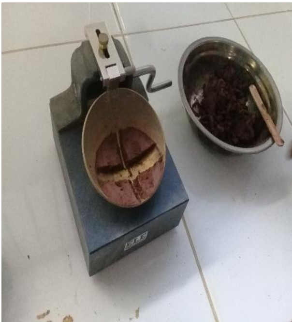
Fotografía 35, 36: SE MEZCLA CON AGUA HASTA OBTENER UNA PASTA ESPESA SUAVE Y SE LLENA LA CUCHARA DE BRONCE.
