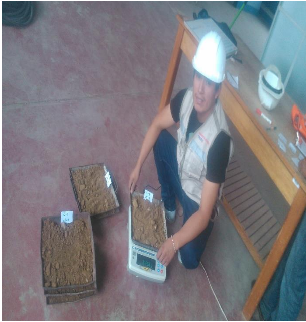
Fotografía 11,12: PESADO Y SU POSTERIOR COLOCACION EN EL HORNO PARA CALCULAR EL CONTENIDO DE HUMEDAD DE LA MUESTRA.
