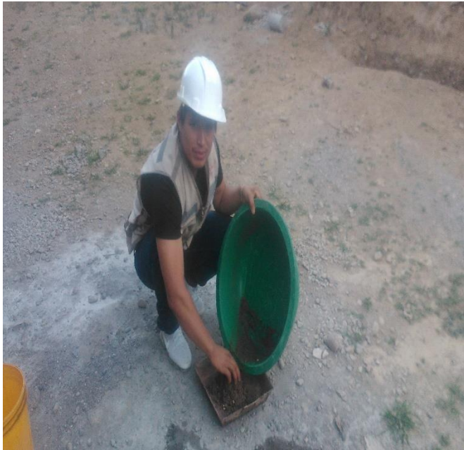
Fotografía 15,16: TERMINANDO DE LAVAR LA MUESTRA REPRESENTATIVA PARA EL ENSAYO DE GRANULOMETRIA.
