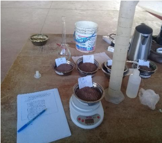
Fotografía 29,30: COMBINACIÓN DE AGUA DESTILADA + MUESTRA DE SUELO EN COJUNTO CON LA FIOLA.
