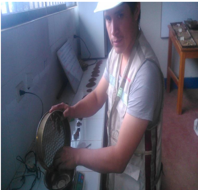
Fotografía 21,22: PESADO DE LA MUESTRA LAVADA Y TAMIZADA.
