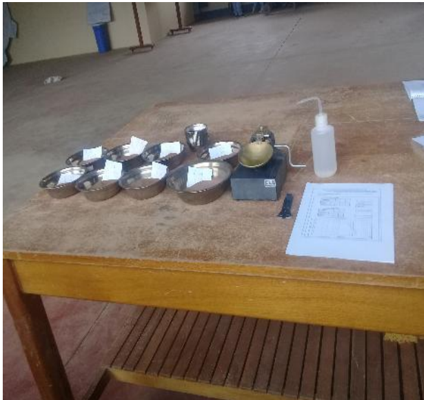
Fotografía 31,32: PESO DE LAS MUESTRAS QUE PASAN EL TAMIZ N°40 PARA EL ENSAYO.
