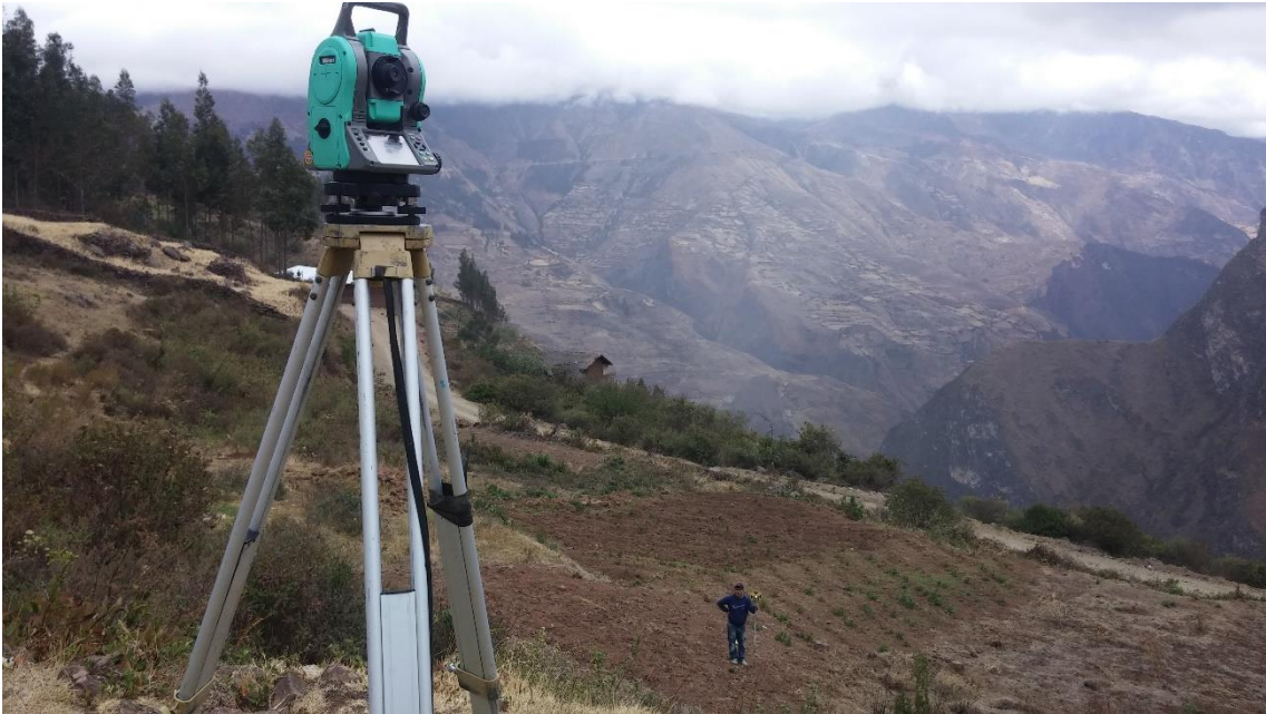
Fotografía 1. Vista panorámica del área donde se realizara el proyecto y el correcto estacionamiento del equipo topográfico (Estación Total).
