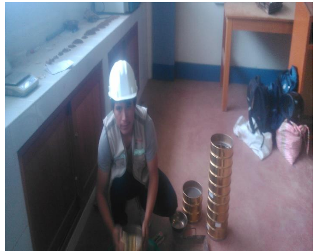
Fotografía 19,20: PESADO DE LA MUESTRA LAVADA Y TAMIZADA.
