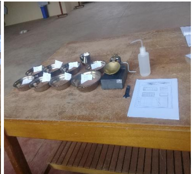
Fotografía 31,32: PESO DE LAS MUESTRAS QUE PASAN EL TAMIZ N°40 PARA EL ENSAYO.
