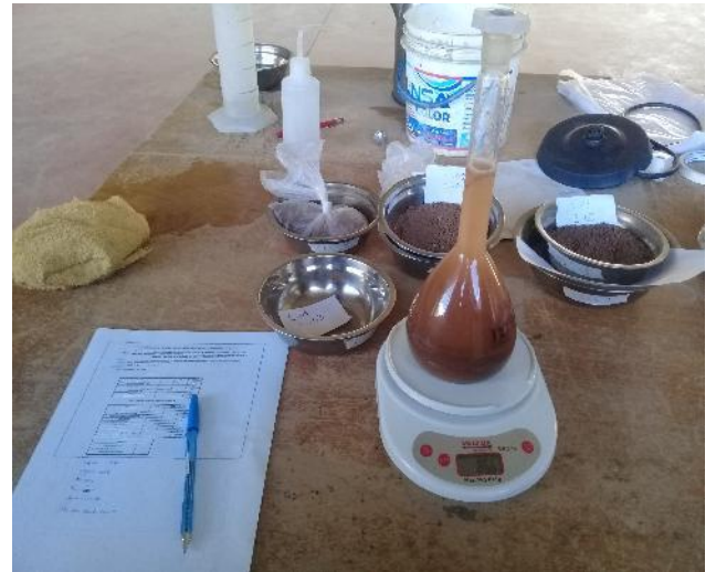
Fotografía 29,30: COMBINACIÓN DE AGUA DESTILADA + MUESTRA DE SUELO EN COJUNTO CON LA FIOLA.
