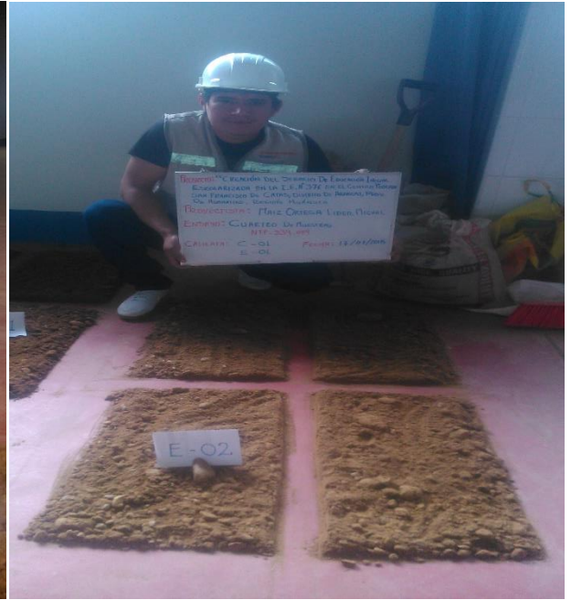
Fotografía 01,02: APRECIAMOS EL CUARTEO DE MUESTRAS DE LAS CALICATAS.
