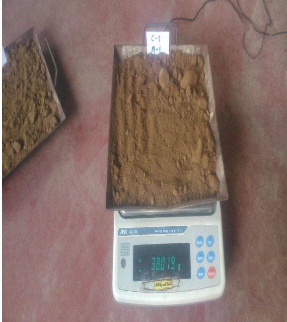
Fotografía 07,08: PESADO DE CADA MUESTRA REPRESENTATIVA PARA CALCULAR EL CONTENIDO DE HUMEDAD DE CADA ESTRATO.
