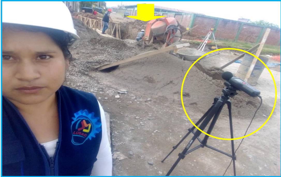
Fotografía 13: Medición de ruido en el punto de monitoreo 05 en la Av. Independencia
