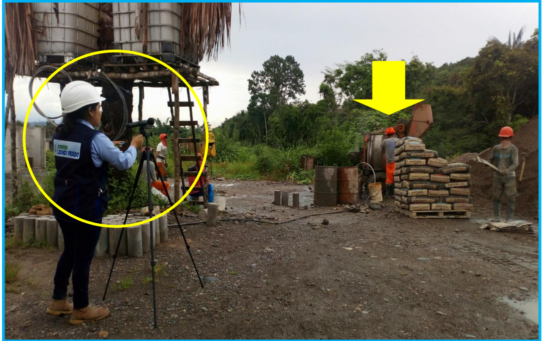
Fotografía 09: Monitoreo de ruido generado en obra empleando el sonómetro en el punto 03
