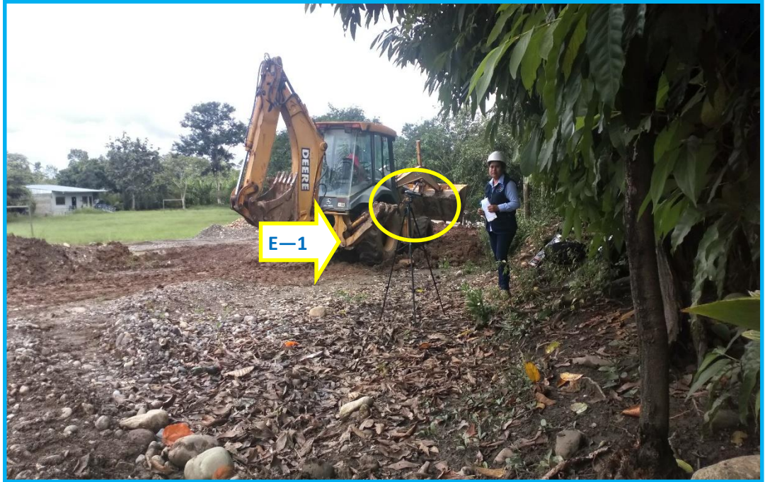
Fotografía 05: Bachiller realizando el monitoreo de ruido empleando el sonómetro en el punto 01 ubicado en la Av. San Martín.
