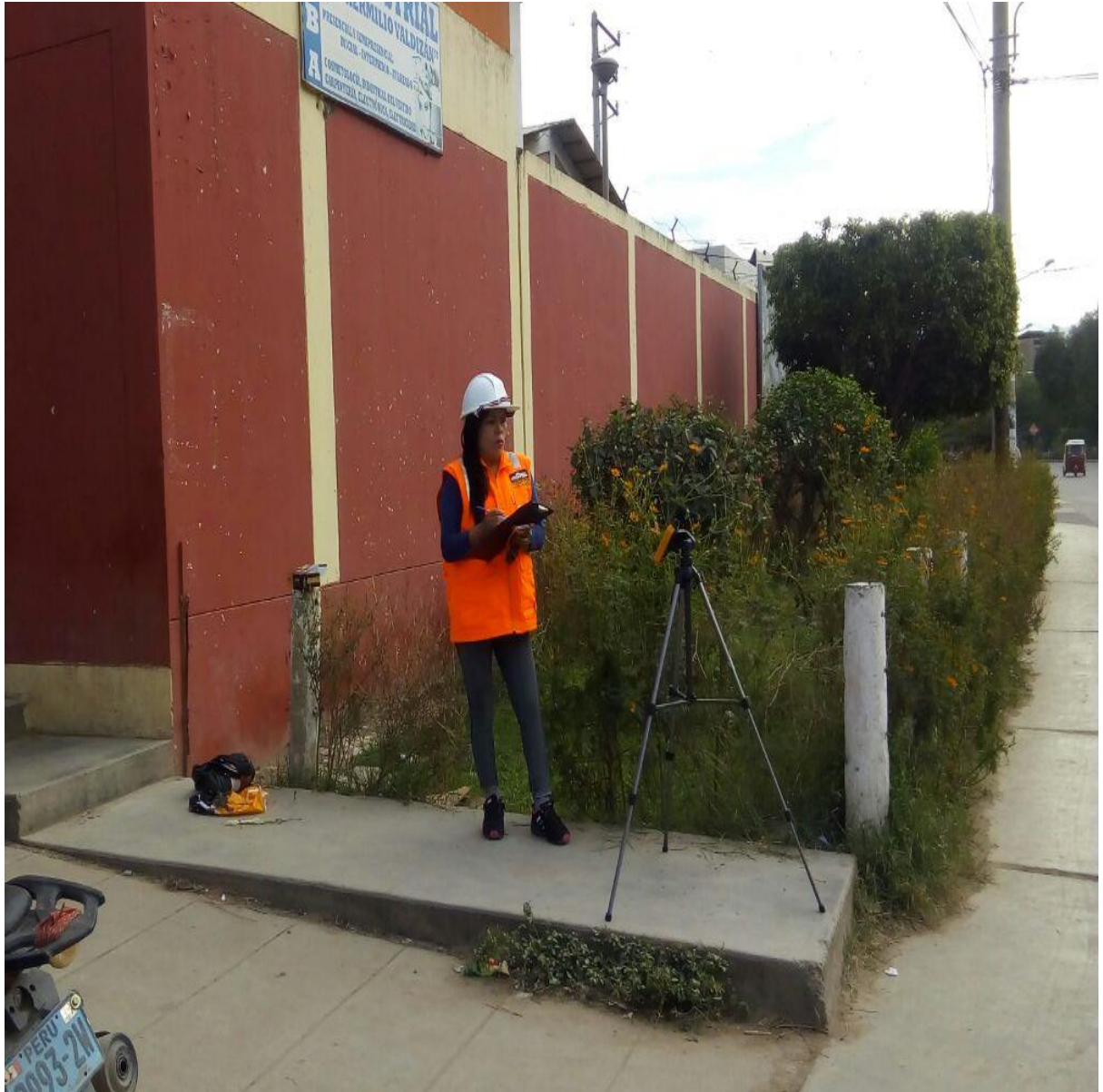
Figura 30: Monitoreo de la contaminación acústica en la estación 01.
