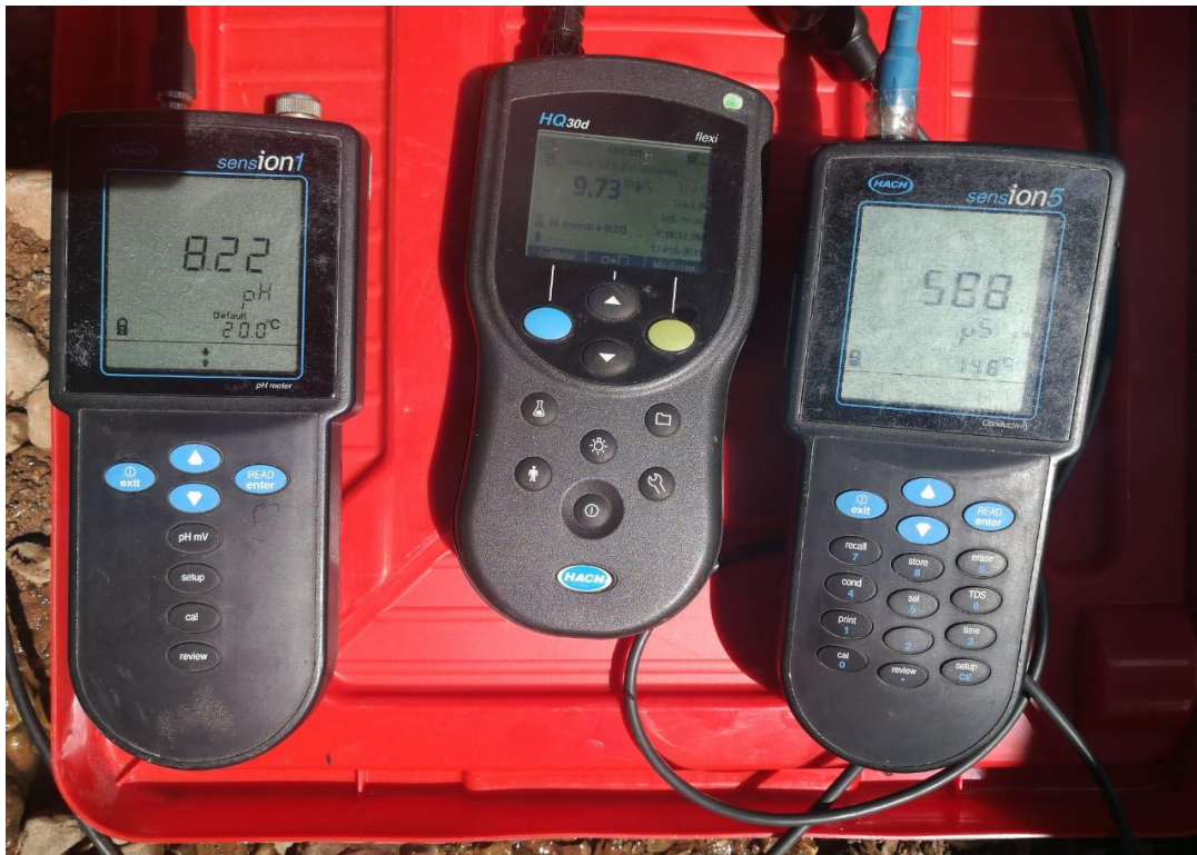
Figura 8: Equipos (potenciómetro, oxímetro, conductímetro) empleados en el muestro in situ del agua del río Niño.
