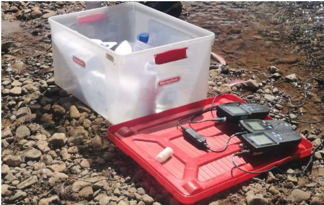
Figura 9: Equipos empleados en el muestro in situ del agua del río Niño.
